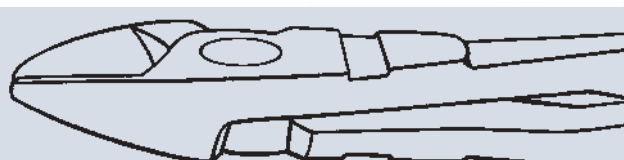
Verbindung der Zangenteile durch ein aufgelegtes Gelenk
