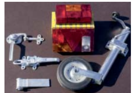
Wenn überhaupt, müssen Teile wie Klappenhaken und Spannverschluss, Klappenscharnier, Rückleuchten und Bugrad ersetzt werden.
