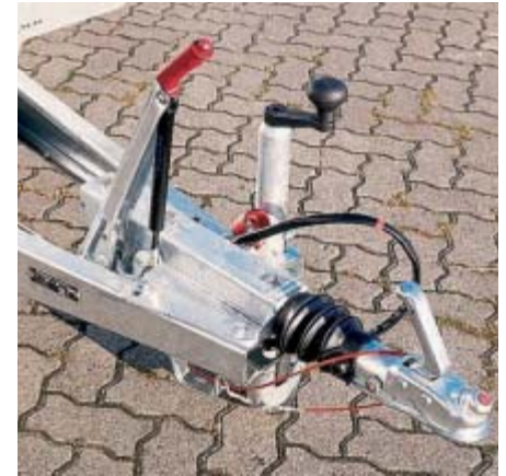
Deichseln für gebremste Hänger erkennt man am Handbremshebel und am Faltenbalg, der das Gleitstück der Auflaufbremse schützt. Links eine Einrohrdeichsel mit gelöster Handbremse, rechts eine V-Deichsel mit angezogener Handbremse: Der Faltenbalg ist deutlich sichtbar gestaucht.
