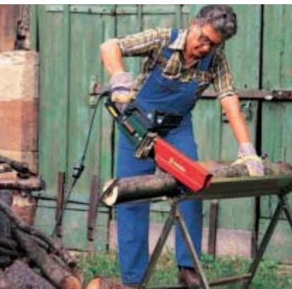
Mit einer Sägewippe und Ketten-schutz lässt sich Brennholz mit der Elektro-Kettensäge leichter und vor allem sicherer sägen.
