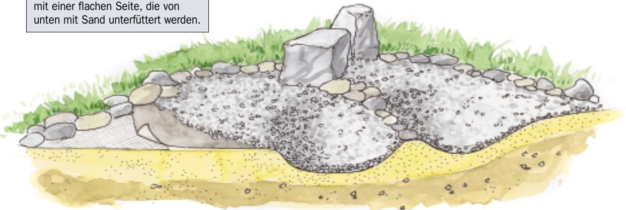
Die Teichfolie liegt auch dort, wo es normalerweise trocken ist. Praktisch ist es, unter der gesamten Kiesfläche Geovlies zu verlegen und im nassen Bereich Folie aufzulegen. Wird die wiederum mit Vlies abgedeckt, schont das die Folie und gibt den Steinen besseren Halt.
