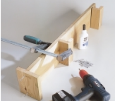
Als erstes werden Mittelwand und Böden miteinander verbunden. – wo man nicht schrauben kann, mit wasserfestem Leim.
