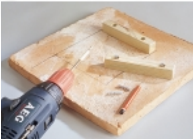
Das Terracottadach wird mit kleinen Leistenabschnitten aufgesetzt. Zum Verschrauben Dübel in die Platte einsetzen.
