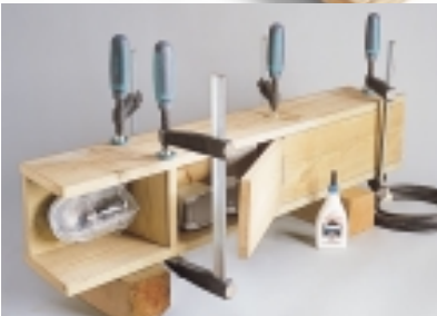
Zum Verleimen muss wasserfester Leim verwendet werden. Auf Höhe der Böden Zwingen ansetzen.
