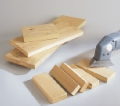
Alle Brettabschnitte schneiden Sie am besten auf einer Kreissäge zu. Anschließend die Kanten leicht abrunden.
