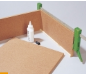
2 Erst Seiten und Rückwand mit Hilfe einer Momentzwinde verleimen. Dann den Boden mit etwas Leim einlegen und die Front fixieren.
