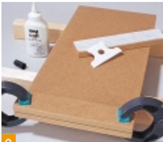
3 Die fertig geschliffenen und gefasteten Streifen auf die Seitenteile leimen. Ein Zahnpachtel hilft beim Verteilen des Leims.
