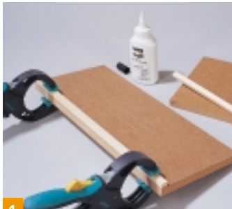
1 Die schmalen Holzleisten werden auf die beiden Seitenteile geleimt. Sie werden später dem Boden Halt geben.
