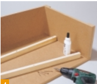
4 Unterzüge aus astfreiem Holz sorgen für ausreichende Stabilität. Sie sollten die Dimension 3,5 x 2 cm nicht unterschreiten.
