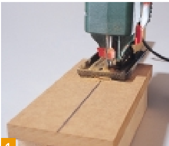
1 Die 10,5 cm breiten MDF-Streifen mit der Stichsäge auftrennen. Tipp: Mit einem Seitenanschlag wird der Schnitt gerader.
