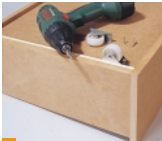
3 Die vier Bockrollen lassen sich ohne vorzubohren mit jeweils zwei Spax-Schrauben an der Schubladenunterseite befestigen.
