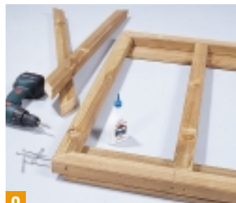
8 Der Führerstand besteht aus zwei Rahmen. Beide werden über Eck auf Gehrung geschnitten und mit Leim und Schrauben verbunden.
