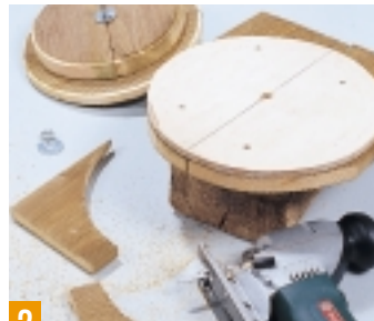
2 Zwei Sperrholzschaablonen brauchen Sie, um die Räder kreisrund auszuschneiden. Letztere verleimen Sie zuvor aus zwei einzelnen Brettern.
