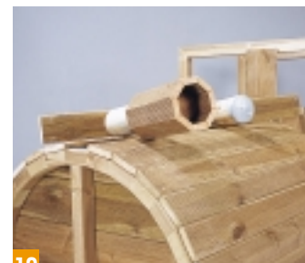
13 Zwei Rundhölzer und ein Achteck aus Leisten für Schlot und Einlauf montieren Sie von unten am obersten Brett der Kesselschalung.
