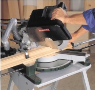
Doppelte Gehrungsschnitte sind nur möglich, wenn sich der Maschinenkopf drehen und gleichzeitig zur Seite neigen lässt.
