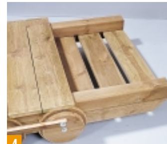
4 Der Boden besteht aus Brettern, die Sie auf den Tragelementen verschrauben. Unter dem Führerstand verschrauben Sie sie von unten.
