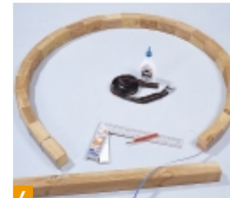
6 ... Kunststoffband , das die je 25 Segmente zusammenhält, wenn Sie sie zu einem Kreis biegen. Die längere Bodenleiste einpassen.
