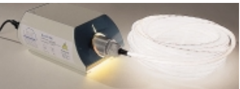
Besondere Objekte können mit Punktlichtern perfekt ins richtige Licht gesetzt werden. Dafür gibt es ummantelte Glasfaserstränge mit nur etwa 1 cm Durchmesser, die das Licht in einem 60°-Winkel abstrahlen. Dabei entsteht kaum Streulicht. Wir haben in die Fachoberseiten 10-mm-Löcher gebohrt und die Punktlichtstränge so hineingesteckt, dass sie auf der Sichtseite bündig abschließen. Sie sind kaum zu sehen, wenn das Licht aus ist.
