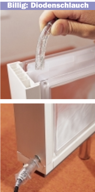
Preisgünstige Diodenschläuche (9 m etwa 27 Euro) machen die „X-Block“-Wand zur Lichtquelle. Es gibt sie in Baumärkten und Warenhäusern. Der Durchmesser sollte maximal 13 mm betragen um in die Fugen zwischen den Steinen zu passen. Der Stromanschluss erfolgt über eine Rahmenbohrung.
