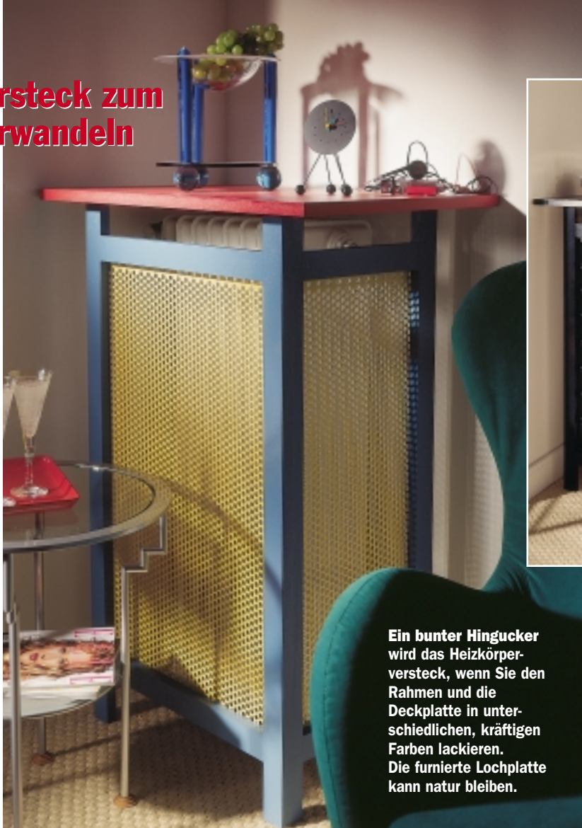
Die Konstruktion ist denkbar einfach: Ein Front- und zwei Seitenrahmen werden verleimt und von hinten eine Füllung montiert. Die Deckplatte bekommt zwei Führungsklötzchen untergeleimt, die genau in den Leistenwinkel der Verkleidung fassen.
