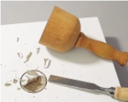
Mit einer Lochsäge ohne Zentrierbohrer schneidet man den Lochkranz aus. Dazu muss der Bohrständerfuß mit Zwingen an dem Regalboden festgesetzt werden. Man schneidet mindestens 16 mm tief und arbeitet den Bohrkern mit dem Beitel heraus.
