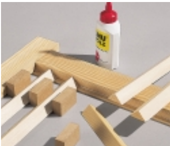
Distanzklötze von etwa 2 cm Breite, aus Restholz zugeschnitten, garantieren einen gleichmäßigen Abstand der Dreieckleisten beim Verleimen mit der Flachleiste.
