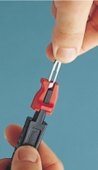
Die Klingen der meisten Messer lassen sich ohne Werkzeug leicht austauschen. In der Regel sind die Klingen so preiswert, daß sich das Nachschärfen nicht lohnt.
