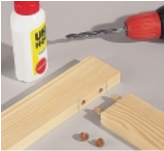
Die Rahmenverbindungen werden mit 8-mm-Holzdübeln und Leim verbunden. Zum exakten Positionieren der Dübellöcher sind „Dübelmarker“ eine ideale Hilfe.
