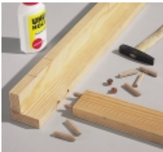
Erst die Rahmenwinkel verleimen, dann die waagerechten Leisten mit den senkrechten verdübeln (8-mm-Holzdübel) und verleimen.
