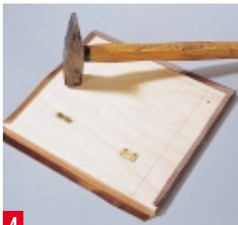
4 Das Gleiche machen Sie bei der Futterklappe. Die kleinen Messingscharniere werden auf die Unterseite genagelt.
