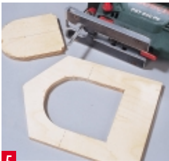
5 Die kleine Giebelwand erhält einen bogenförmigen Ausschnitt. Bohren Sie auch gleich die Löcher für den Spieß in die Seitenwände.
