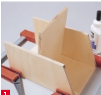
1 Rück- und Seitenwände verleimen Sie stumpf miteinander. Die spätere schräge Frontwand dient zunächst nur als Abstandhalter.
