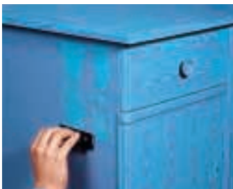
Beim Maserieren werden die Flächen mit Lack gestrichen (hier Blaugrün) und nach dem Trocknen mit einem zweiten Farbtönen überzogen. In den noch feuchten Anstrich wird mit dem Maserierkamm die Holzoptik eingearbeitet. (Werkzeug und Lack: Dulux)
