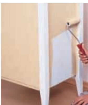
Auf glatten Flächen wie Türfronten und Seitenteilen ist die Lackierrolle das Werkzeug der Wahl: Schnell und präzise zur perfekten Oberfläche.
