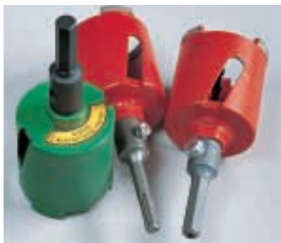
Auch wenn es die Diamantbohrkronen mit SDS-Plus Aufnahme (Mitte) für Hämmer gibt, beim Arbeiten mit den Kronen wird der Schlag immer abgeschaltet.
