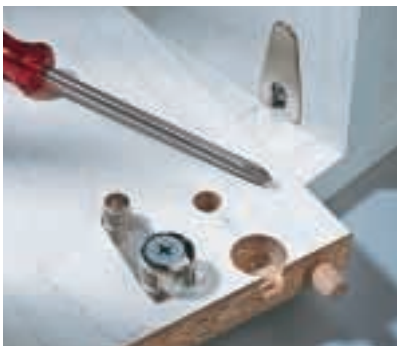
Dieser Beschlag verbindet den Vorteil ohne eine Kanten-Tiefbohrung auszukommen mit der hohen Ausrissfestigkeit eines zusätzlichen Ankerzapfens. (Hettich)
