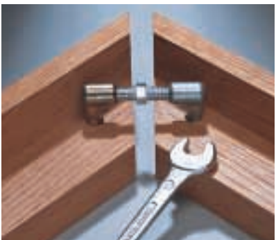
Der Verbinder spannt auf Gehrung gesägte Rahmenteile zusammen. Spannschraube und Gewindehülsen der Ankerdübel haben Rechts- und Linksgewinde. (Hettich)
