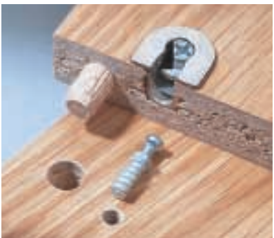
Dieser Verbindungsbeschlag wird mit einer Randbohrung von 20 mm Ø eingelassen. Gegenstück ist eine Pilzkopfschraube. Der Dübel dient als Führung. (Hettich)
