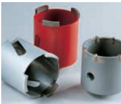
Die Hammerbohrkronen (rechts) hat aufgelötete Hartmetallmeißel. Schleifend arbeiten die aufgelöteten Diamant-segmente der Diamant-Dosensenker.
