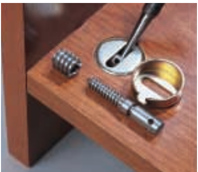
Eine Alternative zum Exzenterbeschlag ist dieser Schraubverbinder. Hier dreht eine verdeckte Spannschraube in eine „Rampa“-Muffe auf der Schrankseite. (Häfele)
