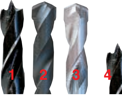
Holzbohrer (1) mit Zentrierspitze für weiche Gipswände. Der Universalbohrer (2) ist schärfer und etwas spitzer als der spezielle Steinbohrer (3). Die Spitze des Hammerbohrers (4) ähnelt zwei Meißeln.
