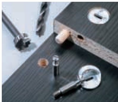
Bei Exzenterbeschlägen greift ein runder, konischer Hebel hinter den Pilzkopf der Verbindungsschraube und spannt die Verbindung, wenn man ihn dreht. (Hettich)
