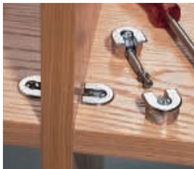
Für die Verbindung zweier Böden mit einer 20 mm dicken Mittelwand gibt es diesen Beschlag mit einer Gewindehülse und passenden Schrauben mit Pilzkopf. (Hettich)
