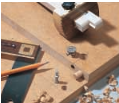
Für dünneres Plattenmaterial (Mindestdicke 15 mm) gibt es diesen Beschlag mit geringerer Einlasstiefe und einem Bohrdurchmesser von 15 mm. (Häfele)
