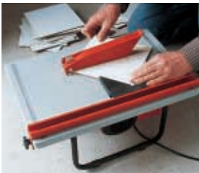
Damit gelingt auch ungeübten Selbermachern der genaue Zuschnitt von Fliesen. Die Diamantscheibe mit geschlossenem Schneidrand läuft im Wasserbad.
