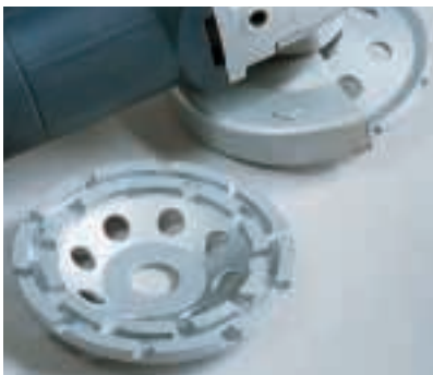
Mit dieser Scheibe werden Betonnasen entfernt und grobe Unebenheiten in Mauerwerk und Estrich beseitigt. Die Scheibe wird vollflächig aufgesetzt. (Dronco)
