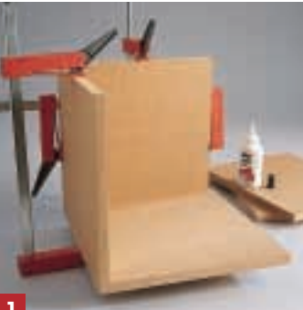
1 Der Würfel entsteht aus fünf stumpf verleimten Platten. Achten Sie bitte unbedingt darauf, dass die Flächen und Kanten bündig sind.
