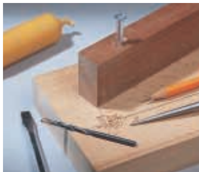
Das anzuschraubende Teil wird im vollen Schraubendurchmesser durchbohrt. Vorgebohrt wird dann mit etwa 1/3 Durchmesser bei Weichholz, etwa 2/3 (bei Hartholz).
