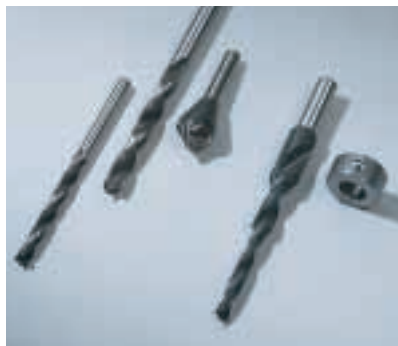
Der Stufenbohrer mit drei Stärken (rechts) ersetzt zwei Bohrer (5 und 7 mm) und den Senker. Ein Stellring (ganz rechts) auf dem Stufenbohrer dient als Tiefenstopp.
