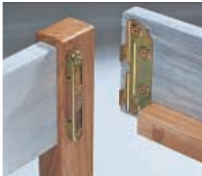
Mit dem geteilten Bettbeschlag werden die Seiten in das Kopf-/Fußteil gehängt. Für Rechts-/Linksanschlag sind die Bleche unterschiedlich gekröpft. (Hettich)
