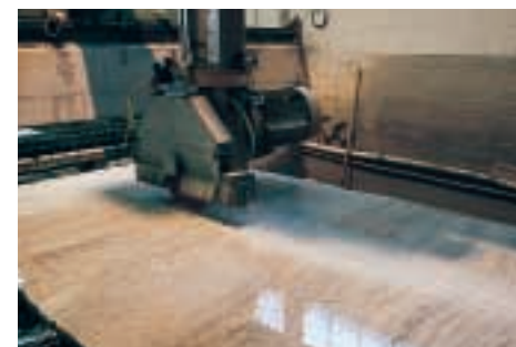
Eine tonnenschwere Marmortafel wird bereitgestellt und die gewünschte Form mittels einer Schablone angerissen. Dann sind die Maschinen dran, um einen korrekten Schnitt zu machen.
