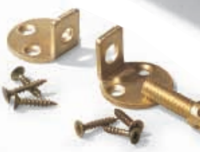
Der „Hamburger Schrankverschluss“ verbindet mit einer Spannschraube Teile, die in einer Ebene liegen. Als Führung können Rund- oder Flachdübel dienen. (Häfele)
