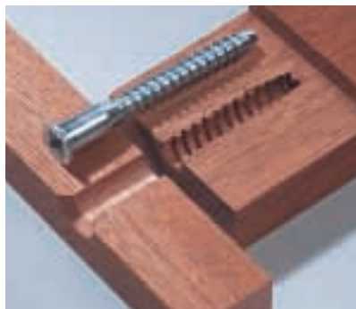
Die Stufenschraube sorgt für guten Sitz im anzuschraubendem Teil. Vorgebohrt wird mit einem Stufenbohrer: vorbohren, durchbohren, ansenken. (Häfele/Hettich)
