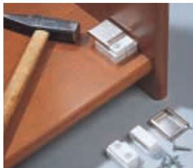
Bei diesem Korpusverbinder werden die Böcke an die Teile geschraubt. Die Böcke greifen ineinander und werden von der Spannplatte zusammengezogen. (Häfele)
