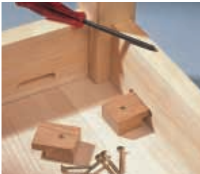
Mit Nutklötzen befestigt man massive Tischplatten verschiebbar an der Zarge. So kann das Holz arbeiten, ohne dass in den Bauteilen Spannungen auftreten.
