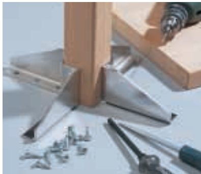
Ohne Zarge ist das Mittelbein stabil an der Tischplatte befestigt. Hier wurde der Beschlag wie im vorherigen Beispiel verwendet, jedoch ohne die Bohrungen.
