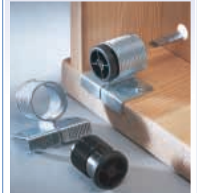
Der „Hamburger Schrankverschluss“ verbindet mit einer Spannschraube Teile, die in einer Ebene liegen. Als Führung können Rund- oder Flachdübel dienen. (Häfele)
