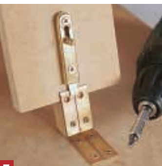
7 Der Schubriegel, an der Klappstrebe befestigt, gleitet beim Arretieren mit seiner Zunge über die spitzwinklig geschliffenen Winkelenden.
