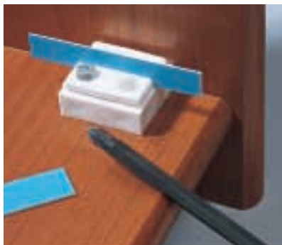
Die Bockmontage erfolgt mit 0,5 mm Abstand, damit die Spannplatte stramm anzieht. Einen entsprechenden Abstandhalter beim Montieren dazwischen halten.
