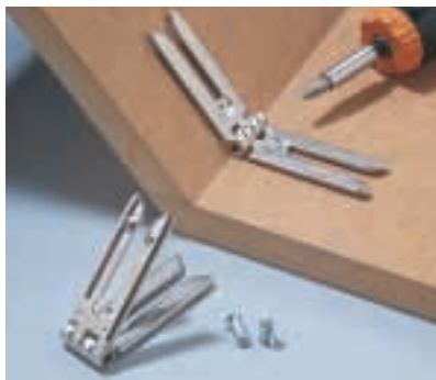
Der Gelenkverbinder ermöglicht Winkelverbindungen von 30° bis 270°. Wird es für normale Schrauben zu eng, verwendet man welche mit Sechskantkopf. (Hettich)
