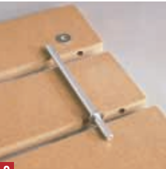
3 Als Drehachse dient ein 20 cm langer Aluminiumstab mit 10 mm Durchmesser. Die Löcher müssen deswegen 10,5 mm groß sein.
