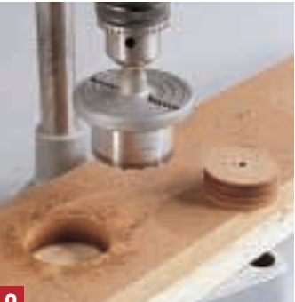
2 In die Klappstrebe wird mit einer Lochsäge eine etwa 5 cm große Öffnung zur Aufnahme von Anschlagwinkel und Stützklotz gesägt.
