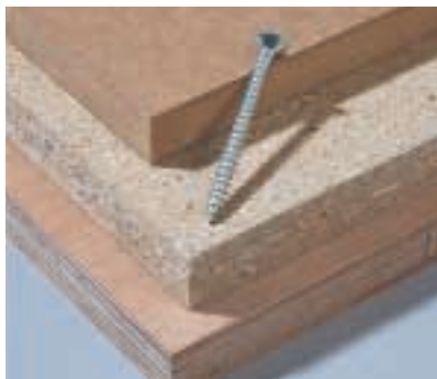
Die Mehrzweck- oder Spanplattenschraube eignet sich für alle Holzwerkstoffe. Sie hat im Vergleich zur Holzschraube einen etwa 50 Prozent höheren Ausreißwiderstand.
