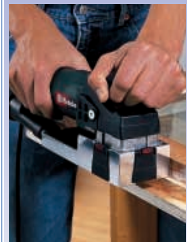
Unübertroffen ist die Lackfräse bei Renovierungs- und Sanierungsarbeiten. Die Messer sind so fein regulierbar, dass wirklich nur die Farbschichten entfernt werden. Sie können mit dem Gerät auf der Fläche links- und rechts-seitig sowie frontal arbeiten. Wenn die schwarzen Klappen weggeklappt wer-den, geben sie die Fräsmesser frei. Dann kann die Farbe auch aus einem Falz bis auf den letzten Rest sauber herausgefräst werden. (Metabo)
