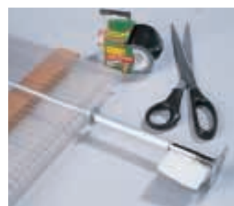
Ein Rundrohr (Ø 12 mm) führt die Achse, eine U-Scheibe bildet das Auflager. Isolierband verbindet die Fußplatte und die Achse.
