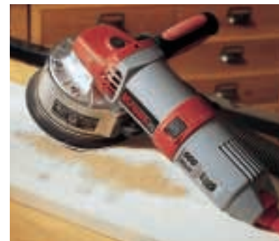
Dieser Exzenter-schleifer ist umstellbar. Zuerst wird die Farbe mit der Grobschliff-einstellung entfernt. Der Teller dreht mit, daher die große Abtragsleistung, und ...
