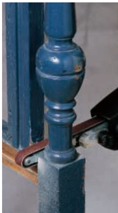
Auch dies ist ein Bandschleifer, allerdings mit sehr schmalen Bändern. Es gibt für das Gerät verschiedene Köpfe für Bänder unterschiedlicher Breite. Ganz enge Zwischenräume sind sein Einsatzgebiet. Und egal, ob für Holz oder Metall, es gibt die verschiedenen Bänder in allen gängigen Körnungen. (Black & Decker)
