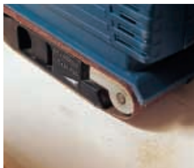
Das Schleifband des Bandschleifers wird in Richtung der Maserung geführt. Der Abtrag ist sehr groß, ebenso die Gefahr, dass man Dellen ins Holz schleift, ...
