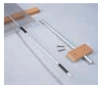
Eine Platte aus MDF führt oben (hinter der Blende) die Achse. Isolierbandstreifen gleichen die Passungen zwischen den Rohren aus.
