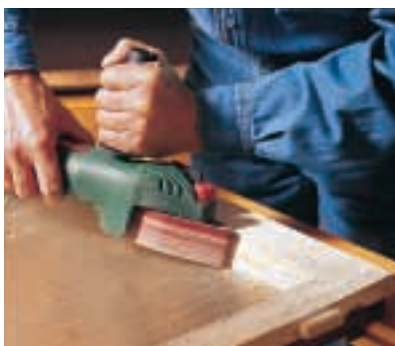
Dieser kleine Bandschleifer ist für Kanten, Ecken und enge Zwischenräume gedacht. Der Abtrag ist sehr stark, man muss sehr vorsichtig mit ihm arbeiten. (Bosch)
