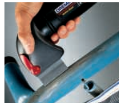
... Schleifköpfen ausgerüstet werden. Hier ist es ein Rohr, das mit einem halbrunden Kopf bearbeitet wird. Es gibt auch Köpfe für Innenecken und -rundungen. (Dremel)
