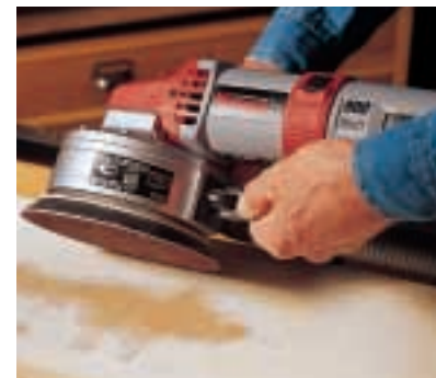
... dann wird der Hebel am Kopf um-geleitet. Das Gerät arbeitet jetzt im Fein-schliffmodus mit kleinem Schwingkreis und hoher Tourenzahl. (Kress)
