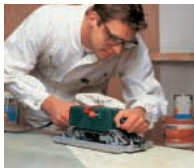
... es sei denn, man hat einen Bandschleifer mit Scheifrahmen. Der Rahmen verhindert, dass der Schleifer kippt, der Abrieb ist dadurch genau regulierbar.
