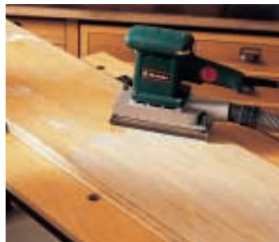
Nach wie vor ist der Schwingschleifer ein ideales Werkzeug, um große Flächen glatt zu schleifen. Die Maschine wird mit minimalem Druck über die Fläche geführt.
