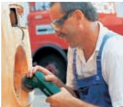
Zwei Vorteile hat der kleine Exzenter-schleifer: Mit der Scheibe kommt man in die Rundungen, der Stützteller ist weich und passt sich der Form an. (Metabo)
