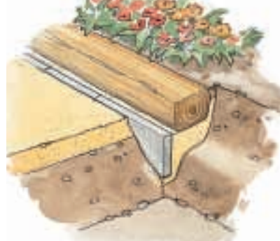
Dieser aus einem Stamm gesägte und abgeflachte Balken hält auf einer Seite die Beeterde und wird zur Wegseite von einer Kante aus Rasenbordsteinen gesichert.
