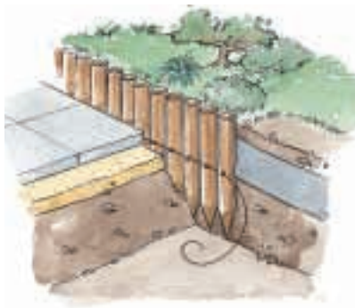
So baut man Palisaden zwischen Plattenweg und höherliegendem Beet ein. Sie werden zur Hälfte eingegraben und zur Erdseite hin mit einer Folie gesichert.
