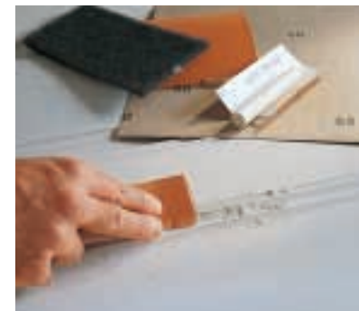
Manchmal geht es einfach schneller mit den alten Hausmitteln. Schleifpapier lässt sich in jede Form falten. Für Rundungen legt man es um ein Rundholz.
