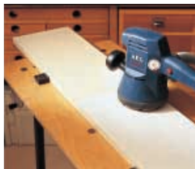
Der Exzenter-schleifer hat einen größeren Abrieb als der Schwingschleifer bei einer besseren Oberflächengüte. In Ecken muss allerdings nachgearbeitet werden.
