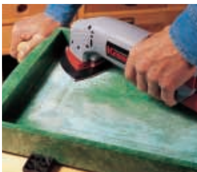
In den Ecken ist der Dreieckschleifer unschlagbar. Der Schleifteller des Geräts ist auswechselbar, so dass auch an sehr engen Stellen geschliffen werden kann.
