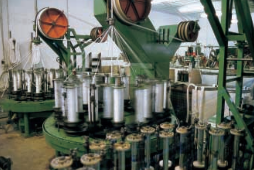
Rattern und Knattern: Hier flechten Computer die Seile aus einzelnen Garnen von der Spule an.
