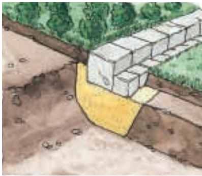
Hier sieht man, wie die Pflastersteine auf einer Sandunterlage eingebaut werden. Die kleinen Mosaiksteine dienen als Laufweg für die Räder des Rasenmähers.
