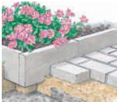
So werden halbe Gehwegplatten auf einer Unterlage aus Verlegesand eingesetzt. Im Anschluss ein Weg aus Betonpflastersteinen auf verdichtetem Sandbett verlegt.
