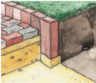
So werden Klinker oder Betonpalisaden als Weg- und Beetkante eingebaut. Die Rasenfläche liegt höher als der Weg, und die Steine dienen so auch als Mähkante.
