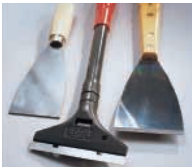
Stoßspachtel mit dickem, steifem Blatt, das meißelartig angeschliffen ist. Man stößt damit Verunreinigungen und Mörtelreste vom Estrich ab (Westermann).
