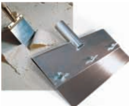
Mit einer Scharre, deren Griff durch einen Besenstiel verlängert wird, schält man Schmutz- und Schaumreste der alten Auslegeware vom Boden ab (Westermann).
