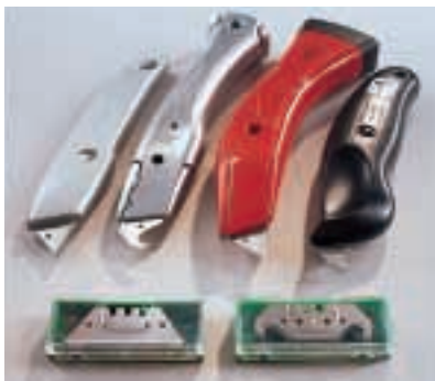
Teppichmesser mit unterschiedlichen griffformen, die man mit Trapez- oder Hakenklingen bestücken kann. Die Klingen haben zwei Schneiden und sind wendbar.
