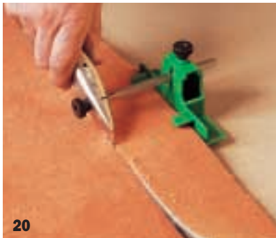
20 Streifen, die man zum Einkleben in Kunststofffußleisten benötigt, fertigt man mit einem Streifenschneider an. Die Breite ist stufenlos einstellbar (Westermann).
