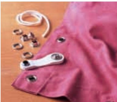
Nietösen: Wo die Stoffbahnen später aneinanderstoßen, werden Ösen eingeschlagen; ein Werkzeug gehört zum Set.
