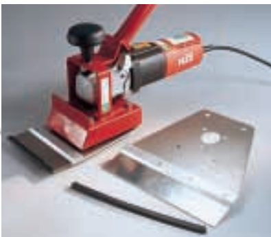
Stripper bringen ihr schabendes Messer in Schwingungen und schälen Schaum- und Kleberreste rückstandslos ab. Danach wird der Boden abgesaugt (Westermann).
