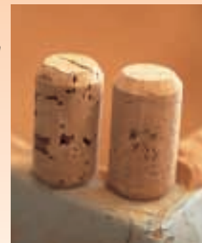
In einer Art Heißmangel werden die Poren des Korkenrohlings mit Korkstaub gefüllt
