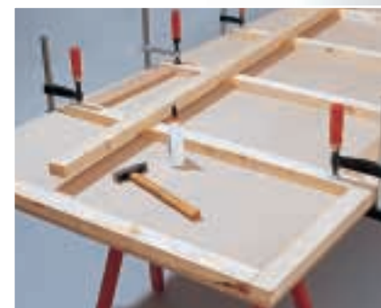
Eine Rahmenkonstruktion bildet das Rückgrat, umlaufende Leisten sind bündig mit der Plattenkante verleimt. Im oberen Fach wird die Hutablage angeschraubt. Dieses Bord liegt, wie die Möbelbeine, an der Wand an. Beim Montieren wird durch die aufgeleimte Leiste hindurch in die Wand geschraubt.
