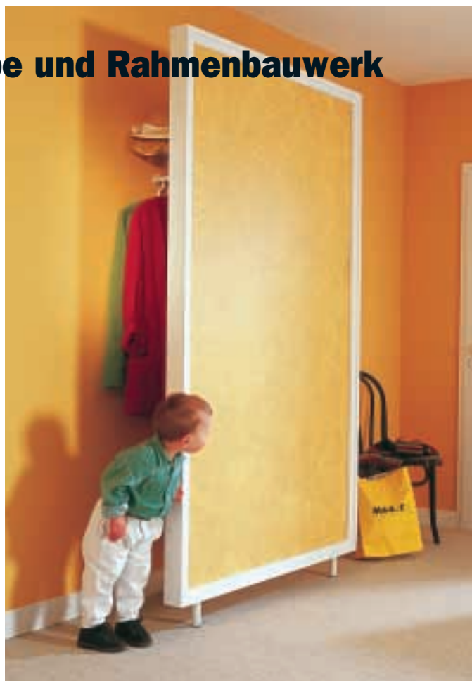
Bilderrahmen mit Hutablage: Die markanten Leisten betonen die Rahmenwirkung. Die innere Leiste sollten sie erst montieren, wenn die Spanplatte beschichtet ist.
