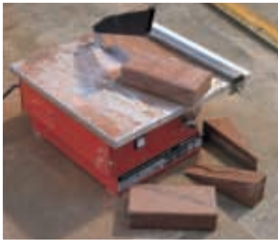
Viel genauer werden die Parallel- und Schrägschnitte an den Steine durch den Einsatz einer Spezialsäge, die man wie den Rüttler im Baumarkt leihen kann.
