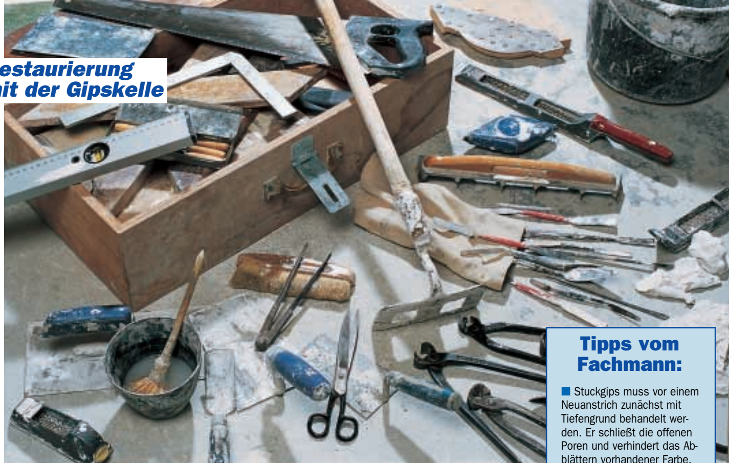
„Fummeleisen“, Kelle, Sägen und Gipshobel: die vielfältigen Werkzeuge eines Stuckateurs.
