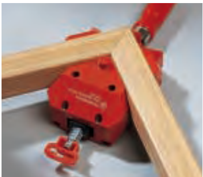
Winkelspanner pressen 90°-Ecken aus Quadrat- und Rechteckleisten sowie Plattenmaterial zusammen. Auch T-Verbindungen lassen sich einspannen. (Lux)
