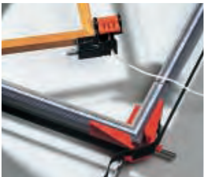
Zum Verleimen leichter Rahmen reichen einfache Rahmenspanner. Sie spannen mit Federkraft (oben, Wolfcraft) oder mit einem Gummigurt (unten, Bessey).
