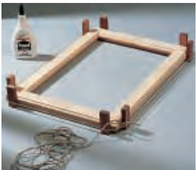
Auch aus einem Band und acht Klötzchen lässt sich ein Rahmenspanner zusammenstellen. Kerben in den Klötzchen verhindern ein Abrutschen des Bandes.
