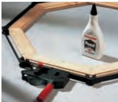
Bandspanner sind vielseitig einsetzbar. Neben Rahmen mit drei, vier, sechs oder acht Ecken kann man damit auch Stühle, Zargen und Schrankelemente pressen.
