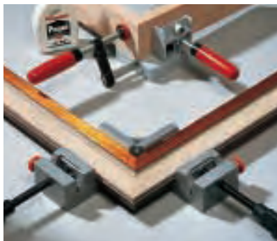
Der Multispanner (oben, Gross-Stabil) und das Spannmobil (unten, Wolfcraft) haben je zwei getrennte Spannelemente. Unterschiedliche Materialstärken sind möglich.
