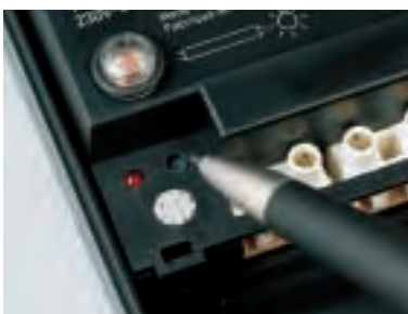
Am helllichten Tage aus-, bei einsetzender Dämmerung eingeschaltet, spät nachts wieder aus und morgens, bis zur vollständigen Helligkeit wieder an: Alle Schaltfunktionen und Dämmerungswerte sind einfach vorwählbar und werden gespeichert. Die Schaltleistung beträgt 1000 W. (Steinel)
