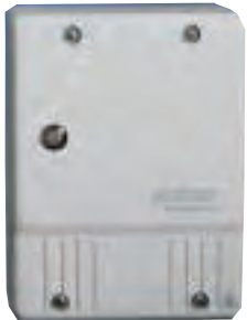
Am helllichten Tage aus-, bei einsetzender Dämmerung eingeschaltet, spät nachts wieder aus und morgens, bis zur vollständigen Helligkeit wieder an: Alle Schaltfunktionen und Dämmerungswerte sind einfach vorwählbar und werden gespeichert. Die Schaltleistung beträgt 1000 W. (Steinel)
