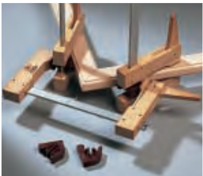
Zusatzteile aus Kunststoff machen aus drei hölzernen Klemmzwingen (Klemsia) einen Eckenspanner. Die Druckflächen der Zwingen sind aus schonendem Kork.
