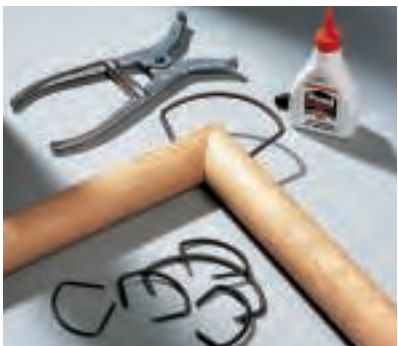
Gehrungsklammern spannen selbst Rundhölzer punktgenau. Sie werden mit der Sprezzange angesetzt und hinterlassen nur winzige Druckstellen. (Ulmia)
