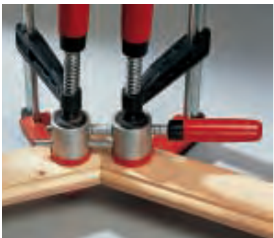
Zwei einfache Schraubzwingen setzen bei dem Gehrungsspanner (Gross-Stabil) die beiden Hülsen auf den Rahmenteil fest. Eine Spindel zieht diese dann zusammen.
