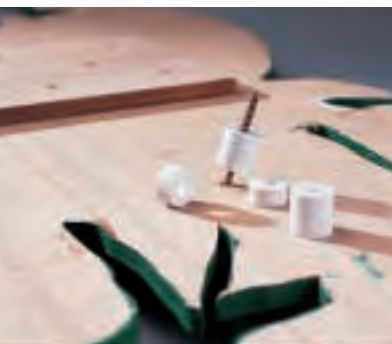
Für den gewünschten Abstand von der Wand verwenden Sie Distanzhülsen und entsprechend lange Schrauben.
