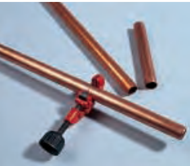
Exakt rechtwinklig gelingen die Zuschnitte des Kupferrohrs mit einem Rohrschneider (rund 30 Mark). Mit der Eisensäge geht's auch, anschließend muss entgratet werden!
