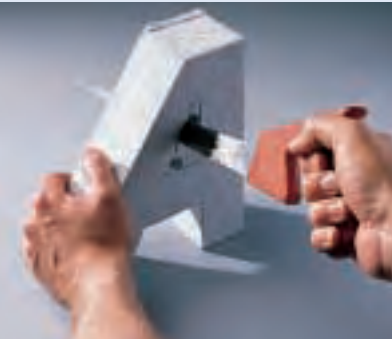
Die Bohrlöcher dienen als Einstieg für die Handstichsäge. Sägen Sie vorsichtig den Innenteil heraus und achten Sie darauf, dass der Stein nicht bröckelt.
