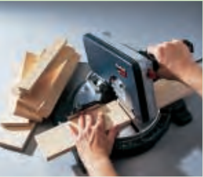
Die Bretter und Leisten werden am besten mit einer Kappsäge auf Länge geschnitten. Statt dessen können Sie auch eine Stichsäge oder eine Handsäge benutzen.
