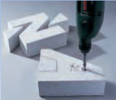
Bohren Sie mit einem großen Steinbohrer (mind. 14 mm) Löcher in die Ecken des Innenteils. Haben Sie keinen so großen Bohrer, setzen sie zwei Löcher nebeneinander.
