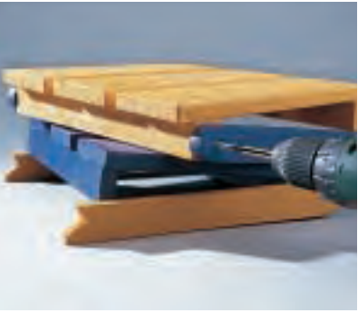
Zum Schluss werden die Seitenstützen an die Stufen geschraubt, aber nicht ganz fest angezogen, damit sie zum Einhängen in die Leiter noch etwas beweglich sind.
