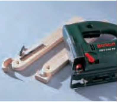
Runden Sie ein Ende jeder Seitenstütze ab. Entweder schneiden Sie die Rundung mit der Stichsäge aus und schleifen nach oder formen Sie mit dem Bandschleifer.
