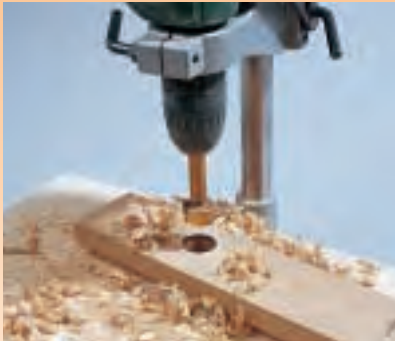
Mit einem Forstnerbohrer mit 22 mm Ø (Unbedingt Bohrstände benutzen!) wird im Abstand von 20 cm an den markierten Positionen die Wandleiste durchbohrt.
