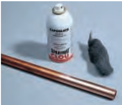
Schmucke Variante: Wer besonderen Glanz bevorzugt, poliert die Oberfläche der Kupferrohre mit feiner Stahlwolle. Ein Überzug mit Zaponlack schützt vor erneutem Anlaufen.
