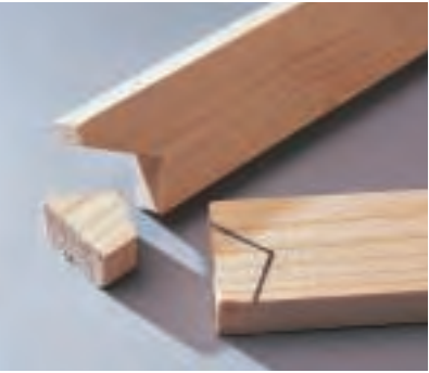
Auf der anderen Seite der Seitenstützen muss eine Einkerbung in der Gegenform der Leiterstufe ausgeschnitten werden. Zeichnen Sie diese vorher an.
