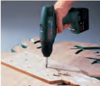
Zeichnen Sie das überlappende Baumstammende an, bevor Sie es auf die entsprechende Palmenkrone schrauben.
