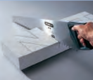
Zeichnen Sie die Buchstaben mit Hilfe der Schablone von allen fünf Seiten an, bevor Sie sie mit einer großzahnigen Porenbetonsäge möglichst verlaufsreich aussägen.
