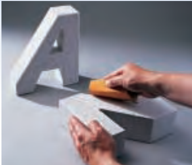
Schleifen Sie die Buchstützen mit herkömmlichem Schleifpapier, um die Kanten zu brechen und eventuelle Bohr- und Sägerillen auszugleichen.
