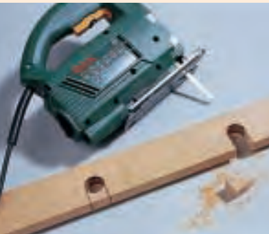
Mit einer Elektro-Stichsäge (oder manuell mit dem Fuchsschwanz) wird entlang den Linien von der Oberkante der Leiste bis an die Bohrungen gesägt.
