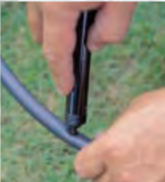
Regner , Tropfer und Düsen einfach in den zuvor angestochenen Schlauch stecken oder drehen.
