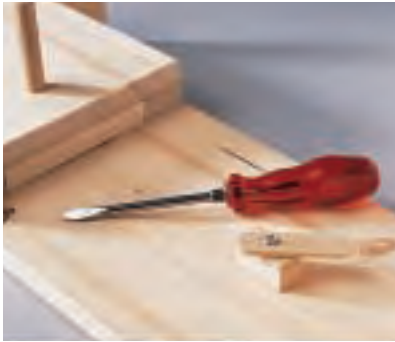
Bohren Sie den Klotz und den Sicherungsriegel vor und leimen Sie den Klotz dann auf. Den nötigen Druck erreichen Sie durch das Festschrauben des Riegels.
