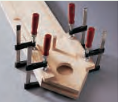
Um Druckstellen durch die Zwingen zu vermeiden legen Sie Zulagen auf die Frontplatte. Die Vogelstange wird unter Zugabe von Leim in die Bohrung geschlagen.
