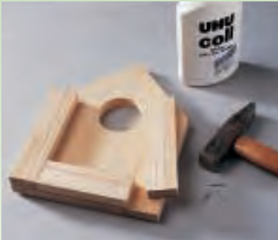
Die Seitenwände des Häuschens werden mit Leim eingestrichen und bündig zu den Seitenkanten aufgelegt. Sichern Sie die Teile mit Drahtstiften gegen Verrutschen.
