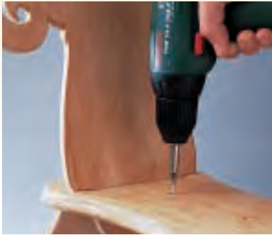
Streichen Sie die Einzelteile an den Stoßkanten mit Leim ein. Stecken und schrauben Sie den Hocker dann zügig zusammen.
