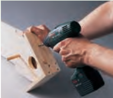
Schrauben Sie die beiden Dachbretter bündig zur Rückwand auf die Dachschräge. Bohren Sie die Schraublöcher vor, damit das Holz nicht reißt.
