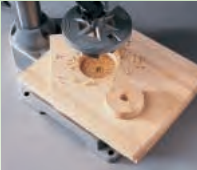
Um das Einflugloch zu sägen brauchen Sie eine Lochsäge. Idealerweise benutzen Sie einen Bohrständler, der ein Verkanten und Festsetzen der Lochsäge verhindern hilft.
