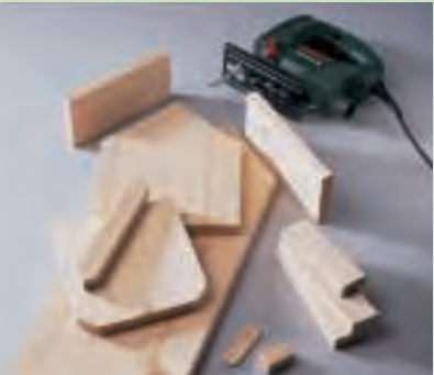
Als Baumaterial benötigen Sie ein gehobeltes Brett und eine Konstruktionsleiste. Übertragen Sie die Maße und sägen Sie die einzelnen Teile mit einer Stichsäge aus.
