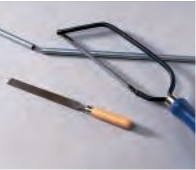
Die Alustangen lassen sich ganz leicht mit einer kleinen Metallsäge auf das richtige Maß zurechtschneiden. Die obere Stange muss etwas breiter als der Stoffschal sein.
