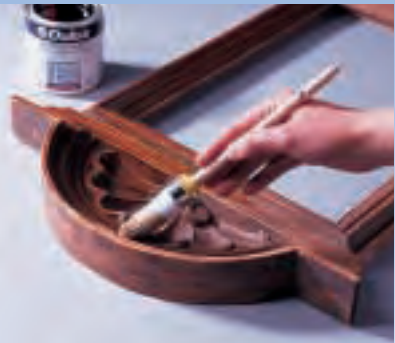
Der Rahmen wird zunächst gründlich gesäubert, schadhafte Stellen werden ausgebessert. Anschließend streicht man den Rahmen mit Klarlack.
