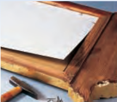
Zum Abschluss wird eine stabile Pappe von mindestens 2,5 mm Dicke (z. B. Bristolkarton) auf die Spiegelschicht gelegt und beide zusammen mit Glaserstiften fixiert.
