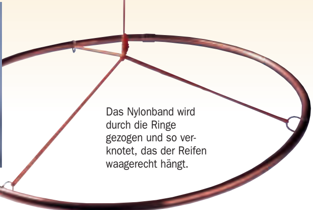
Entgraten Sie die Bohrlöcher mit einer Metallfeile, bevor Sie die Schlüsselringe durch die Löcher eindrehen.
