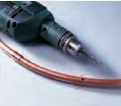
Der Rohrreifen wird an den vorgekürnten Stellen mit einem 6-mm-HSS-Bohrer möglichst mittig und senkrecht durchbohrt.
