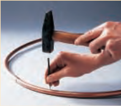
Zum Befestigen der Schlüsselringe wird der Kreisbogen gedrittelt. Die Position der Löcher ankörnen, damit der Bohrer „greift“.
