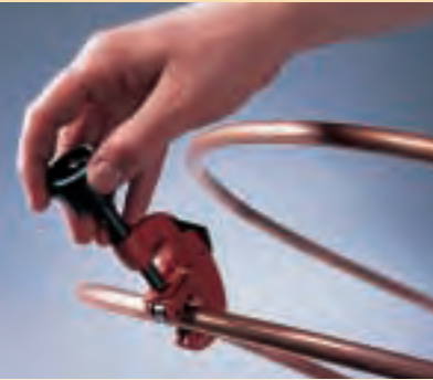
Schneiden Sie das Kupferrohr maßgenau zu, entweder mit einem Rohrschneider oder mit einer Metallsäge (Pucksäge).
