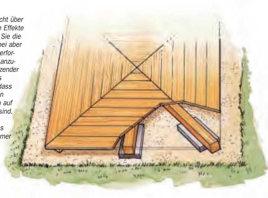
Das Traggerüst aus Kanthölzern wird auf dem Splitt-Unterbau genau ausgerichtet und verkeilt.
