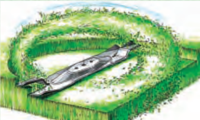
Das Mähermesser hat vier Schneiden und Windspoiler. Die Grashalme werden beim Mulchbetrieb sehr fein gehäckselt. Beim Fangmähen wirbeln die Windspoiler den Grasschnitt in den Fangkorb. (Viking)
