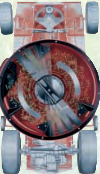
Deflektoren im Mähergehäuse führen das Schnittgut in die Messerkreisbahn zurück, wo es immer feiner geschnitten wird. Das Messer erzeugt einen starken Sog, der das Gras für einen sauberen Schnitt aufrichtet. Die feinen Graspartikel werden fast unsichtbar in den Rasen zurückgeblasen. (Toro)
