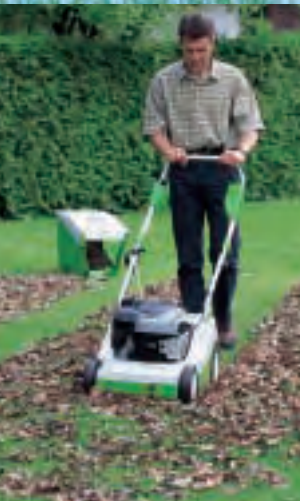
Ein Mäher und drei Funktionen: Mähen, Mulchen und Laubsammeln. Die vier Schneiden des Messers häckseln das Laub fast unsichtbar klein. (Viking)
