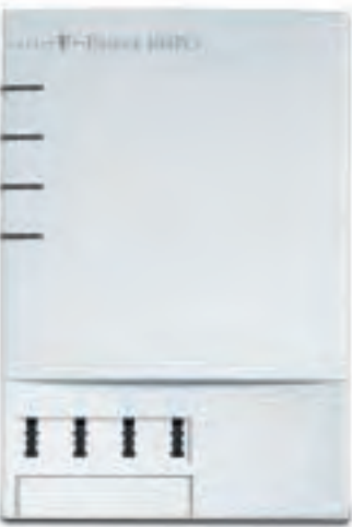
Multitalent: Vier analoge Endgeräte und ein PC am ISDN-Netz – auch das kann bereits eine kleine Telefonanlage leisten. Dabei erfolgt der Datenaustausch zwischen dem PC und der Telefonanlage über eine serielle Schnittstelle – ein Eingriff in den Rechner ist somit nicht nötig. Bei diesem preiswerten Gerät ist jedoch kein S 0 -Bus vorgesehen, wodurch man sich auf die Nutzung der vier analogen Endgeräte beschränken muss. (Telekom)
