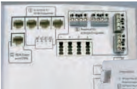
ISDN und analog. Diese Nebenstellenanlage bietet neben einem ISDN-S 0 -Bus für ISDN-Endgeräte Anschlussmöglichkeiten für vier analoge Geräte. Zudem kann man analoge und ISDN-Endgeräte entweder direkt an die Anlage anstecken oder aber die Anschlüsse über Leitungen zu einer Steckdose führen. (Telekom)
