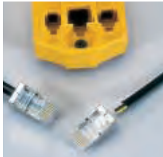
Anschlussleitungen für ISDN-Endgeräte haben meist vier Adern. Bei achtpoligen Steckern sind dann nur die vier mittleren Kontakte belegt.
