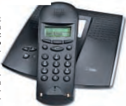
Schnurlos glücklich: Auch für ISDN gibt es schnurlose Telefone, die alle ISDN-Leistungsmerkmale unterstützen. Durch den Einsatz solcher Telefone kann man sich also manche Installation ersparen. (Telekom)
