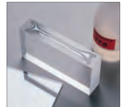
Kantenverklebungen bei dickem Plattenmaterial lassen sich mit dem zähflüssigen Acrifix 116 durchführen. Den Kleber auftragen und die Teile sofort zusammenfügen.
