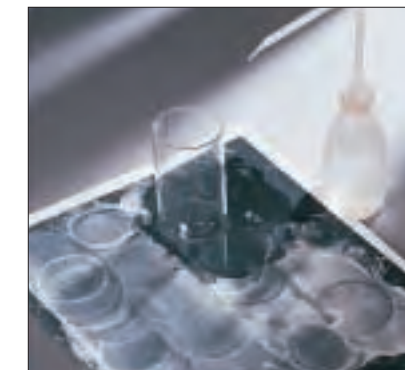
Lösemittelklebstoffe sind nur gering fugenfüllend. Die Klebeflächen müssen genau zueinander passen. Das erreicht man durch Planschleifen mit 600er-Nassschliffpapier.
