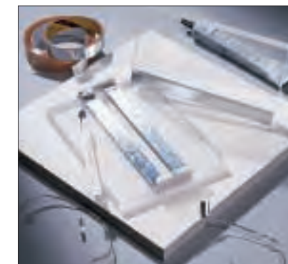
Der lichterhärtende Kleber Acrifix 192 ist fugenfüllend und braucht einen Klebespalt. Die Flächen neben der Klebnaht werden zum Schutz mit Spezialklebeband bedeckt.
