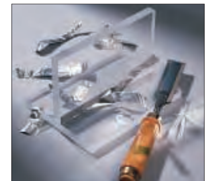
Überschüssiger Kleber setzt sich auf den Klebebändern ab und kann mit einem Stechbeitel abgehoben werden. Die Klebebänder erst nach Aushärten des Klebers abziehen.
