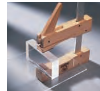
Leichter Druck auf die Verklebung mit Acrifix 116 verringert die Bläschenbildung. Die Fixierung kann nach kurzer Zeit gelöst, das Teil nach etwa 3 Std. bearbeitet werden.
