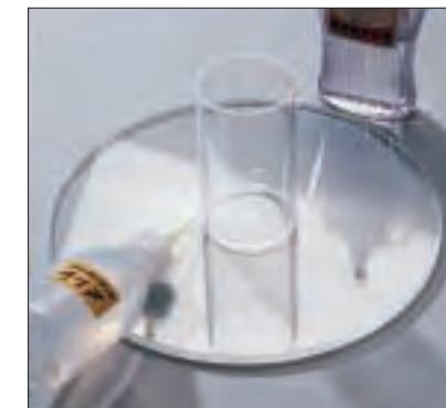
Kontaktflächen geringer Größe eignen sich zum Zusammenfügen mit dem dünnflüssigen Acrifix 117. Der Kleber wird angegeben und zieht sich von selbst in die Fuge.
