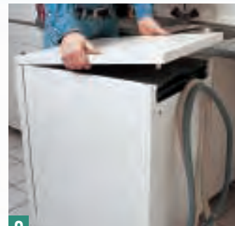
3 Die Arbeitsplatte von der Maschine abnehmen. Dazu an der Rückseite die Schrauben lösen und die Platte nach vorne abziehen.
