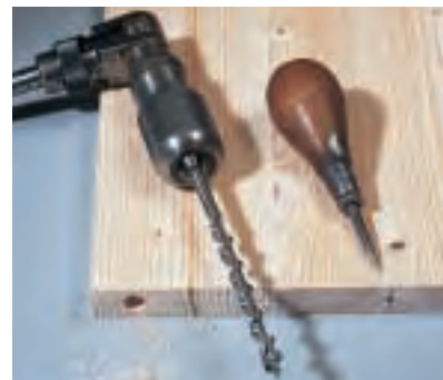
Bohrwinde, Schlangenbohrer Ø 10 mm, Vorstecher. Mit dem Schlangenbohrer werden Dübellöcher nach Anriss gebohrt. Das Zentriergewinde zieht ihn „auf den Punkt“ ins Holz, wenn gut markiert wurde.
