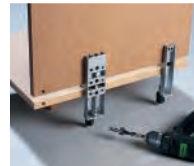
Mit dem Holzdübel von Wolfcraft können jeweils beide zusammengehörigen Löcher einer Dübelposition unmittelbar nacheinander auf Anschlag gebohrt werden. Das aufwendige Anreißen entfällt.
