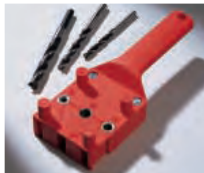
Der Holzspiralbohrer benötigt beim Bohren in die schmalen Kanten eine Führung. Handelsübliche Bohrschablonen (hier Wolfcraft) haben Führungshülsen aus Stahl in den Durchmessern 6, 8 und 10 mm.
