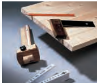
Arbeitet man ohne Dübelhilfe, muss zuerst die Mitte auf den Kanten angezeichnet werden. Das geht am besten mit einem Streichmaß mit dem – je nach Modell ein, zwei oder vier Maße fixiert werden.
