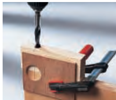
Für Dübellöcher über 10 mm Durchmesser fertigt man sich die notwendige Bohrschablone selbst an, am besten aus einem Stück Hartholz, das dieselbe Dicke hat wie das Werkstück.
