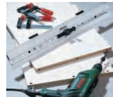
Die Dübelleiste von Wolfcraft hat Löcher im 32-mm-Raster, in der der Bohrschlitten einschnappt. Mit ihr können Boden-trägerreihen und Dübellöcher an der Kante und in die Fläche gebohrt werden.
