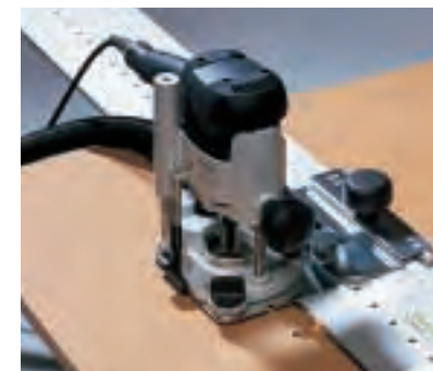
Mit der Oberfräse, die auf der Lochschiene geführt wird, lassen sich Lochreihen in der Fläche bohren. Der Fräser hat keine oder nur eine kurze Zentrierspitze, das Nachbohren mit dem Forstner erübrigt sich.
