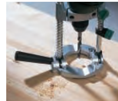
Für Löcher in der Fläche, die außerhalb der Reichweite des Bohrständers liegen, bietet sich das Bohrmobil von Wolfcraft an. Die Löcher werden genau senkrecht wie unter dem stationären Bohrständer.
