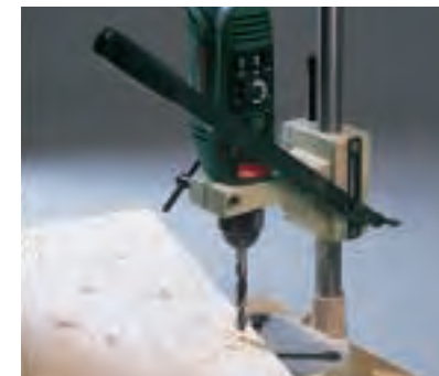
Die Dübellöcher in der Fläche bohrt man möglichst unter dem Bohrständer. Die Zentrierspitze des Holzspiralbohrers lässt sich genau ansetzen. Die Dübelmitten mit dem Vorstecher exakt markieren!
