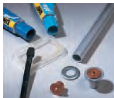
Marker für 12er Dübellöcher kann man sich leicht selbst anfertigen. In einen Abschnitt von 12/10ner Alurohr klebt man einen 10-mm-Marker. Als Kragen wird eine Unterlegscheibe aufgeklebt.
