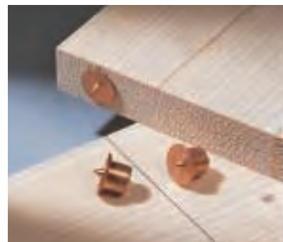
Mit Dübelmarkern überträgt man die Dübellöcher von der Kante auf das Gegenstück. Es gibt sie in Durchmessern von 6, 8 und 10 mm. Ihre Spitzen hinterlassen deutlich ausgebildete Markierungen.
