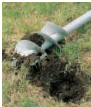
Erdbohrer sind sehr praktisch, wenn viele Pfähle eingesetzt werden müssen. Ansonsten genügt auch ein Lochspaten.
