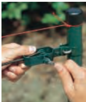
Die Drahtenden werden in die Bohrung der Spannerstifte eingefädelt, mit dem Schlüssel aufgewickelt und so gespannt.
