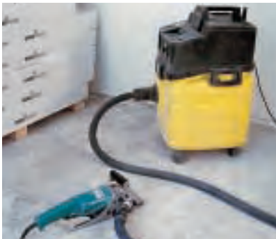
Steinstaub ist besonders aggressiv und ungesund. Speziell für Steinstaub geeignete Sauger kann man ausleihen. Das ist ratsam bei umfangreicheren Arbeiten.
