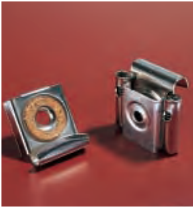
Die klassischen Spiegelhalter müssen Sie sehr genau in der Wand setzen und verdübeln. Übrigens: Die Halter mit der Feder kommen immer nach oben.
