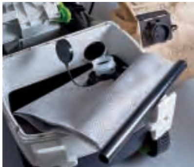
Dieser Filtersack kann immer wieder benutzt werden und ist einfach zu entleeren. Die Papierfiltersäcke sind „Einwegverpackungen“, das geht ins Geld. (Festool)
