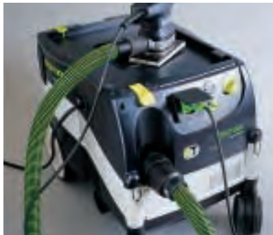
Einschaltautomatik und Saugkraftregulierung sollte ein Werkstattsauger haben. Beim Einschalten der Maschine läuft der Sauger mit Verzögerung an. (Festool)
