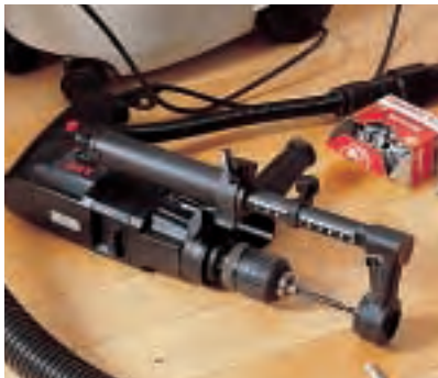
Regale und Bilder werden nach dem Renovieren wieder aufgehängt. Mit diesem Aufsatz kann das Bohrmehl direkt am Bohrloch abgesaugt werden. (AEG)
