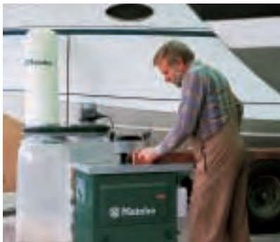
Eine Tischfräse erzeugt beim Arbeiten so viel Späne, dass die kleinen Werkstattsauger überfordert wären. Hier ist eine Absauganlage das einzig Richtige.
