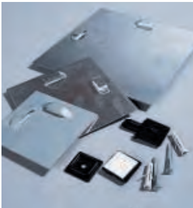
Metallplatten, auf die Spiegelrückseite geklebt, werden per Dübel in der Wand befestigt. An der Unterseite des Spiegels halten Abstandhalter das Ganze im Lot.
