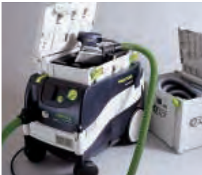
Mobiles Einsatzkommando. Beim Festool-Sauger können die Gerätekästen auf der Ablage arretiert werden. So rollt man komplett ausgerüstet zum Einsatzort.
