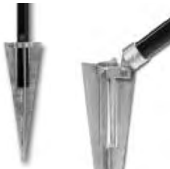
Einschlagbodenhülsen, 45 cm lang, für einen Rohrpfahl mit 34 mm Durchmesser. Rechts: Eine Rohrstrebe mit Spezialkappe winklig an die Bodenhülse geschraubt.
