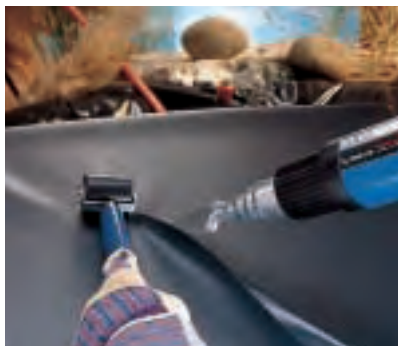
Kunststoffplanen, beschichtete Gewebe und Folien verschweißen: Die Folien werden etwa 2 bis 4 cm überlappend aufeinander gelegt und straff gehalten. Mit der Schlitzdüse bläst man die Heißluft unter die Überlappung. Das Material wird in Sekundenschnelle weich und dann sofort mit einer Andruckrolle angewalzt.
