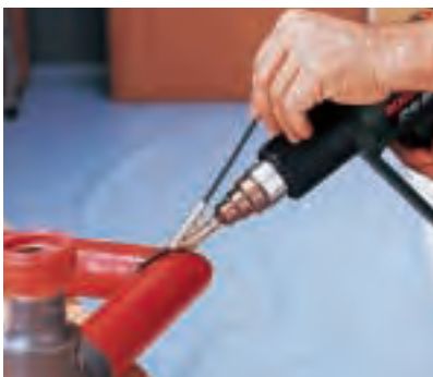
Kunststoffe miteinander verschweißen: Beide Teile müssen aus dem gleichen Werkstoff bestehen, und auch der Schweißdraht muss zum Material passen.
