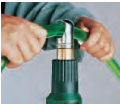
Kunststoffschläuche verformen: Mit der Reflektordüse wird der Schlauch gleichmäßig erwärmt und bis zum Erkalten in der gewünschten Stellung gehalten.
