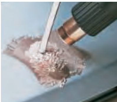
Verzinnen als Rostschutz: Die Temperatur der Heißluftpistole reicht vollkommen aus, um Zinn zu schmelzen, am besten mit der Punktdüse. Zinn kann so stark verflüssigt werden, dass auch Zinnfiguren gegossen werden können.
