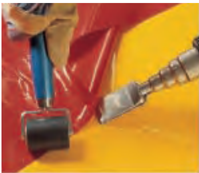
Kunststoffe miteinander verschweißen: Beide Teile müssen aus dem gleichen Werkstoff bestehen, und auch der Schweißdraht muss zum Material passen.
