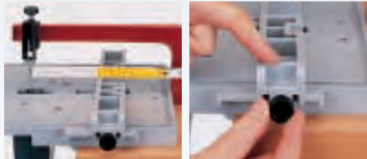
PARALLELANSCHLAG. Der Abstand zwischen Sägeblatt und Anschlag wird mit Hilfe eines Maßstabs eingestellt. Rändelschrauben an beiden Seiten des Parallelanschlags sorgen für einen sicheren Halt am Tisch.
