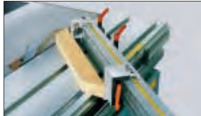
Die Anschlagreiter des Ablänganschlags lassen sich durch ihre Kniehebelspannen blitzschnell und mühelos einstellen. (F)
