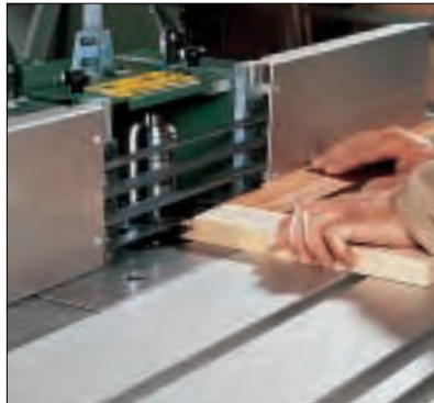
Schmale Werkstücke , die an den Enden gefräst werden sollen, könnten zwischen Anschlag und Fräser geraten. Zur Sicherheit wird ein Schiebeh Holz angesetzt. (F)
