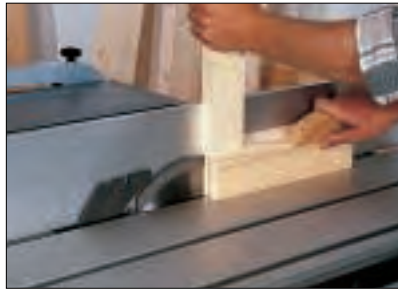
Mit einer Zuführlehre können am Parallelanschlag Schlitz und Zapfen für eine Rahmenecke angeschnitten werden. (F)
