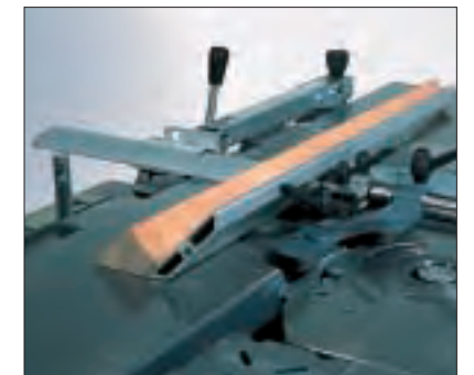
An dem schrägstehenden Längsanschlag kann man Schmiegen, Kanten für Gehrungen oder Dreieckleisten herstellen. Den ungenutzten Teil der Welle abdecken. (R)
