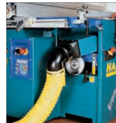
Hinter der Messerwelle sitzt die Spanabsaugung unterhalb des Hobeltisches. Zum Entfernen der feinen Hobelspäne braucht man eine leistungsfähige Absaugung. (H)
