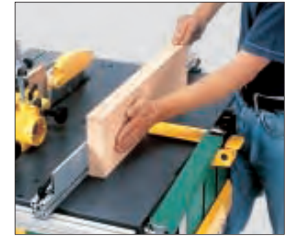
Zum Anhobeln rechtwinkliger Kanten führt man das Brett mit der abgerichteten Fläche am Anschlag entlang und glättet die Schmalseite des Holzes. (K)
