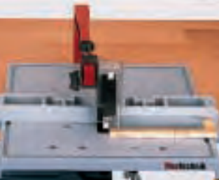
Beim Sägen von Metall entsteht an der Unterseite des Werkstücks ein Grat, der das Verschieben des Teils erschwert und den Säge Tisch zerkratzt. Daher sollte man bei der Verarbeitung von Metall immer eine Holzplatte unterlegen.
