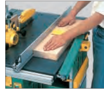
Abrichten nennt man das Planhobeln der ersten Fläche eines sägerauen Bretts. Das Holz wird gleichmäßig gegen die Drehrichtung über die Messerwelle geschoben. (K)
