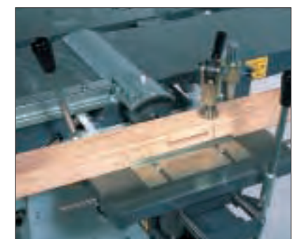
Mit Exzenterspannern und verstellbaren Anschlängen fixiert man das Werkstück auf dem Arbeitstisch. Das Spannfutter für den Fräsbohrer sitzt am Ende der Messerwelle. (R)
