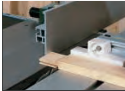
Abgesetzt wird der Zapfen am Ablänganschlag auf dem Schiebetisch. Die Schnittbreite am Parallelanschlag einstellen. (F)
