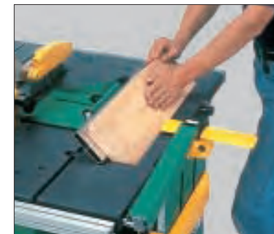
Der Längsanschlag der Hobeleinrichtung kann bis zu einer Schräge von 45° gekippt werden. So können Kanten angefasst oder mit einer Schräge versehen werden. (K)
