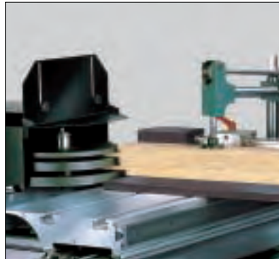
Mit dem Format-Schiebetisch lassen sich an der Fräseinheit Schlitzarbeiten durchführen. Ein Kniehebelspanner hält das Werkstück auf dem Tisch in Position. (F)
