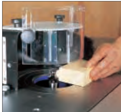
Mit Schaftfräsern , die eigentlich für die Handoberfräse vorgesehen sind, lassen sich auch Kanten profilieren. Der Anlaufring des Fräasers führt das Werkstück. (H)
