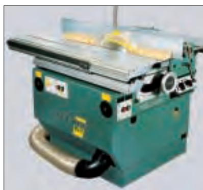
Die Kreissägeeinheit hat bei allen Fünffachen eine duale Spanabsaugung. Unter dem Tisch im Maschinengehäuse und über einen dünnen Schlauch in der Spanhaube. (F)
