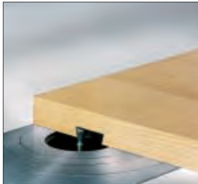
Eine Gratnut kann auf der Fräse hergestellt werden, wenn mit einem Schaftfräser gearbeitet wird. Statt des Dorns wird dazu eine Spannzange auf die Spindel gesetzt. (F)
