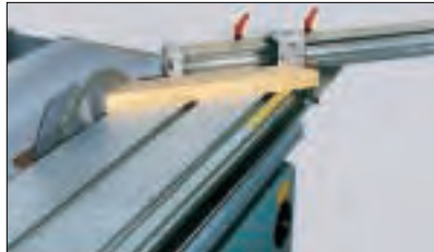
Auch Gehrungsschnitte sind mit Hilfe des Ablänganschlags möglich. Der Anschlag ist in beiden Richtungen verstellbar. (F)
