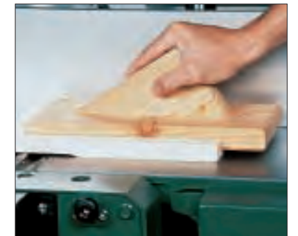
Mit der Lade schiebt man das Werkstück gefahrlos über die Messerwelle. Die Sicherheitsabdeckung über der Messerwelle wurde nur für die Fotos weggeschwenkt. (F)
