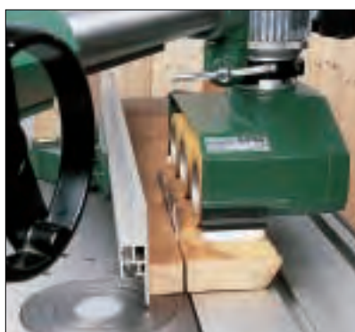
Bei Längsschnitten ist der Vorschubapparat ein Zubehör, das Werkstücke präzise und unfallsicher führt. Besonders bei Serienschnitten spart er Muskelkraft. (F)
