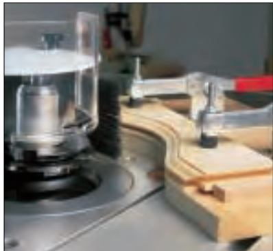
Beim Kopierfräsen ist ein kugelgelagerter Anlaufring auf der Frässpindel Anschlag für das Werkstück. Die Form der Schablone wird 1:1 auf das Werkstück übertragen. (F)
