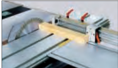
Der Ablänganschlag am Schiebetisch sorgt für Abschnitte absolut gleicher Länge. Die Einstellung erfolgt über eine Skala. (F)
