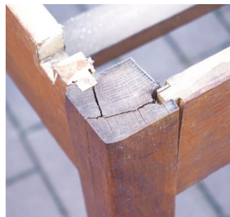
Zahlreiche Macken sind das eine, aber strukturelle Mängel wie die gebrochenen Stollen zeigen: nicht mehr zu reparieren.
