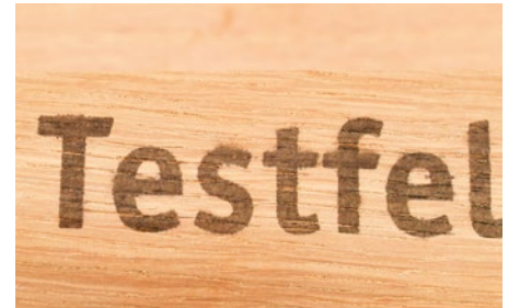
Grob geschliffene Eiche zeigt es: Der Transfer funktioniert nur dort, wo das Papier in direktem Kontakt zum Holz ist. Eine unebene Oberfläche sorgt dafür, dass das Aceton unter das Papier schwimmt und so die Konturen verwischen.
