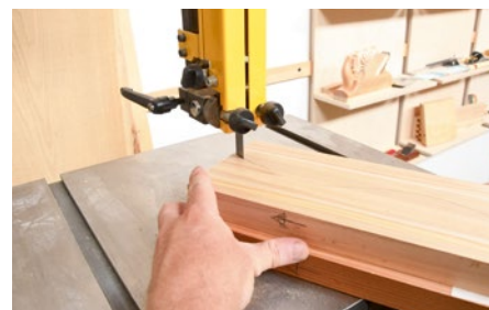
Trennen Sie nun beide Blöcke in einem Wellenmuster auf. Sägen Sie ruhig frei in weiten Bögen. Ein mindestens 10 mm breites Sägeband sorgt dafür, dass Sie wirklich nur sanfte Wellen und nicht versehentlich starke Kurven sägen.
