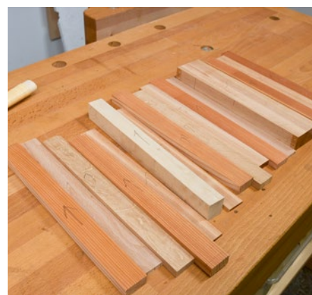
Richten Sie vor dem Verleimen alle Hölzer aus. Sie müssen so angeordnet werden, dass Sie jedes Stück – und damit später den ganzen Block – immer mit der Faser hobeln. Markieren Sie die Richtung auf jedem Stück.
