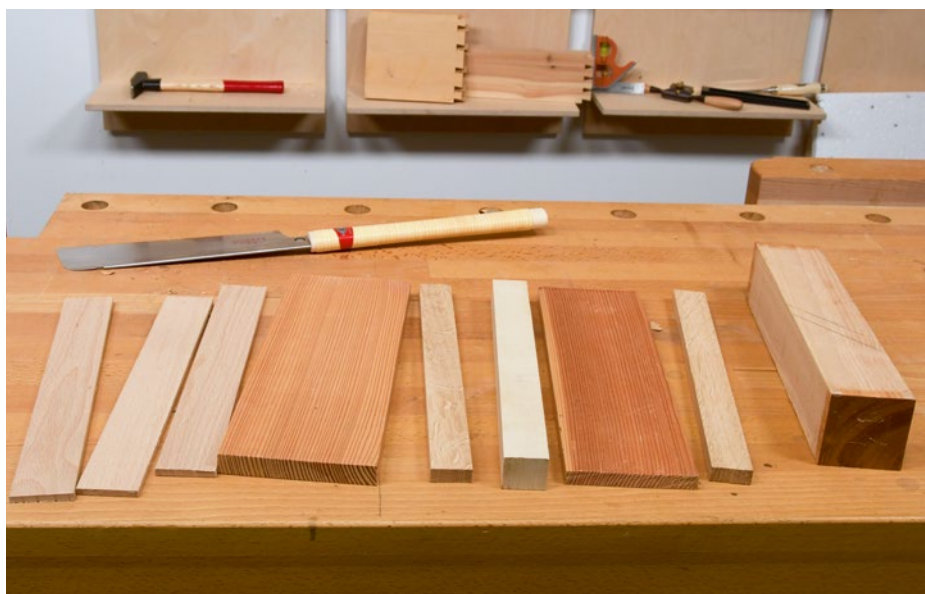
Unsere Blöcke bestehen aus Rotbuche, Hainbuche, Eiche, Esche und Lärche. Die hellen und rötlichen Töne bilden einen schönen Kontrast zum Nussbaum-Furnier, das später noch eingewebt wird. Sägen Sie alle Stücke auf die gleiche Länge und Breite.
