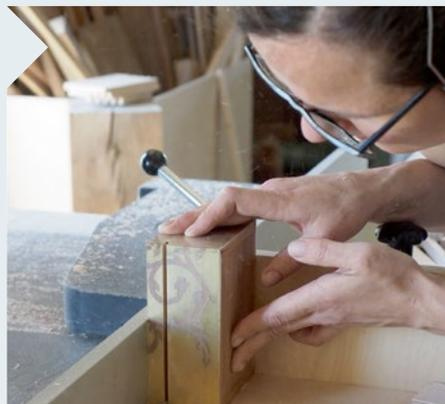
**16** | Beim Abtrennen des Deckels ist eine Opferplatte unten und am Anschlag zum Schutz gegen das Ausreißen Pflicht. Lassen Sie am besten einen Millimeter der Seitenwände stehen, um das Kästchen nicht aus Versehen in das Sägeblatt zu drücken.
