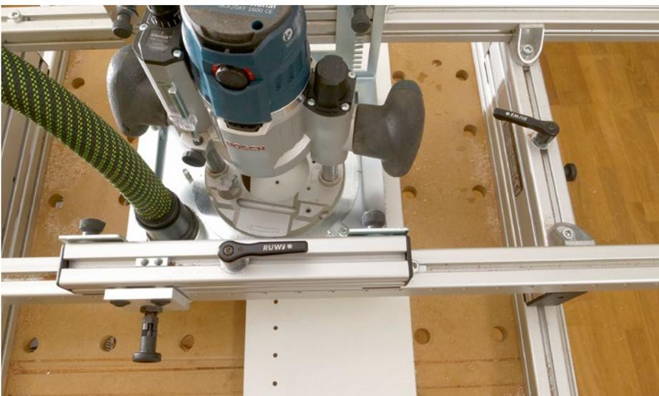
Bohren, weiterfahren, wieder bohren: Die Raster-32-Funktion ermöglicht Möbelbau wie in der Industrie, ganz ohne CNC. Allerdings natürlich in einem anderen Tempo. Eine Schrankseite in MFT-Länge (110 cm) braucht schon locker zehn Minuten.
