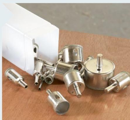
**2** Für das Bohren kommen solche mit Diamantsplittern besetzte Bohrer zum Einsatz. Ein solcher Billig-Satz ist im Netz schon für unter 20 Euro zu haben. Benötigt wird hier konkret der 25-mm-Kronenbohrer.
