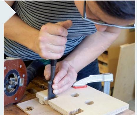
**20** | Um die Scharniere einzulassen, hilft eine vorbereitete Schablone mit einem Bündigfräser (Vorsicht, der Schneidendruck muss nach innen gehen, sonst löst sich das Messing!). Die Ecken stechen Sie winklig aus.
