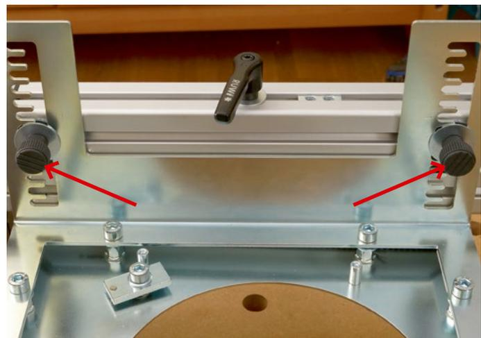
Der so genannte Aufnahmerahmen legt die Höhe der Fräse über dem Werkstück fest (Z-Achse). Dazu werden diese Schrauben (zwei von vier im Bild, Pfeile) gelöst, die Blechkämme ausgehängt und höher oder tiefer wieder eingehängt. Das ist die grobe Festlegung. Die Feineinstellung der Z-Achse, also der Spanabnahme oder auch der Tiefe einer Nut, erfolgt an der Oberfräse.
