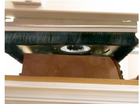
Unter dem Aufnahme-rahmen sind vier Bürstenleisten befestigt. Das Bürstenrechteck soll den Absaugstrom auf das Werkstück fokussieren. Das klappt auch. Aber nur, wenn der Fräser nicht gerade an einer Kante arbeitet oder das Werkstück zu schmal für den Rahmen ist.
