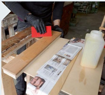
**10** Der Fischleim wird mit einem Zahnschachtel aufgetragen. Um einen gleichmäßigen Pressdruck zu erzeugen, gilt bei den Zwingen: Viel hilft viel. Trotz dicker Zulagen sollten Sie darauf achten, dass Sie wirklich überall bis zum Rand Druck erzeugen.
