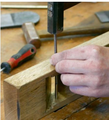
Wenn die Klappe zu breit für den Hobelkörper ist, können Sie an den inneren Seiten etwas Material abnehmen. Klopfen Sie dafür zunächst den Widerlagerstift aus dem Hobelkörper.
