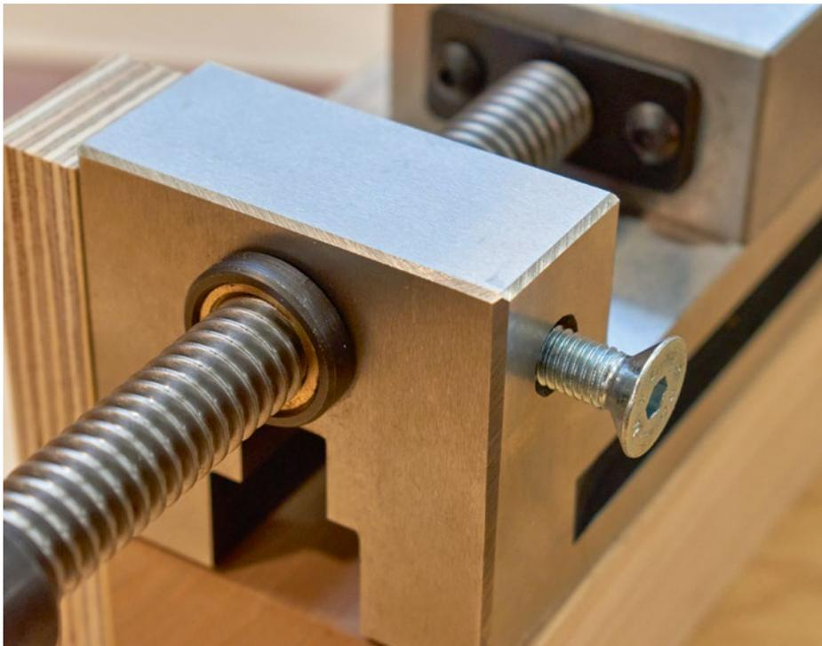
Die Montage des seitlichen Bretts ist sehr einfach: Das Schraubstockmodell ist mit entsprechenden 8-mm-Gewindebohrungen versehen.
