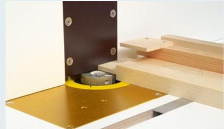
**6** | ... Rahmenstück einen Zapfen anzufräsen. Sie können aber auch problemlos, wie bei einem Vorsatzbrett, in das Kahlbrett hineinfläsen. Das bietet einige Vorteile und Fehlfräsungen sind so gut wie ausgeschlossen. Und wenn eine Kante des Kahlbretts angefräst wurde, dann können Sie es im Nu auf die andere Kante umdrehen. Diese modulare Bauweise bietet im Gegensatz zum herkömmlichen Vorsatzbrett deutliche Vorteile.
