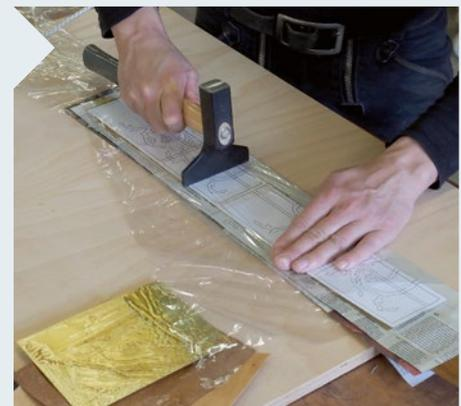
**3** Um die Wärme wieder zu entziehen und Druck zu erzeugen wird am besten ein Furnierhammer verwendet. Die Reihenfolge der Schichten von unten ist: Zeitungspapier – Weichholzfurnier – Zeitungspapier – Kirschbaumfurnier – Messing-Vorlage der Zeichnung.
