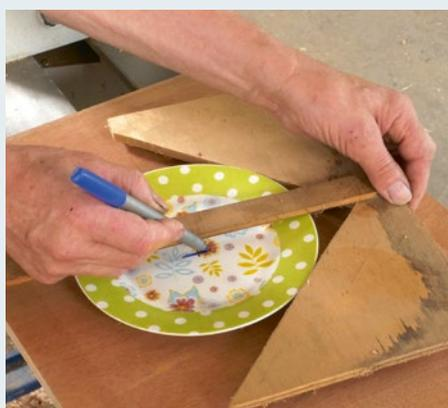
**1** Mit einer einfachen Hilfsschablone zeichnet sich der Tellermittelpunkt in Windeseile an: Anlegen, Strich ziehen, Schablone um 90° drehen, erneut markieren.
