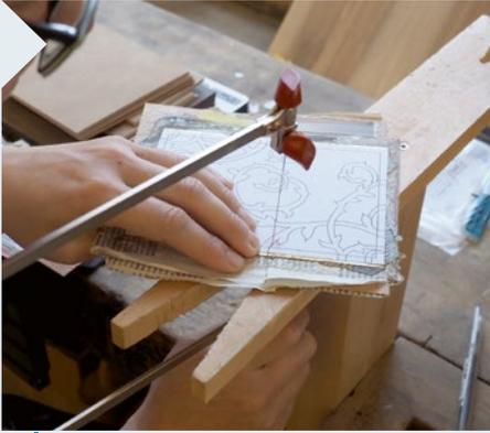
**4** Auftritt für die Laubsäge, die das verleimte Paket entlang der Linien zerteilt. Es macht nichts, wenn sich die Schichten schon gesägter Bereiche voneinander lösen. Notfalls bügeln Sie noch einmal mit etwas Feuchtigkeit nach.
