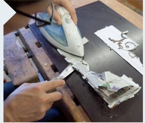
**6** Beim Lösen der Schichten größerer Stücke ist oft der Spachtel in Kombination mit dem Bügeleisen am effektivsten. Die Schonlage, die dabei zerstört werden darf, sollte daher nach oben zeigen.
