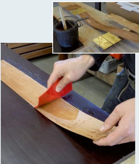
**1** Streichen Sie alle Furniere und das Messing beidseitig mit einem Zahnpachtel mit dünnem Knochenleim ein und lassen Sie sie auf abgeklebten Leisten für etwa zwei Stunden trocknen. So kann die Feuchtigkeit zu beiden Seiten entweichen.
