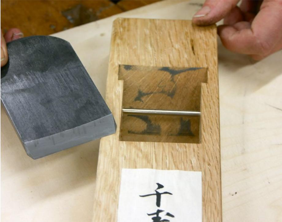
Das Grafit hat ganze Arbeit geleistet: Die Kontaktflächen zwischen Eisen und Holz sind deutlich eingefärbt.
