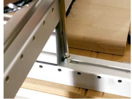
Die Wege der X- und der Y-Achse werden in den Führungsschienen genau an diesem Punkt gestoppt. Die insgesamt acht Schraubvorgänge dauern nicht lang. Angenehmer Nebeneffekt: Die Methode funktioniert unabhängig vom Fräserdurchmesser und es muss nicht umständlich mit dem Maß einer Kopierhülse gerechnet werden.
