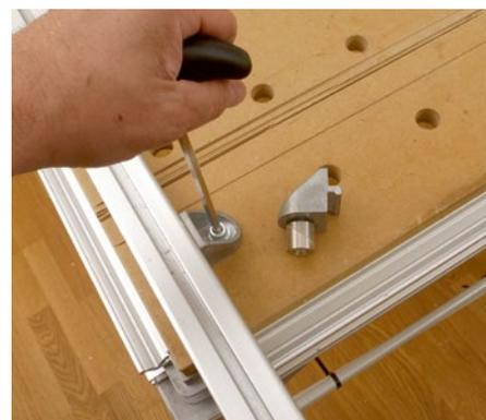
Ganz ohne Gefummel von der Unterseite befestigen die zweiteiligen Spannelemente die 135 cm langen Längsschienen (Y-Achse) in den 20-mm-Löchern eines MFT. Hersteller Ruwi bietet auch noch größere Platten mit diesem Raster an. Die Befestigung des SlabMatrix mit Winkeln an einem einfachen Brett ist aber auch möglich.
