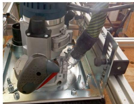
Beim Abrichten einiger Kirschbohlen-Stücke zeigt sich schnell: Das Absaugen zwischen den Bürsten funktioniert hier nicht richtig. Von oben an der Oberfräse angesetzt ist es etwas besser. Bei etwas kräftigerer Spanabnahme kommt nicht die 1600-Watt-Maschine, aber der Staubsauger an seine Grenzen. Kräftiges Abrichten ist auch mit der SlabMatrix eine staubige Angelegenheit.
