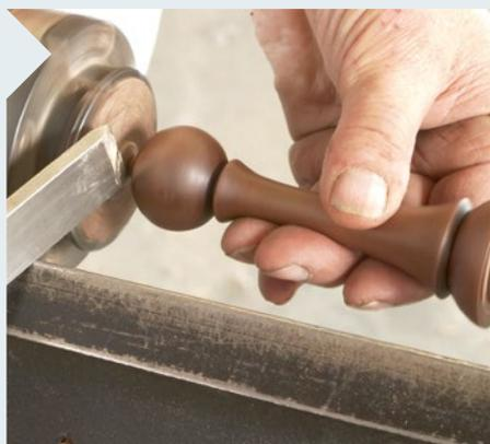
**18** | Stechen Sie das geschliffene und mit dem Oberflächenmittel Ihrer Wahl (hier: Distel-Öl) versehene Oberteil ab. Versäuern Sie anschließend den kleinen Ansatz mit etwas Schleifpapier und tragen Sie auch hier Öl auf.
