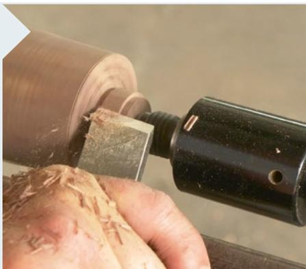
**14** | Spannen Sie nun den Oberteil-Rohling ein. Er muss von der Reitstockseite unterstützt werden. Das ist nötig, wenn – Daumenregel – die Werkstücklänge mehr als das 2,5-Fache des eingeklemmten Durchmessers beträgt.
