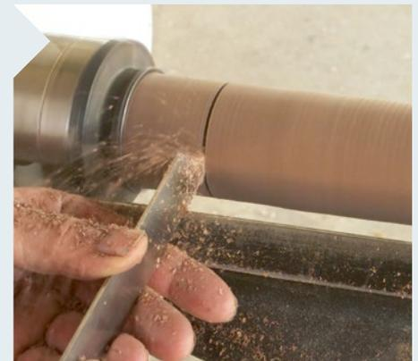
**10** Wechseln Sie für den nächsten Schritt ins Vierbackenfutter. Für das Unterteil stechen Sie vom Gesamt-Rohling 35 mm ab.
