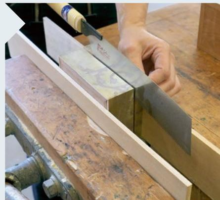
**17** | Eine Japansäge führt den Trennschnitt zu Ende. Der verbleibende kleine Überstand wird zum Beispiel mit dem Stechbeitel verputzt.
