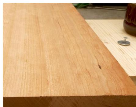
Die Oberflächengüte ist überraschend gut. Zwar sind ganz kleine Stufen zwischen den Frässpuren sichtbar und fühlbar. Sie verschwinden aber sehr schnell beim Schleifen.
