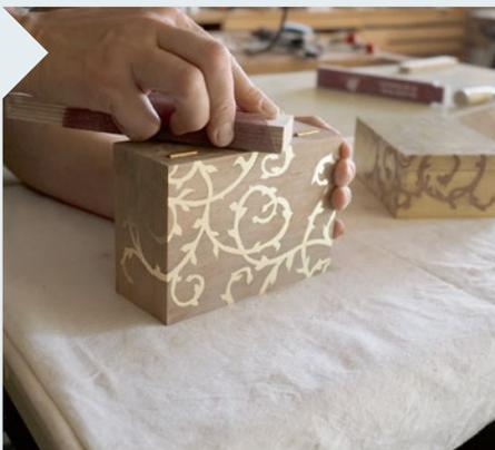
**22** | Sie können direkt mit einem Schleifpapier der Körnung 240 starten und feiner werden, bis der gewünschte Glanzgrad erreicht ist. Wichtig ist, dass sie beim Schleifen zu Beginn einen harten Schleifklotz nehmen. So schleifen sie keine Vertiefungen in das weichere Furnier.
