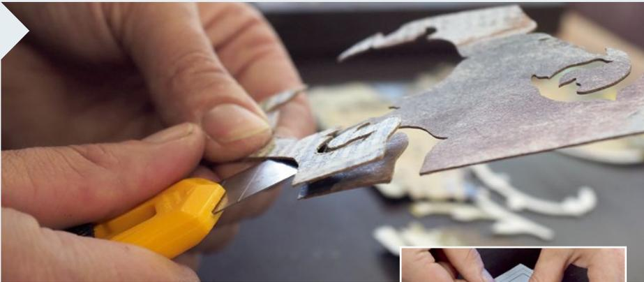
**7** Bei schmalen Teilen ist oft das Cuttermesser hilfreicher. Sortieren Sie das Weichholz direkt aus und verbinden Sie die kleinen Furnier- und Messingteile auch umgehend mit Furnierpapier.
