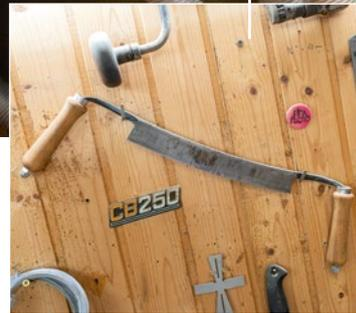
**Ziehmesser** sind in vielen Werkstätten (und rustikal eingerichteten Bars und Restaurants) ein wenig genutzter Wandschmuck. Dieses Exemplar hat aber genug zu tun: Alles, was an nassem Drechsel-(Lang-)Holz in die Werkstatt kommt, verliert damit Rinde und Splint. Anschließend übernimmt die Drechselbank das Runddrehen der Rohlinge, bevor es zum Trocknen geht. Das Ziehmesser ist dann meist schon wieder mit dem nächsten Stämmchen beschäftigt.
