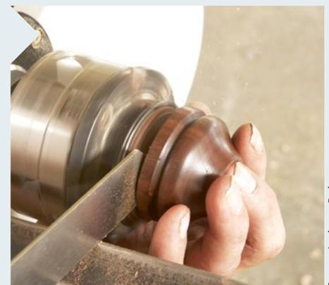
**13** Nach dem Feinschliff und etwas Öl stechen Sie das Unterteil nah am Futter ab. Schwenken Sie das Werkzeug dabei leicht nach links, so dass es etwas „hintersticht“. So steht der Fuß später rundum satt. Säubern Sie die Unterseite mit etwas Schleifpapier.
