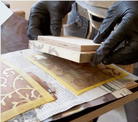
**18** | Jetzt erst kommt das große Ornament auf den Deckel: Eine Markierung mit Klebeband hilft bei der Positionierung. Beim Verleimen lassen Sie den Fischleim kurz anziehen, damit die Marketerie nicht so leicht verrutscht, wenn die Zwingen angesetzt werden.
