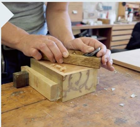
**15** | Putzen Sie nun den Deckel. Ja, zugegeben: Die Klinge des Hobels sollte scharf sein und sie leidet außen am Messing! Wer das nicht möchte, legt sich ein Schleifpapier auf eine plane Fläche und richtet die Oberseite darüber ab.
