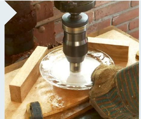
**7** Mit einem Glasteller ist die Ausführung kaum anders. Seien Sie hier aber mit dem Druck des Bohrers aufs Material noch feinfühlicher als beim Porzellan.
