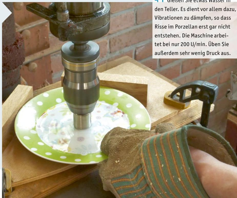
**4** Gießen Sie etwas Wasser in den Teller. Es dient vor allem dazu, Vibrationen zu dämpfen, so dass Risse im Porzellan erst gar nicht entstehen. Die Maschine arbeitet bei nur 200 U/min. Üben Sie außerdem sehr wenig Druck aus.
