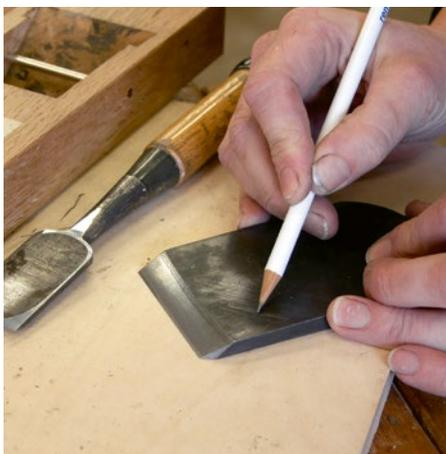
Ein weicher Bleistift färbt die Rückseite des Eisens. Das Grafit dient als Marker für die Stellen, an denen Material aus dem Bett genommen werden muss.
