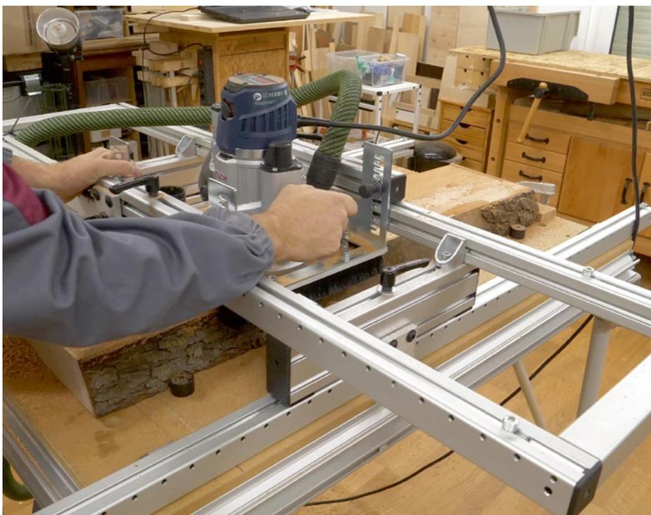
Los geht's! Der Fräser ist am „Hochpunkt“ des Werkstücks genullt und dann auf eine Spanabnahme von einem Millimeter eingestellt. Nachdem er auf die Fläche gefahren wurde, geht es in geraden Bahnen die Bohle entlang. Dazu wird die kurze X-Achse fixiert. Am Ende: lösen, Aggregat verschieben, erneut fixieren und zurück. Danach wird der Prozess mit etwas tieferem Fräser wiederholt, bis das Brett plan ist.
