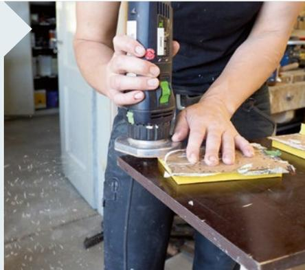
**19** | Nach weiteren zwei Tagen des Trocknens können Furnier und Messing bündig gefräst werden. Das dünne Blech ist für einen Schaftfräser kein Problem.
