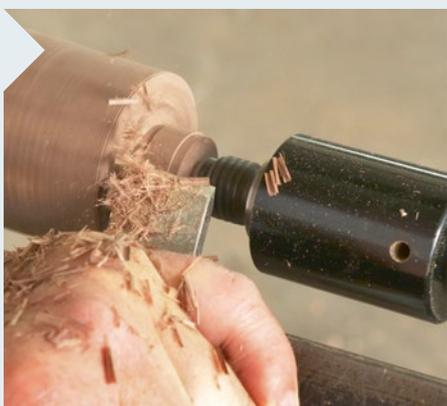
**15** | Legen Sie auf der freien Seite den Zapfen zum Verkleben auf etwas unter 25 mm Durchmesser an. Sitzt der Zapfen zu stramm, wird der Leim später verdrängt. Die Länge des Zapfens: 14 mm plus die Tellerdicke.
