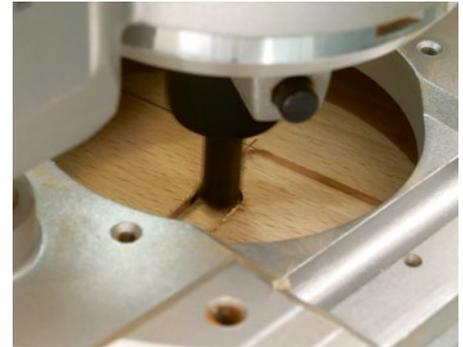
Durchgang für Durchgang arbeitet sich die Fräse immer weiter hinab. Unsere Tests haben gezeigt: Das Fräsen von Taschen funktioniert so gut und maßhaltig. Wer aber mit voller Kraft gegen die Endpunkte rammt, verlangt zu viel von der Alukonstruktion der SlabMatrix. Dann liegt die Fräskante auch schon mal einen halben Millimeter neben dem Strich.
