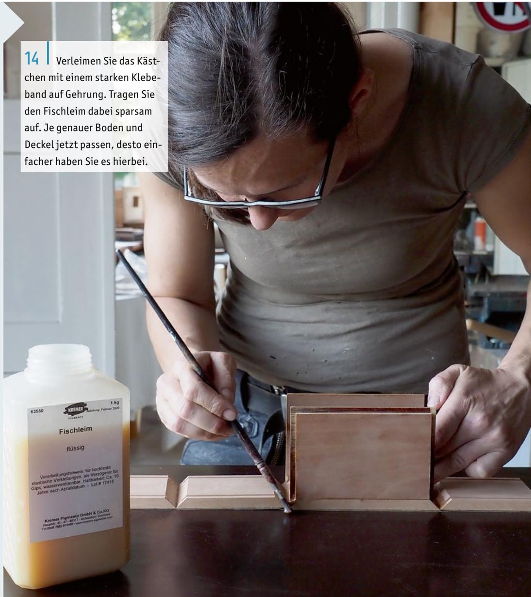
**14** | Verleimen Sie das Kästchen mit einem starken Klebeband auf Gehung. Tragen Sie den Fischleim dabei sparsam auf. Je genauer Boden und Deckel jetzt passen, desto einfacher haben Sie es hierbei.
