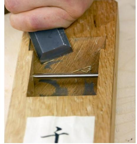
Entfernen Sie diese Erhöhungen mit einem scharfen Stechbeitel. Diesen Vorgang des Markierens und behutsamen Entfernens wiederholen Sie, bis das Eisen bis zu Hobelsohle eingetrieben werden kann.
