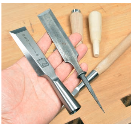
Der Unterschied zwischen Tülle (links) und Angel: Bei der Tülle wird das Holz-Heft außen von Stahl umschlossen. Bei der Angel umgibt das Holz den Stahl.
