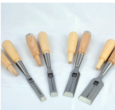
Die Form des Griffs (Heft) vorne entspricht genau dem Innenkonus der Tülle und hält so formschlüssig. MHG liefert pro Eisen zwei Hefte. Mit Zwingen zum Stemmen und ohne für leichte Arbeiten ohne Hammer.
