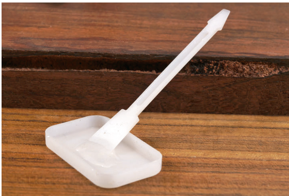
Zwei Tuben, zwei gleich lange Stränge und dann kräftig mischen: Nur wenn die Epoxid-Zutaten Harz und Härter in gleichen Teilen zusammenkommen, können sie ihre volle Mischung entfalten.
