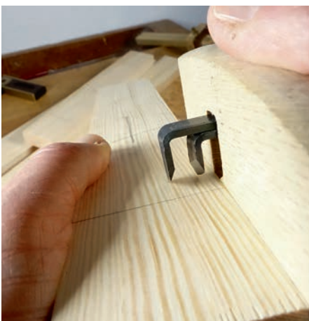
Die Messer ragen unterschiedlich lang heraus. Das verhindert den gleichzeitigen Einsatz.
