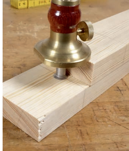
Die Werkstückdicke lässt sich bei dieser Bauart einfach abnehmen.
