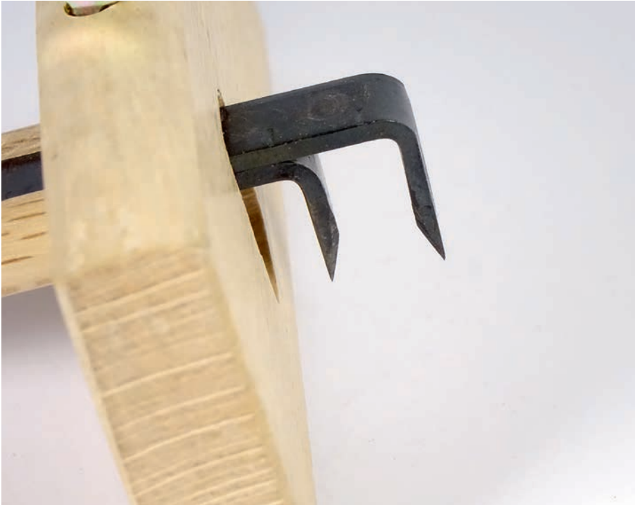
Die Messer sind wechselseitig angeschliffen, sie weisen so zum Zapfenloch.
