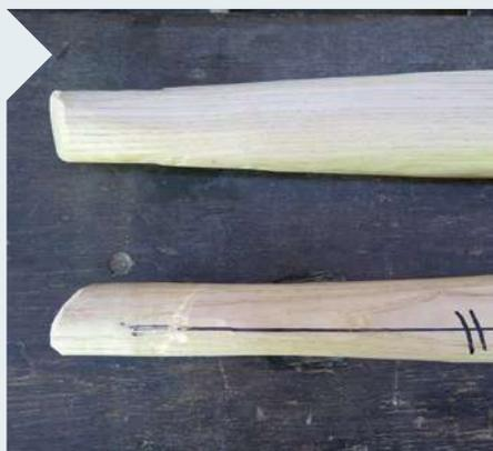
**13** | So sollen die Zapfen in Seiten- und Vorderansicht aussehen. Der Konus greift beim Einschlagen der Beine nur ins Längsholz des Sitzes, das reichlich Kraft aufnehmen kann. Schwinden die Zapfen, kann nachgeschlagen werden, bis sie wieder festsitzen.
