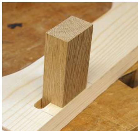
Die Nutklötze bewegen sich mit der Platte, wenn das Holz der Platte mit wechselnder Luftfeuchtigkeit arbeitet. Deshalb müssen die Nuten, die quer zur Maserung der Platte laufen, länger sein als der Klotz breit ist.
