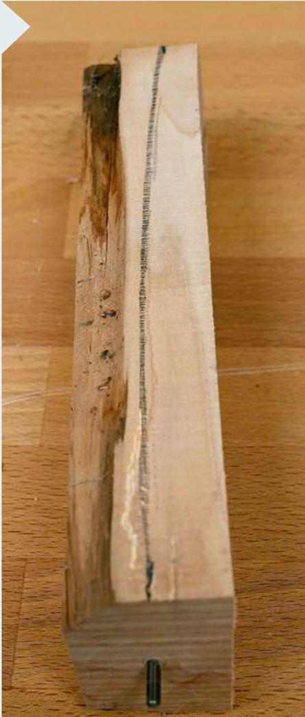
**3** Wo ist das Loch? Lassen Sie den Bohrer im Holz und skizzieren Sie seinen Verlauf auf dem Holz. Tragen sie auf beiden Seiten einen Zentimeter von dieser Linie ab. Hierbei müssen sie nicht zu genau vorgehen; die Feinarbeit für den Stiel kommt erst später.
