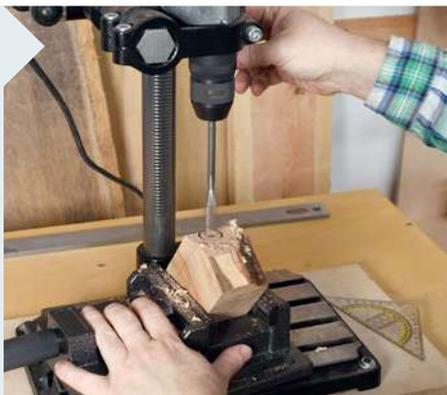
**11** | Die folgt nämlich jetzt: Die geraden Kanten des Rohlings und die eingezeichneten Achsen machen ein exaktes, gerades Ausrichten auf der Ständerbohrmaschine möglich. Ein Forstner-, Kunst- oder Flachfräsbohrer schafft so eine exakt plane Fläche.
