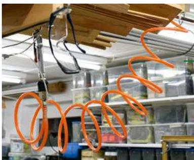
**Druckluftanschlüsse** für den Betrieb von Exzentrerschleifer, Druckluftnagler, Stabschleifer und einem Schrauber sind in den meisten Holzwerkstätten eine Seltenheit. Rainer Voges schwört darauf und hat gleich drei Anschluss-Stellen installiert: „Der Betrieb von Geräten ohne Elektromotor ist einfach **leiser und vibrationsärmer**.“ Der Krach des Kompressors stört auch nicht – der steht mehrere Kellerräume weiter und schickt die Luft über Kupferrohre in die Werkstatt.
