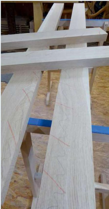
**1** Besäumen Sie eine 50 mm starke Eichenbohle, trennen Sie sie in der Mitte auf und längen Sie sie grob ab. Richten Sie die vier Einzelteile (Pos. 1 und 2) ab und hobeln Sie sie auf 110 x 40 mm. Kennzeichnen Sie die Stellen, an denen der Falz ausgesägt wird.
