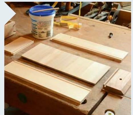
**11** Prüfen Sie vor dem Verleimen jeder Schublade trocken, ob alles passt. Ist der Leim erst einmal aufgetragen, sind Korrekturen nur noch unter Zeitdruck möglich.
