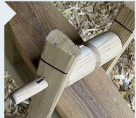
**20** Reißen Sie 4 cm über dem durchgesteckten Zapfen des Kopfstücks die endgültigen Armlängen an. Markieren Sie außerdem die Position der Keilschlitze im Kopfstück und im Fußpedal.
