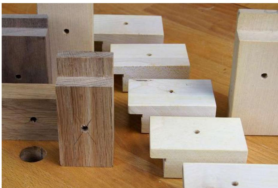
Die Größe der Nutklötze fällt je nach Anwendungsbereich unterschiedlich aus. Sie sind längliche Leistenabschnitte mit einem Falz an einem Ende. Eine durchgehende Bohrung in der Mitte dient der Befestigung mit einer kräftigen Schraube.
