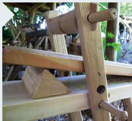
**22** Der große Keil liegt lose unterm Werkstisch, damit er zur Höhenverstellung bewegt werden kann. Der Tisch ist vorne verschlankt und hinten mit zwei Halteleisten und einem Lederstreifen als Scharnier mit der Sitzbank verschraubt.
