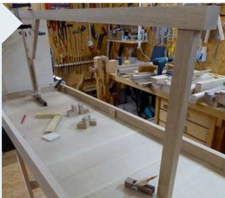
**15** | ...wie viel Sie unterlegen müssen, damit die senkrechte Strebe im 90°-Winkel an der Hilfsplatte anliegt. Zeichnen Sie an der oberen Strebe mit einer „Bleistiftmaus“ (ein schneller Eigenbau) die Höhe des Stapels an. Kürzen Sie die obere Strebe im 87°-Winkel.
