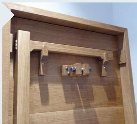
**20** | Bei Nichtgebrauch ist das Gestell an vier Punkten auf der Rückwand fixiert. Oben mit zwei Haken, die links und rechts die Kleiderstange gegen die Rückwand drücken. Stellen Sie diese gemäß der Zeichnung her.
