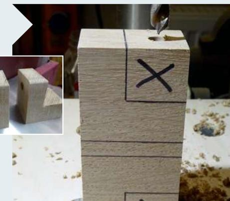
**13** | Zu den Holzwinkeln: Ein Klotz gibt je zwei Winkel, die erst nach dem Bohren geteilt und in Form gebracht werden. Damit der Bolzen später gut durchgeht, bohren Sie erst (d= 10) so tief wie möglich in den Klotz. Die Bandsäge trennt die Klötze. Bohren Sie den zweiten Winkel nun durch.
