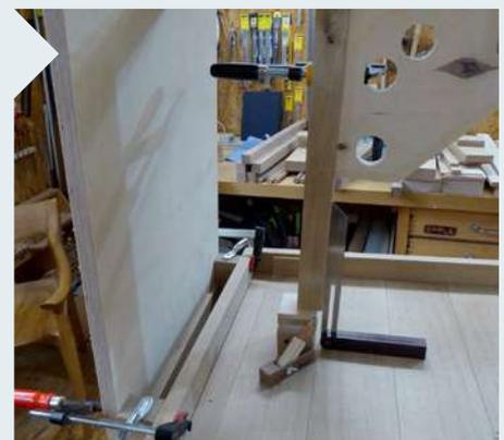
**14** | Nun zur Montage: Das erst nur gesteckte Gestänge soll mit einem Zentimeter Luft ringsum auf der Rückwand liegen. Zwingen Sie dann eine Platte an die Spiegelfüße (die Platte ist dann um 3° geneigt). Eine Schmiege auf 87° neben der unteren Strebe zeigt...
