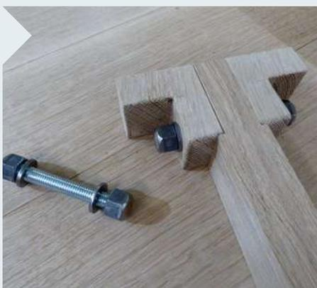
**17** | Die entstehende Schulter des Zapfens soll auf der Oberkante des Winkels aufliegen. Verwenden Sie einen der Winkel als Bohrschablone (unbedingt festspannen) und bohren Sie durch das vorhandene Loch (10 mm Bohrer) durch den Zapfen.
