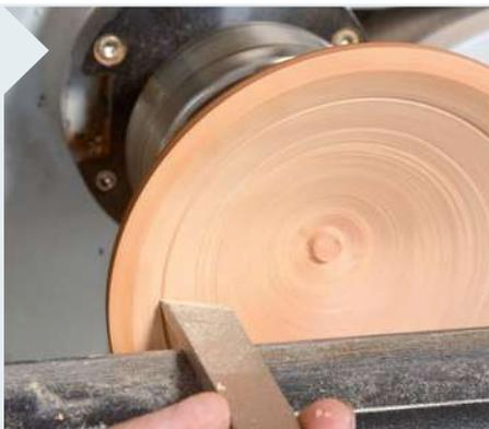
**12** | Um den Deckel von oben zu bearbeiten, nutzen Sie die Schale als Klemmfutter. Legen Sie ihn ein und zeichnen Sie einmal herum. Tasten Sie sich dann mit dem Meißel von innen bis fast an den Strich heran, bis sich der Deckel stramm klemmen lässt
