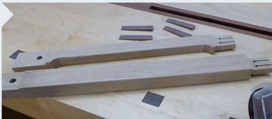
**18** | Formen Sie die obere Strebe (Pos. 8) an der Bandsäge. Für die Keilsicherung bohren Sie zwei 4-mm-Löcher in den Zapfen, der in die senkrechte Strebe kommt. Sägen Sie den Zapfen bis zum Bohrloch auf und fertigen Sie vier Keile an. Schleifen Sie das Gestell.
