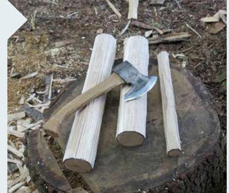
**3** Der bewegliche Rahmen trägt quer (von oben nach unten) Kopfstück, Achse und Fußpedal. Diese Teile werden später gedrechselt. Das Schnitzbeil kann die Teile schon weitgehend rund zurichten.
