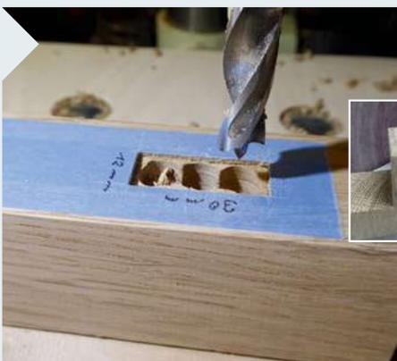
**12** | Erledigen Sie als erstes die Stemmarbeiten für die beiden Zapfenverbindungen. Wenn Sie von beiden Seiten etwa 2 mm tief vorstemmen, erhalten Sie eine saubere Kante am Stemmloch. Dann können Sie mit der Ständerbohrmaschine durchbohren.
