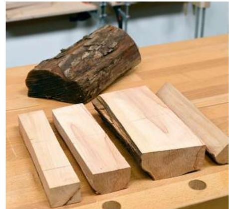
1 | Brennholzscheite bieten in der Regel genug Holz für dieses Projekt. Schneiden Sie großzügig verwitterte und gerissene Stellen heraus; das Holz muss absolut perfekt sein, um bei der späteren Hitzeentwicklung nicht zu reißen.
