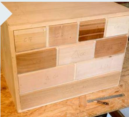
**9** Setzen Sie jedes Frontstück probeweise ein. Anschließend fräsen Sie die Falze für die Eckverbindungen in Front- und Seitenteile.
