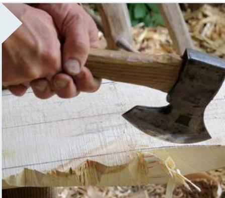
**9** | Nun zur Sitzbohle, die Sie zunächst anreißen. Quer zur Faser vorkerben), dann lässt sich die Verjüngung gut mit dem Schnitzbeil anschlagen. Fürs Bohren der Zapfenlöcher für die Beine legen Sie ein 60 cm langes Hilfsbrett mittig unter die Bohle und...
