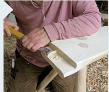
**17** Am Ende der Sitzbank arbeiten Sie einen Falz von 30 x 50 mm an. Diese Anschlagkante macht das Hobelpferd auch zu einem effektiven Sägebock, wenn mal ein Stück Holz abgelängt werden soll.
