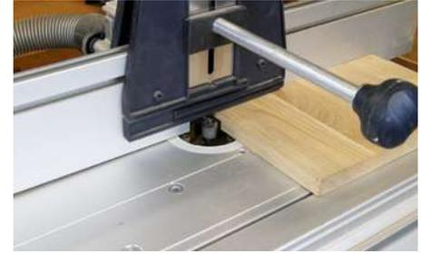
Alternativ macht der Frästisch mit Anschlag und der großen Auflagefläche das Anfräsen des Falzes zu einer einfachen Sache. Durch die Schutzvorrichtungen und mit einer angemessenen Frästiefe ist sicheres Arbeiten gegeben.
