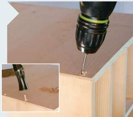
**7** Zur Stabilisierung der Überfaltungen der Außenteile können Sie Holznägel platzieren.
