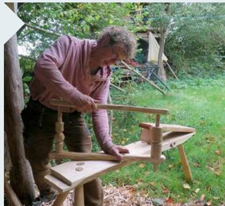
**19** Stecken Sie die Arme mit Kopfstück, Achse und Fußpedal zusammen. Das Kopfstück und das Fußpedal erhalten außen durchgestemmte Keile, die den Rahmen zusammenhalten.
