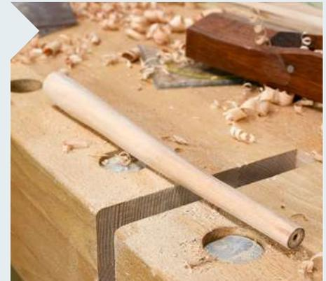
**7** Der Stiel darf jetzt noch rau sein und muss auch noch nicht perfekt rund werden. Er wird später noch an den Pfeifenkopf angepasst. Vor dem Dampfbiegen kommt jetzt noch ein 4-mm-Messingstab in das Loch, damit sich dieses beim Biegen nicht wieder schließt.
