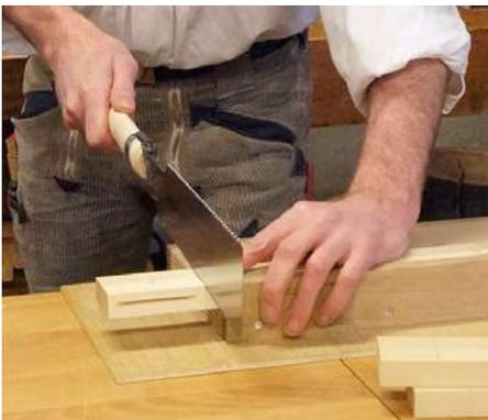
Nach dem Bohren der Schraubenlöcher an der Ständerbohrmaschine sägen Sie die Leiste in die entsprechenden Längen. Diese Klötze liegen parallel zur Zarge. Natürlich kann dafür auch eine Stich- oder Bandsäge verwendet werden.
