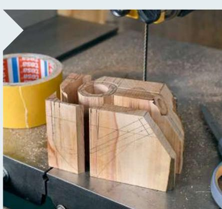
**15** | Schneiden Sie alles an der Bandsäge aus. Für eine gerade Auflagefläche beim zweiten Sägevorgang müssen Sie die ausgesägte Teile wieder ankleben. Sägen Sie beim Übergang zwischen Stielansatz und Kopf nicht zu tief.
