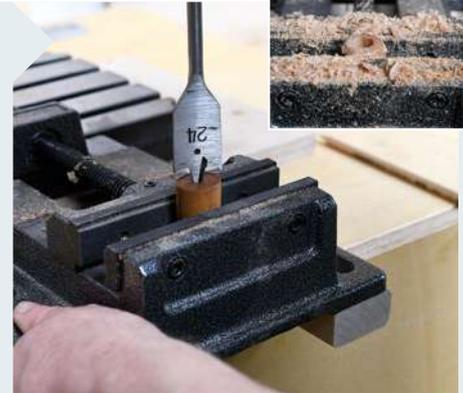
**18** Auch hier entsteht eine plane Fläche mit senkrechtem 10-mm-Dübelloch für die Steckverbindung, 21 mm tief (siehe dazu Kasten). Wenn Sie einen Filter einsetzen möchten und das Material die Tiefe hergibt, bohren Sie noch ein 40 mm tiefes 9,5-mm-Loch für den Filter.
