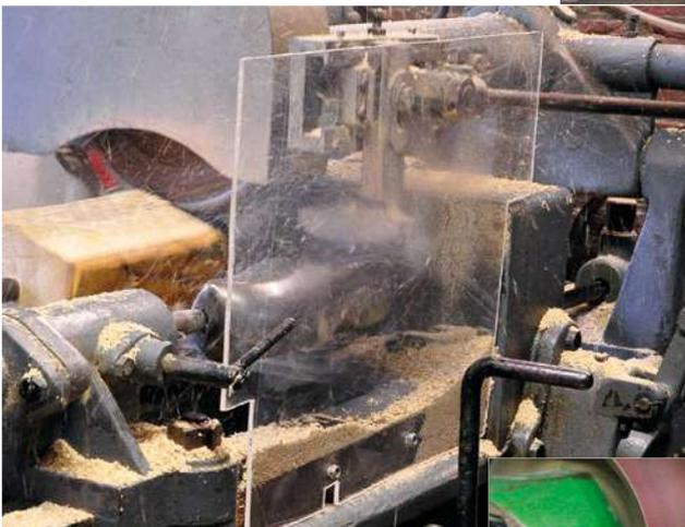
Ein Eisenschuh dient als Führung: Wohl schon tausende Male ist er in der Vergangenheit von einem Fühler abgetastet worden, der die Konturen dann an das Fräsblatt weitergibt. So entsteht eine in verschiedenen Schuhgrößen skalierbare Kopie.
