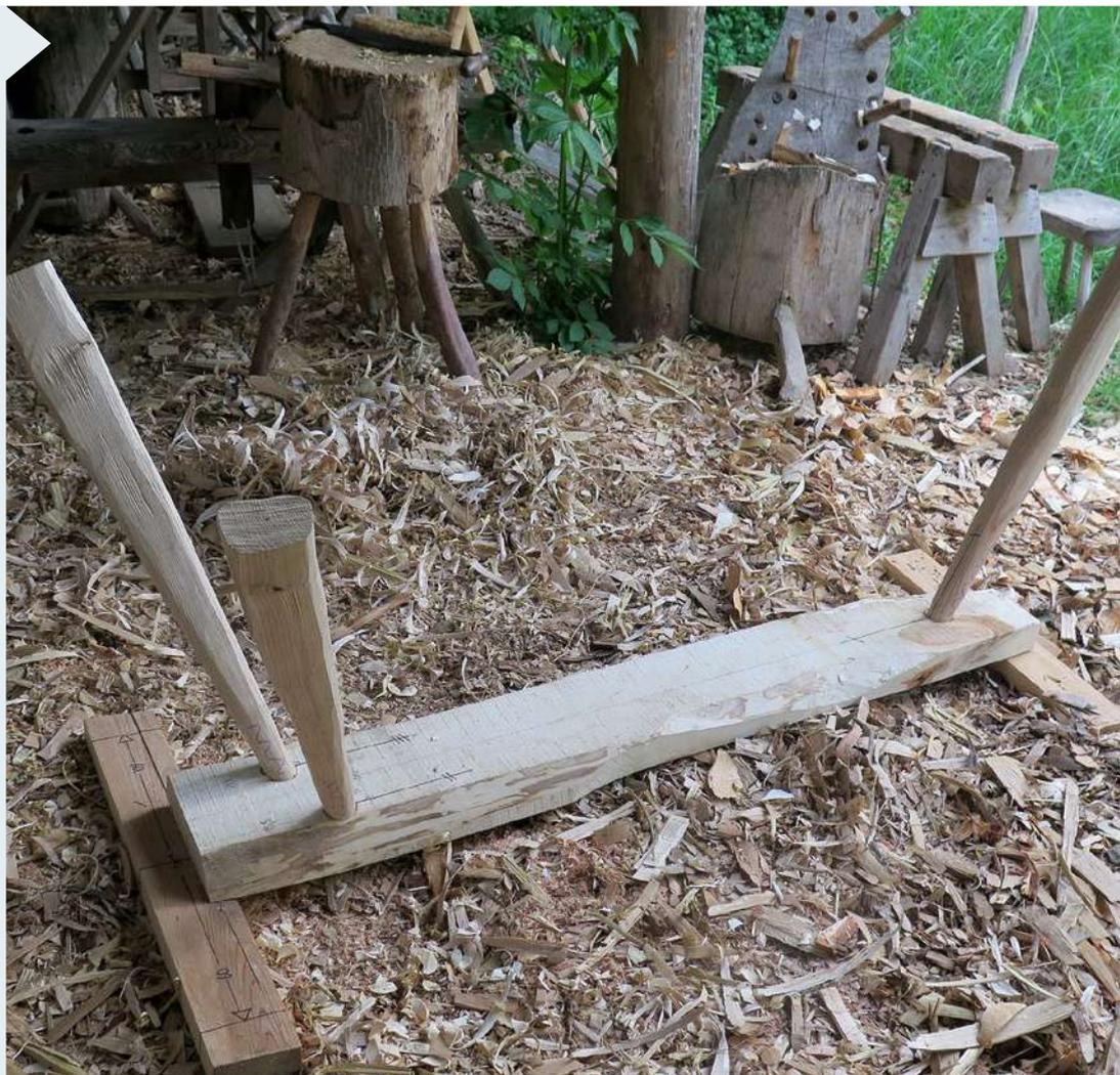
**11** | Nach dem Bohren stecken Sie die Beine probeweise ein. Da sie nicht schnurgerade sind, können Sie die Winkel noch durch Drehen der Beine korrigieren. Das Vorderbein sollte ungefähr 10 cm über das Bank-Ende hinausragen.
