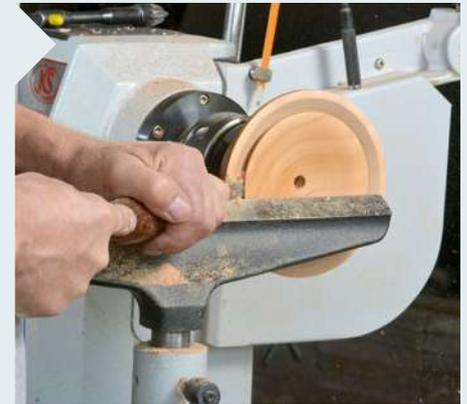
**10** Fester Stand, sicherer Griff und eine auf knapp 700 U/min verminderte Drehzahl: So arbeitet sich der Abstecher immer tiefer vor, um den Deckel zu lösen. Holen Sie immer wieder die Späne aus der tiefen Nut. Arbeiten Sie ruhig und mit geringem Druck.
