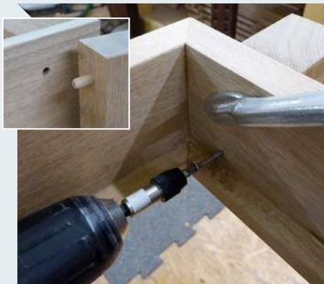
**10** | Bringen Sie den Fuß um die Materialstärke (40 mm) nach innen versetzt an. Achtung, das Dübelloch in den Rahmen nicht durchbohren! Unsichtbar – da dort später der Spiegel sitzt – schrauben Sie eine Schraube (4,5 x 50) durch den Rahmen in den Möbelfuß.
