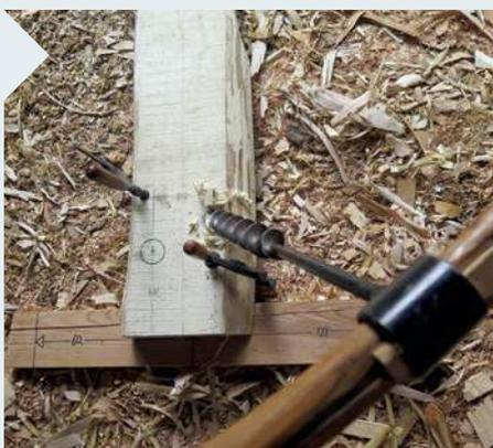
**10** | ...bohren sie dann von der Unterseite. Da der Schlangenbohrer so lang wie ein Bein ist, können Sie sein Ende senkrecht über die Ecke des Hilfsbretts bringen, und es passt. Das Foto ist genau aus dieser lotrechten Position aufgenommen.
