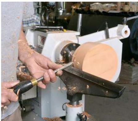
**1** Nehmen Sie den grob rundgeschnittenen Rohling auf einem Schraubfutter auf und drehen Sie ihn zylindrisch rund. Die Unterseite wird plan ausgearbeitet und bekommt einen Rezzess (also eine Vertiefung mit schräger Wandung) zur Aufnahme im Spannfutter.
