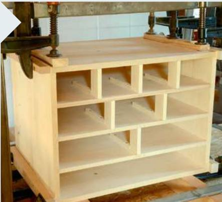
**6** Der Korpus wird mit Zulagen verleimt. (Tipp: Sie können auch in zwei Öffnungen genau zugeschnittene Platten einstellen, um alles rechtwinklig zu verleimen. Deren Ecken sollten diagonal abgeschnitten sein, um sie leichter einzusetzen. Ihre Kanten werden abgeklebt.)
