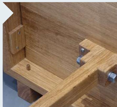
**21** | Unten wird der Fuß mit einem 8-mm-Holzdübel gesichert, der im Rahmen sitzt. In den Garderobenfuß ist ein passendes 10-mm-Loch gebohrt. Die untere Querstrebe hält noch ein kleines Klötzchen. Das Garderobengestell kann nach oben herausgezogen werden.
