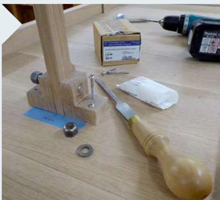
**19** | Achten Sie beim Verleimen der drei Streben auf den 90°-Winkel. Ist der Leim trocken, richten Sie die Streben mittig an der Rückwand aus. Schrauben Sie erst einen Winkel fest (vorbohren), schieben Sie den Bolzen durch Winkel und Querstrebe in das Loch des zweiten Winkels.
