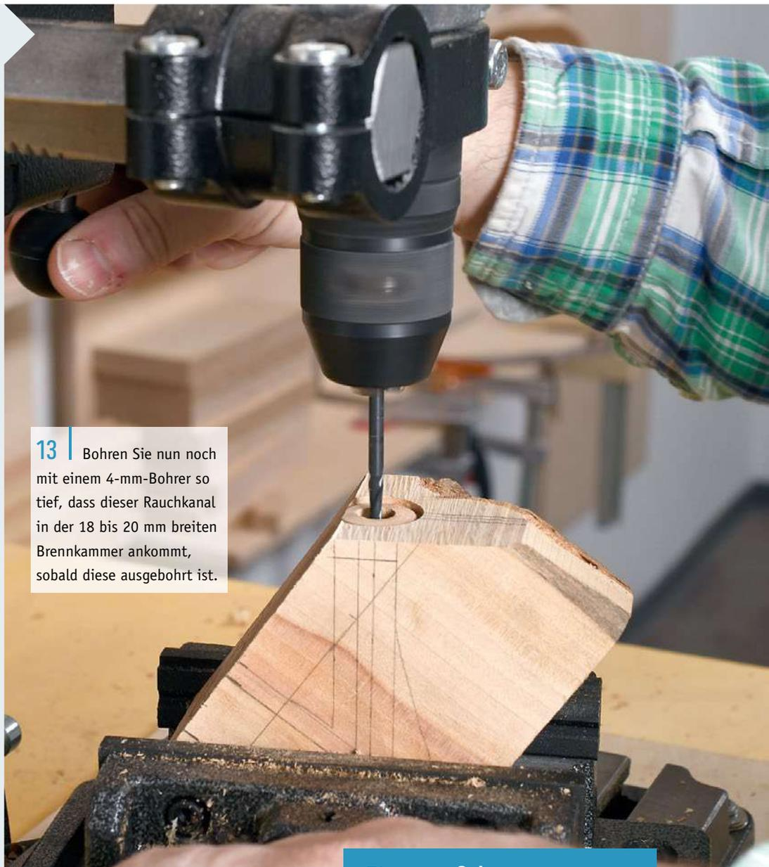
**13** | Bohren Sie nun noch mit einem 4-mm-Bohrer so tief, dass dieser Rauchkanal in der 18 bis 20 mm breiten Brennkammer ankommt, sobald diese ausgebohrt ist.
