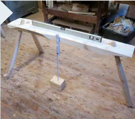
**15** Die Beine sind auf Spannung eingeschlagen, und das Pferd wird mit Keilen auf einem ebenen Grund per Wasserwaage horizontal ausgerichtet.
