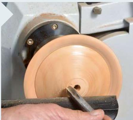
**13** | Gestalten Sie nun zunächst den Schalenrand bis zum Falz. Dann ist der Deckel an der Reihe: Die ehemalige Schraubenbohrung öffnet sich; arbeiten Sie dann mit der Röhre von innen nach außen. Nehmen Sie am schon dünnen Deckelrand aber fast nichts mehr ab!
