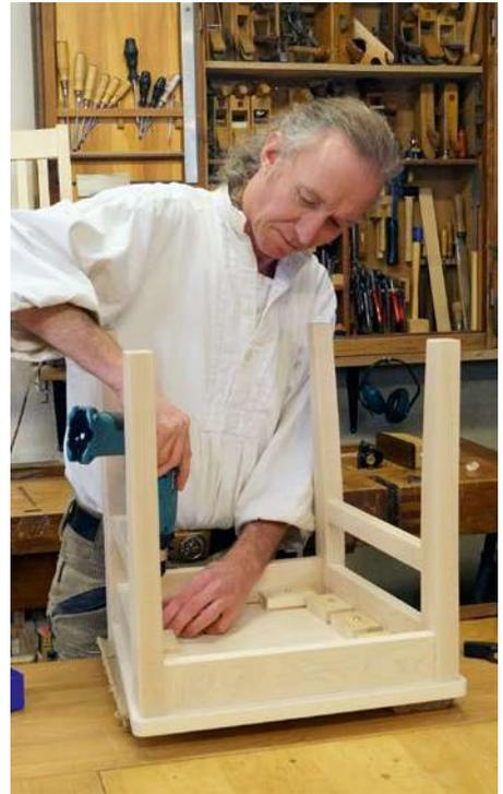
Egal, für welche Variante Sie sich entschieden haben, am Ende steht die Montage. Positionieren Sie Platte und Zarge zueinander und verteilen Sie die Klötze gleichmäßig. Schrauben Sie die Nutklötze mit den Rundkopfschrauben an die Platte.
