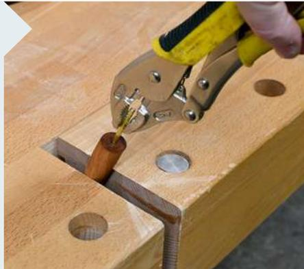
**17** Jetzt sollte auch der Stiel so weit sein. Den Messingstab zu entfernen bedarf Einiges an Kraft.
