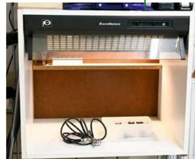
Lackieren in der Holzwerkstatt? Für viele ein Albtraum: Sprühnebel und „Overspray“ sind wie gemacht dafür, den Lack im ganzen Raum zu verteilen. In dieser Werkstatt gibt es eine Lösung dafür: Der **Lackierkasten ist mit einer Küchen-Abzugshaube** ausgestattet. Dessen Ventilationsöffnung wird bei Gebrauch mit einem **feuchten Tuch** bedeckt, das jedes verirrte Lack-Aerosol an sich bindet. So kann lackiert werden, ohne vorher alles abdecken zu müssen.
