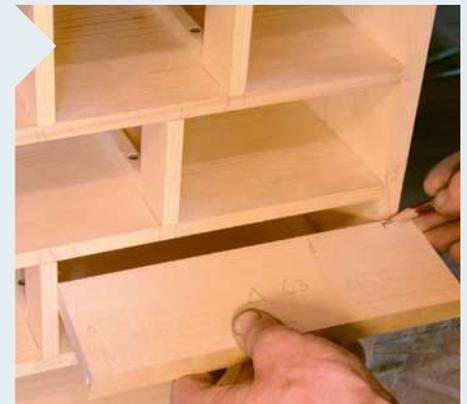
**8** Nun zu den Schubkästen: Die Frontstücke werden mit Nuten für den Boden versehen und erst dann am verleimten Korpus angerissen und abgelängt. Sie können die hintere, obere Kante der Frontstücke noch anfasen: So greift es sich angenehmer.
