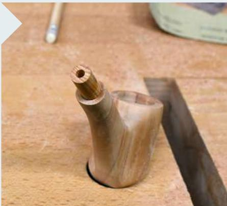
**19** Fertigen Sie einen 40 mm langen 10-mm-Dübel als Steckverbindung und versehen Sie ihn mit einer mittigen 4-mm-Bohrung. So einen Querschnitt können Sie im Futter einer Bohrmaschine „dreheln“, indem Sie darin eine Leiste mit grobem Schleifpapier (K80) runden.
