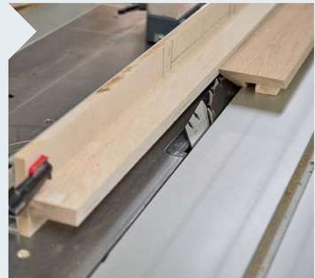
**3** So gelingt die Schweizer Kante: Zwingen Sie am Parallelanschlag einen Winkelschlag so fest, dass die obere Kante des Werkstückes anliegt. Den Falz gleicht ein Reststück (15 mm) aus, sodass das Werkstück sicher aufliegt. Stellen Sie das Sägeblatt auf 45°.
