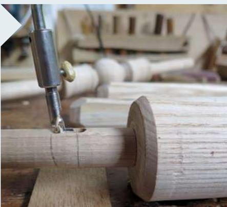
**21** Bohren Sie für diese Schlitze mit 8 mm vor und arbeiten Sie die Langlöcher dann aus. Aus einigen Resten des gespaltenen Holzes fertigen Sie vier Keile.
