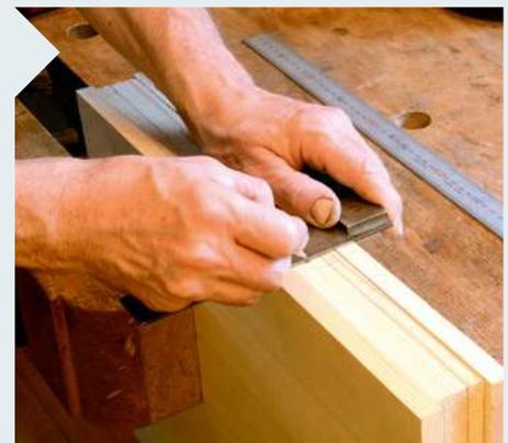
2 Boden, Zwischenböden und Deckel werden zusammengespannt und die Position der Unterteilungen immer auf zwei Bauteilen gleichzeitig angerissen. So stellen Sie sicher, dass die Nuten für die Unterteilungen oben und unten jeweils exakt gleich liegen.
