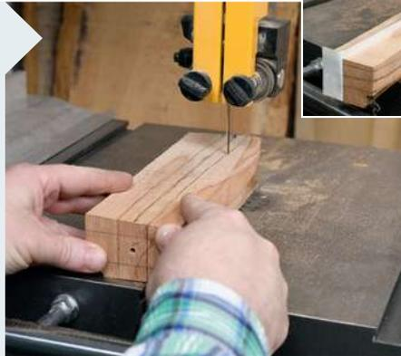
**4** Sägen Sie den Stiel grob mit der Bandsäge aus. Damit Ihre Markierungen nicht verloren gehen, müssen Sie den Rohling nach dem ersten Sägen wieder mit doppelseitigen Klebeband zusammenkleben.
