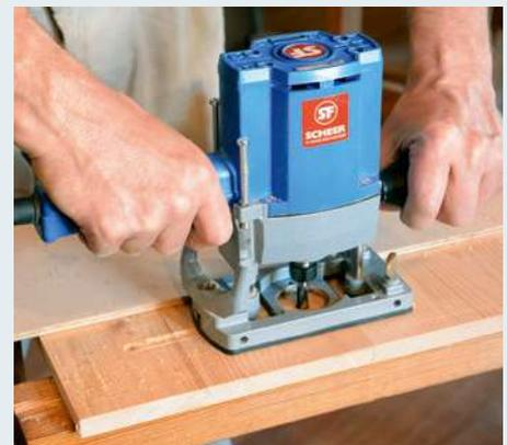
1 Die Seiten werden für die Aufnahme der Zwischenböden genutzt. Diese Nut hat nur eine Tiefe von 2 mm bei 300 mm Länge und 10mm Breite. Sie beginnt erst 20 mm hinter der vorderen Plattenkante.
