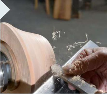
**6** Variante 2: Der halbrunde Schaber fährt ganz leicht hängend (Spitze liegt tiefer als das Heft) die Kontur ab. Danach ist die Außenform bereit zum Schleifen bis Körnung 320. Drehen Sie die Schale dann im Futter um und drehseln Sie sie plan.
