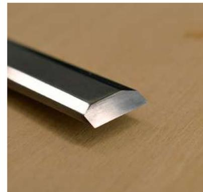
Schnell wieder einsatzbereit: Das System schärft Standard-Anschliffe schnell – aber eben auch nur die.
