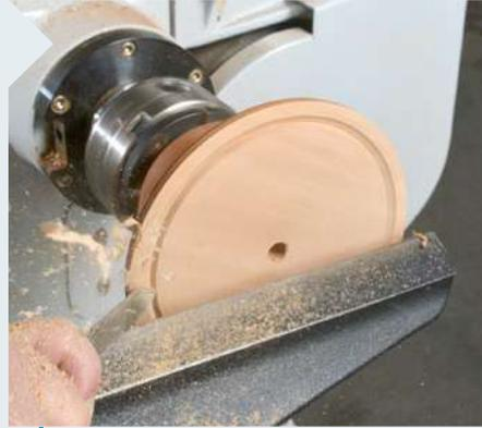
**7** Der Abstecher dringt nun nah am Rand in einem spitzen Winkel 3 cm tief ins Holz. Zielen Sie mit dem Werkzeug auf die Mitte der Schalenhöhe. Schwenken Sie das Heft leicht nach links und rechts, damit sich das Eisen tief im Holz etwas freischneidet.
