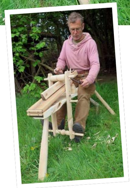
Als Material braucht man eine Stammrolle aus frischem, astreinem Hartholz von einem Meter Länge und 20 bis 30 cm Durchmesser. Daraus werden die Beine und der Spannrahmen gefertigt. Hier wurde Edelkastanie verwendet, aber es gehen auch andere Holzarten. Gut geeignet sind Buche, Eiche, Esche, Robinie. Nicht geeignet sind zähe Hölzer wie Ulme, Apfel und Hainbuche. Wenn kein Förster zur
