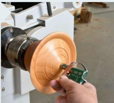
**15** | Genialer Trick: Um den klemmenden Deckel völlig spurlos abzubekommen, reicht ein kleiner Druckluftstoß über Kompressor und Pistole. Mit einem leisen Plopp ist die Verbindung gelöst.
