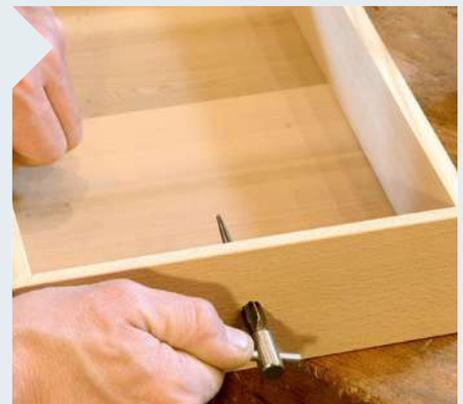
**17** | Falls Sie Saitenhalterknöpfe aus dem Instrumentenbau für die Schubkästen verwenden, müssen Sie das Loch mit einer Reibahle etwas konisch aufreiben. Die Schäfte der Knöpfe sind nämlich leicht zulaufend.
