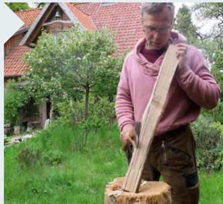
**5** Während die Drechselteile trocknen, können die Beine und die Arme des Spannrähmens geformt werden. Arbeiten Sie so weit wie möglich mit dem Beil an die Endform heran.
