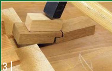
3 | Ein beherzter Schlag mit dem Hammer trennt die beiden Stücke. Ein Schlagholz schützt die Nutklötze vor Beschädigungen. Bei ruhig gewachsenem Holz bricht der Klotz relativ gerade entlang der Fasern.
