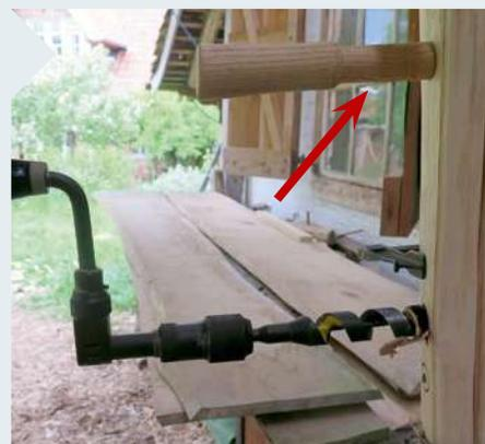
**14** | Spannen Sie die beiden Arme aufrecht hintereinander und bohren Sie sie gemeinsam. Ist die erste Bohrung fertig, wird ein Peilstab eingesteckt (hier oben). Er macht es möglich, die nächsten Bohrungen parallel zu ihm auszurichten.
