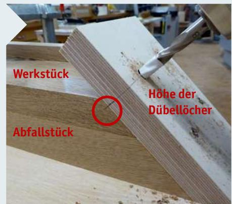
**5** Schrauben Sie das gebohrte Brett auf ein Abfallstück des Rahmens. Stecken Sie anschließend den Rahmen zusammen. Passen alle Teile, wird der Rahmen verleimt. Schneiden Sie dann die Rückwand mit etwas Überstand zu.
