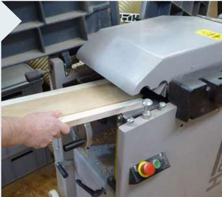
**6** | Schneiden Sie das Furnier an der Bandsäge 5 mm stark ab. Mit der Materialstärke von 4 mm sind Sie vermutlich im Grenzbereich ihrer Hobelmaschine. Nehmen Sie ein planes Brett zu Hilfe und schicken Sie das Brett zusammen mit dem Sägefurnier durch die Maschine.
