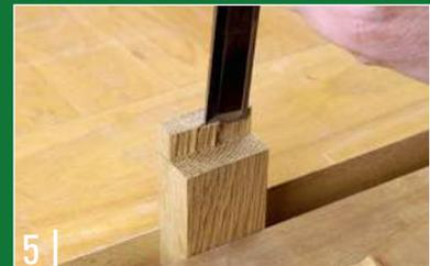
5 | Der Streichmaßriss bietet auch dem scharfen Stecheisen die nötige Führung. Dünne Späne lassen sich entlang der Fasern, nur mit dem Druck des Handballens, leicht abstechen.
