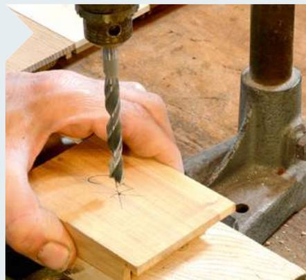
**10** Bohren Sie die Frontstücke für die spätere Aufnahme eines Knaufs oder legen sie alternativ einen halbrunden Griff-Ausschnitt am oberen Rand an.
