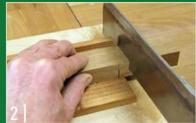
2 | Winklig zur Längskante wird die Leiste senkrecht bis zum unteren Streichmaßriss eingesägt. Nur einige kurze, am besten gerade gewachsene Fasern halten die beiden Nutklötze noch zusammen.
