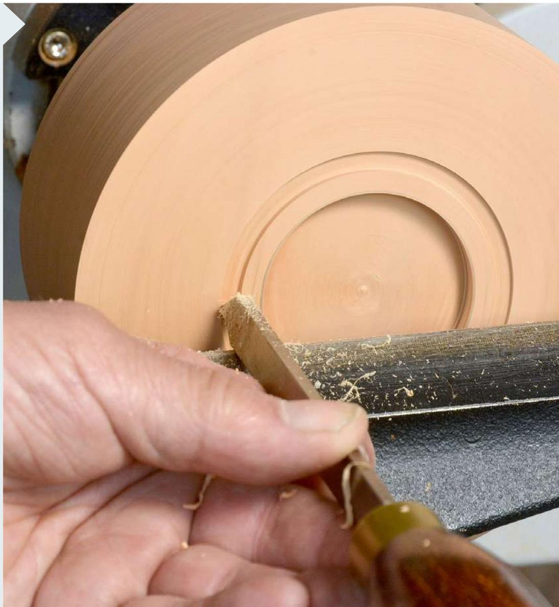
**3** 6 mm vom Rezzessrand kommt der Abstecher 3 mm tief ins Holz. Mit einer 13-mm-Schalentröhre flachen Sie die Schalenunterseite nun nach außen hin bis auf Nuttiefe ab; rechtwinklig zur Drehachse.
