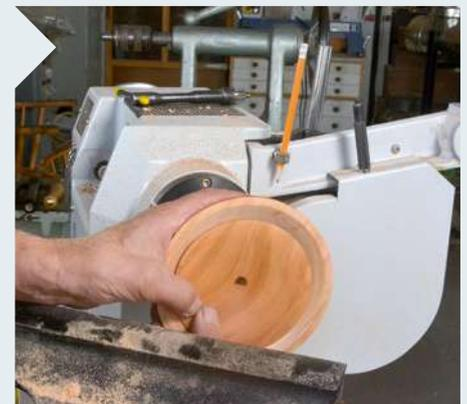
**11** Wenn Sie nah genug am Zentrum sind, halten Sie die Maschine an. Mit gefühlvollem Hin- und Herbewegen der Daumen sollte sich der Deckel aus dem Schalenrohling lösen lassen. Wenn nicht: Noch ein bisschen tiefer vordringen.
