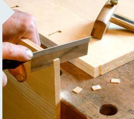
**4** Klinken Sie die Zwischenböden und Unterteilungen vorne mit einer Feinsäge vorsichtig 20 mm mit einer Tiefe von 2 mm aus. So liegen sie in den Nuten der Seiten und Zwischenböden, schließen aber vorne bündig ab.
