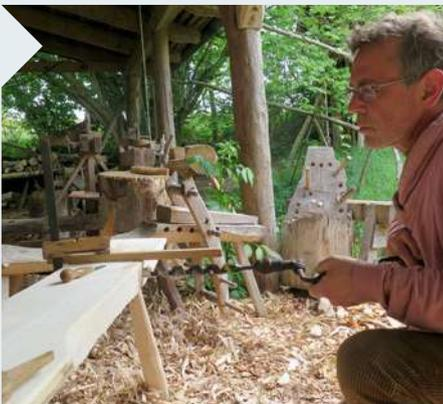
**18** Die Bankoberfläche wird dann mit Hobel und Ziehmesser geputzt. Zum Schluss müssen Sie noch einmal dicke Bretter bohren: Spannen Sie für die zwei Achslöcher eine Leiste auf, die als Peilhilfe dient.
