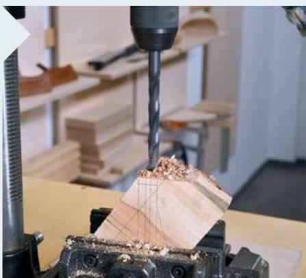
**12** | Wichtig: Verändern Sie jetzt nichts, wechseln Sie nur den Bohrer. Ein 10-mm-Bohrer schafft nun senkrecht zur planen Fläche eine 21 mm tiefe Bohrung für das Verbindungsstück zwischen Stiel und Kopf. So schaffen Sie eine spiel- und spaltfreie Verbindung.
