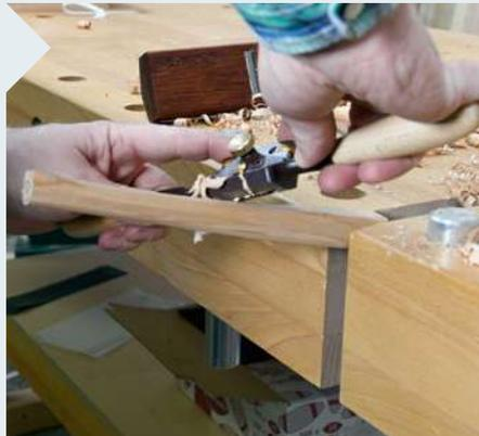
**6** Jetzt kommt die Handarbeit: Mit Raspel, Schweifhobel und grobem Schleifpapier bringen Sie den Stiel in eine konische Form - der Durchmesser beträgt auf der einen Seite 10 mm, auf der anderen 20 mm.
