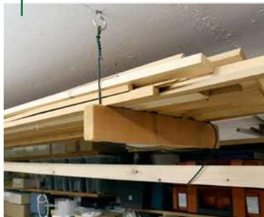
Guter Draht zum Holz: Es hängt erstaunlich viel Holz an der Decke der Werkstatt. Gehalten werden diese ganz schlicht von einem Stück **Gartendraht**. Das sieht auf den ersten Blick risikoreich aus. Die Erfahrung damit beruhigt aber schnell: Die Drähte halten die Querhölzer schon seit 30 Jahren an der Decke und haben schon so **einige Zentner** Holz getragen, ohne auch nur ansatzweise Ermüdungserscheinungen zu zeigen.
