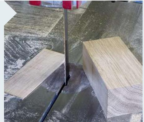
**8** | Nun sind die Füße dran: Schneiden Sie an der Oberkante der Füße einen Keil von 3° ab. Dies neigt den Spiegel leicht nach hinten und die Füße stehen trotzdem vollflächig am Boden. Bewahren Sie den abgeschnittenen Keil für den nächsten Schritt auf.
