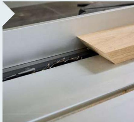
**2** Schneiden Sie den Rahmen mit einem 45°-Schnitt auf das Endmaß: 2 x 1.600 mm und 2 x 550 mm. Entfernen Sie die Schutzhaube (Stecker ziehen!) und senken Sie (falls nötig) den Spaltkeil in die Stellung für verdeckte Schnitte. Sägen Sie den Falz in zwei Schritten.
