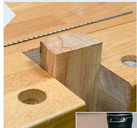
2 | Ein 30 mm langer 4-mm-Bohrer schafft das Loch im Stiel. Diese Bohrung wird nicht gerade, sondern folgt der Holzstruktur. Wählen Sie deshalb ein breites Stück, bei dem der Bohrer auch mit Versatz von 1 bis 2 cm noch das gegenüberliegende Hirnholz trifft.
