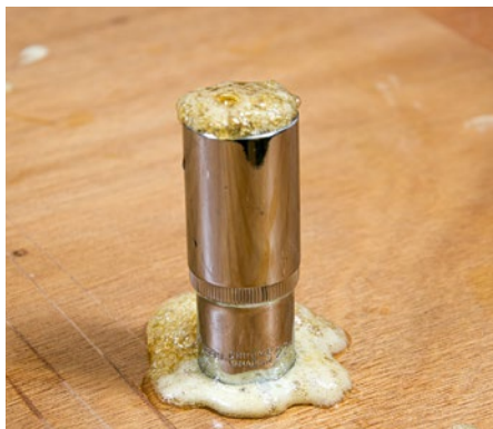
Nach einer Nacht ist der Innenraum der langen Stecknuss mit der Schlüsselweite 22 voll ausgefüllt.
