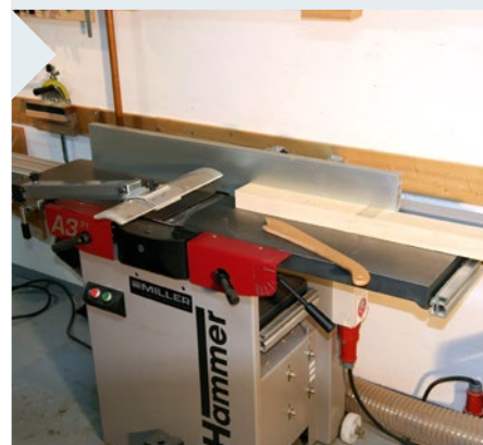
3 Damit die spätere Leimfuge der Beine und Platte nahezu unsichtbar wird, muss das Abrichten absolut eben erfolgen. Das Hobeln auf Maß erfolgt bei den Beinen erst nach der Verleimung.
