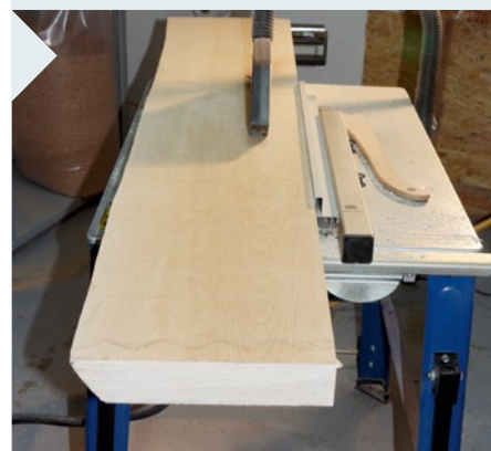
2 Der Grobzuschnitt für die Einzelteile wird auf der Tischkreissäge gemacht. Achten Sie dabei auf Spannungen im Holz, wodurch das Sägeblatt blockieren könnte.
