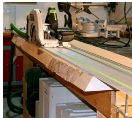
1 Das Abtrennen der Waldkante von den Bohlen erfolgt mit einer starken Handkreissäge sowie Führungsschiene.
