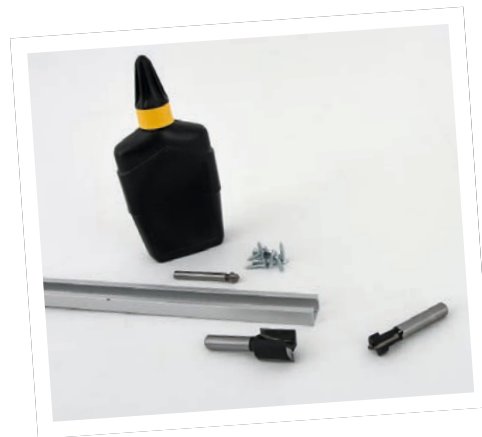
Fräser, Schrauben, Senker gegebenenfalls Kleber und natürlich die Schiene: Die Aluschiene einzubauen ist aufwändiger, als die T-Nut einfach zu fräsen.
