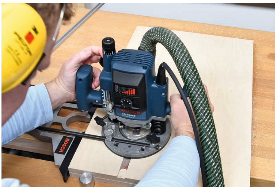
Für beide Systeme muss eine Nut in die Platte. Die 17-mm-Aufnahmenut für die Aluschiene kann in Etappen in die Tiefe gefräst werden: gut für Fräser und Maschine.
