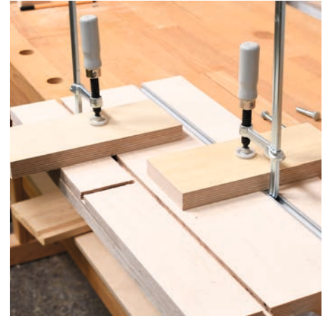
Das Standardzubehör verschiedener Hersteller passt in die Nuten, egal ob aus Alu oder Holz.
