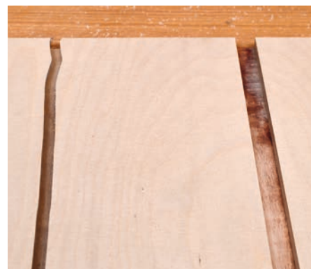
Der hohe Materialabtrag mit dem T-Nut-Fräser bringt viel Kraft auf Holz und Fräser. Ohne Führungsschiene kann es zu unschönen Wacklern kommen, selbst wie hier beim Einsatz eines Parallelanschlages.
