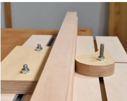
Auch selbstgebaute Spannelemente mit M8-Schrauben, zum Beispiel zum seitlichen Spannen, werden sicher gehalten. In der hölzernen Nut kann es dabei zu leichten Abdrücken kommen, die aber marginal sind.
