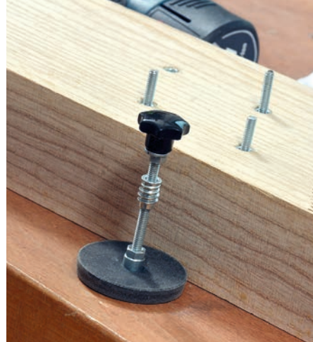
Sie werden über Drehungen der (gekonterten und geklebten) Sterngriffmuttern auf und ab bewegt. Dafür ist eine M4-Rampamuffe ins Holz eingedreht.
