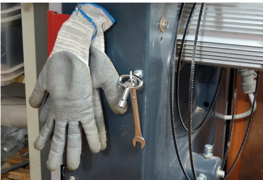
Magnethaken halten wichtige Ausrüstung direkt an der Maschine bereit. Hier an der Bandsäge sind das der Türschlüssel, ein Maulschlüssel zum Einstellen der unteren Rückenrolle und schnittfeste Handschuhe für den Bandwechsel.
