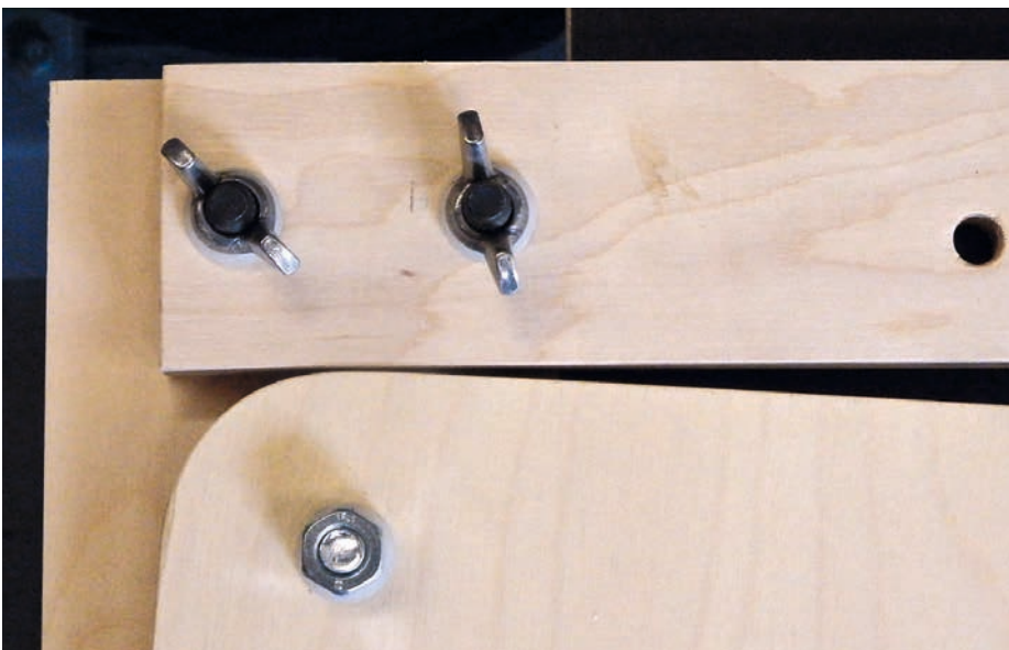
Die linke Seite der Schablone mit der abgerundeten Platte mit Drehpunkt und den beiden Flügelmuttern mit Schrauben, die den Halteklotz halten.
