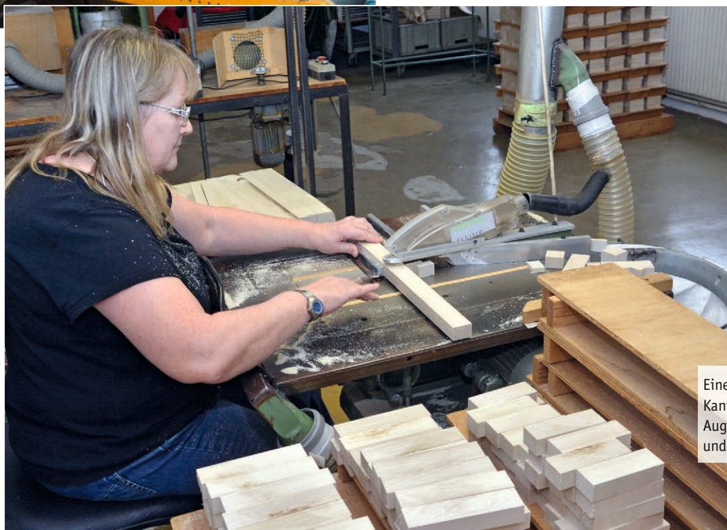
Geschäftsführer Matthias Diephaus trennt im nächsten Schritt die Bohlenstücke zu Kanteln auf. Die Maschine hat vier im Tisch versenkte Parallelanschlüge, die sich auf Knopfdruck herausfahren – je nachdem, ob und wie viele Kantelbreiten in einem Stück stecken.
