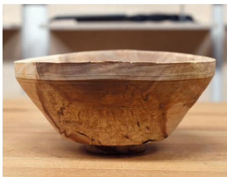
Ein krummes Ding: Die Verformung der ehemals runden Schale beim Trocknen ist deutlich erkennbar.
