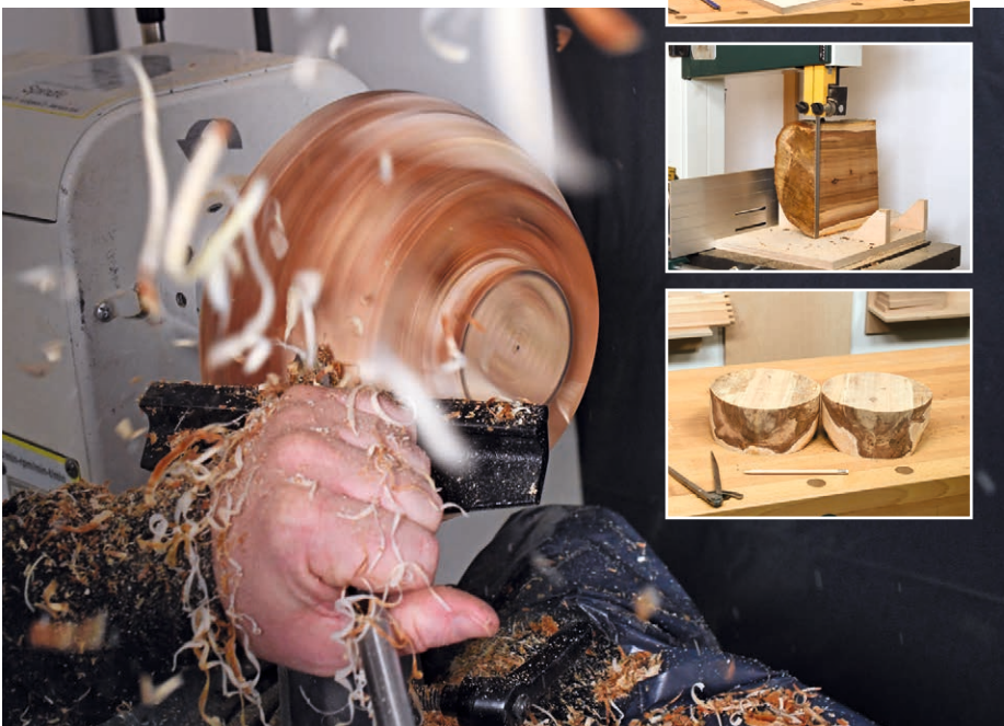
Bis hierher alles wie gehabt: Holz auftrennen, Rohlinge vorschneiden und grob in Form dreheln.
