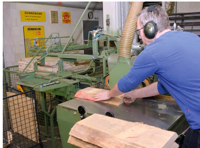
Geschäftsführer Matthias Diephaus trennt im nächsten Schritt die Bohlenstücke zu Kanteln auf. Die Maschine hat vier im Tisch versenkte Parallelanschlüge, die sich auf Knopfdruck herausfahren – je nachdem, ob und wie viele Kantelbreiten in einem Stück stecken.
