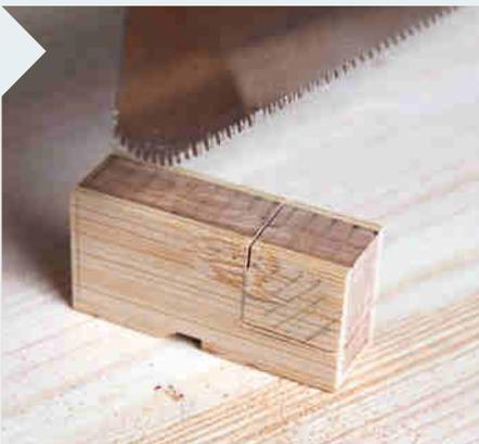
**10** Sägen Sie den Ausschnitt mit einer feinen Handsäge aus. Auch die Dekupiersäge kann zum Einsatz kommen. Schleifen Sie danach den Sägeschnitt glatt.
