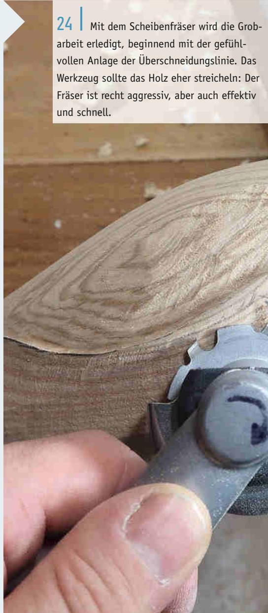
**24** | Mit dem Scheibenfräser wird die Grobarbeit erledigt, beginnend mit der gefühlvollen Anlage der Überschneidungslinie. Das Werkzeug sollte das Holz eher streicheln: Der Fräser ist recht aggressiv, aber auch effektiv und schnell.
