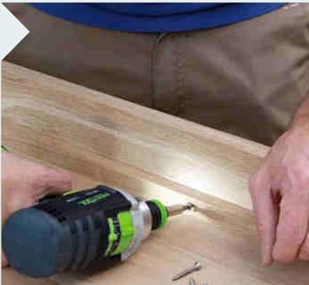
**24** Schließlich werden die Leisten (Position 5) an den Rahmen geschraubt. Sie bilden eine Führung für die Tischplatte und verhindern in Verbindung mit den Haltern auf den Laschen (Position 10), dass die Tischplatte abgehoben werden kann.
