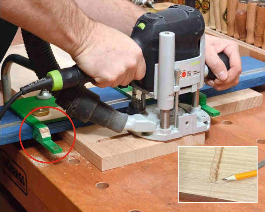
Fräsen Sie nun von Anschlag zu Anschlag. Wenn der Absaug Schlauch immer noch stört wie hier, lässt sich der Reiter noch etwas abschrägen (Kreis). Das Ergebnis des Fräsdurchgangs: Eine punktgenau eingesetzte Fräsung (kleines Bild).
