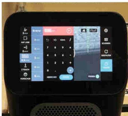
Unter dem Menüpunkt „Fräsen“ werden jetzt alle wichtigen Daten zum eigentlichen Fräsvorgang, wie beispielsweise Frästiefe, Versatz oder Fräserdurchmesser eingestellt.
