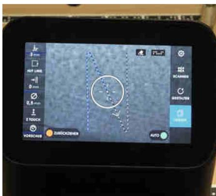
Ist der Motor eingeschaltet, bewegt man die Maschine über einen der Buchstaben, drückt den grünen Knopf im rechten Handgriff und der Motor samt Fräser senkt sich exakt bis zur vorgewählten Frästiefe ins Material. Sogleich erscheint ein kleiner Pfeil, der einem die Fräsrichtung weist. In diese Richtung fräst man nun die gesamte Buchstabenkontur ab.
