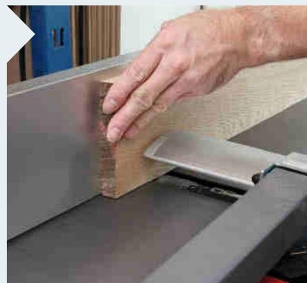
**5** Die Tischplatten bestehen aus miteinander verleimten Einzelbrettern. Damit sich die Platten nicht aufwerfen, muss jedes Brett an seiner Längsseite rechtwinklig zur Brettfläche gefügt werden. Dabei hilft der rechtwinklig eingestellte Anschlag an der Abrichte.
