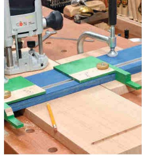
Wenn Sie die Anschlagplatte genau rechtwinklig entlang der Werkstückkante herunterführen, müssen Sie für eine weitere, identische Nut nicht einmal die Reiter einstellen. Hier hilft eine Markierung auf der blauen Plattenkante.
