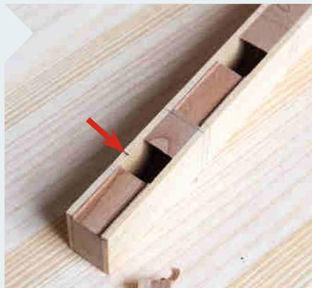
**5** Der Deckel und der Vorschlag der dahinter folgenden Pfeife werden als ein (!) Stück von der dafür vorgesehenen Leiste abgesägt. (Im Folgenden wird das gesamte Stück als „Deckel“ bezeichnet.) Zeichnen Sie von der Kernkante 4 mm nach hinten an (Pfeil).
