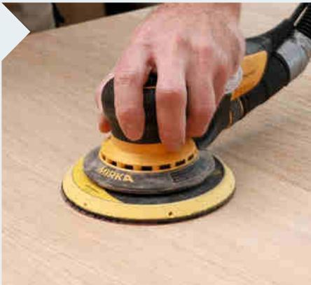
**18** Der anschließende Schliff beseitigt noch feine Unebenheiten. Beginnen Sie mit einer 80er-Körnung und erledigen Sie den abschließenden zweiten Schleifgang mit einer 180er-Körnung.
