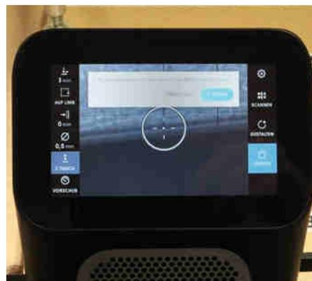
Auf keinen Fall sollte man den vorletzten Menüpunkt „Z Touch“ vergessen. Dabei wird die Werkstückoberfläche kurzzeitig von der Fräsespitze berührt und die Maschine weiß jetzt ganz genau, wann der Fräser zum ersten Mal ins Material eintaucht.
