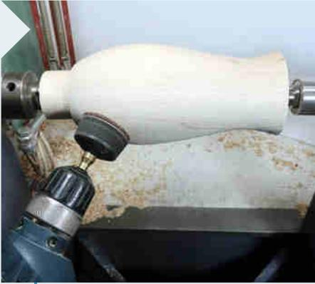
**10** | Hier die Parameter fürs Schleifen bis Körnung 180: Möglichst hohe Geschwindigkeit, mittelharter Schleifteller (50 mm), Schliff in Rechts- und Linkslauf. Kippen Sie den Schleifteller nur soweit ab, dass die Kante des Werkstückes nicht anschlägt.
