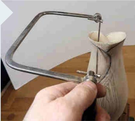
**16** Erster Schritt zur Formgebung jenseits der Drechselbank: Der Oberrand wird mit einer Fein- oder Laubsäge ausgeschnitten.
