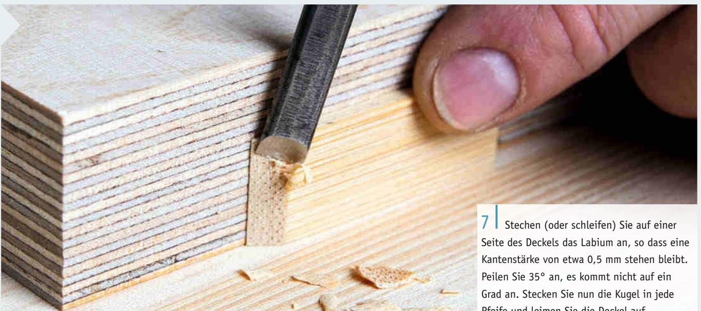
**7** Stechen (oder schleifen) Sie auf einer Seite des Deckels das Labium an, so dass eine Kantenstärke von etwa 0,5 mm stehen bleibt. Peilen Sie 35° an, es kommt nicht auf ein Grad an. Stecken Sie nun die Kugel in jede Pfeife und leimen Sie die Deckel auf.
