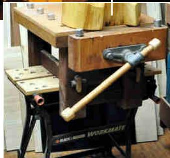
Im Sommer arbeitet der Lüneburger **draußen** – auf eine ordentliche Spannhilfe muss er dabei nicht verzichten. Die selbst gebaute Platte hat eine Vorderzange einer alten Hobelbank bekommen, die Unterkonstruktion ist ein angepasster Hocker, dem ein Workmate von Black&Decker die richtige Höhe gibt. Die kleine Bank hat genug Gewicht, um **stabil daran zu arbeiten**, bleibt aber transportabel.
