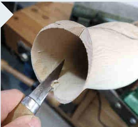
**20** Auf der Innenseite führt ein gerades Schnitzmesser die Überschneidung bis etwa 3 cm unter dem Rand weiter.
