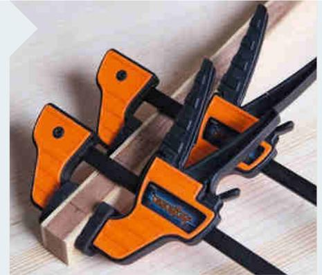
**3** Leimen Sie dann die Seitenleisten auf und zwar bündig mit der Oberseite. Den Leim darf der Einfachheit halber auf ganzer Fläche auf die Leisten. Meistens biegt sich die Kernleiste durch die vielen Bohrungen. Das lässt sich aber beim Leimen leicht korrigieren.
