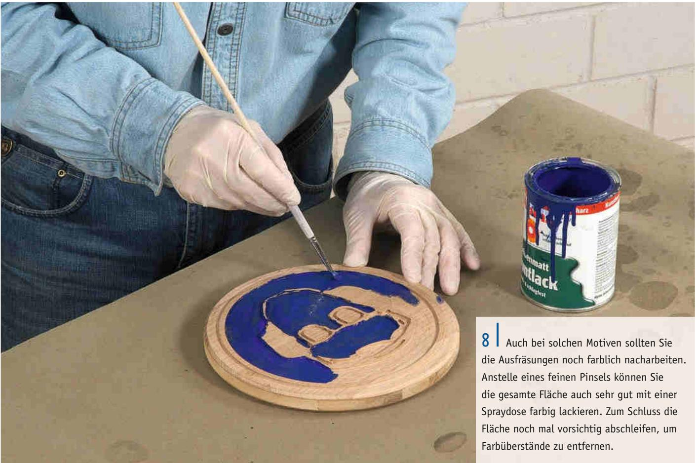
**8** Auch bei solchen Motiven sollten Sie die Ausfräsungen noch farblich nacharbeiten. Anstelle eines feinen Pinsels können Sie die gesamte Fläche auch sehr gut mit einer Spraydose farblich lackieren. Zum Schluss die Fläche noch mal vorsichtig abschleifen, um Farbüberstände zu entfernen.
