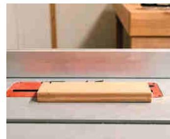
Keine Selbstverständlichkeit in dieser Preisklasse: Der Spaltkeil kann abgesenkt werden – verdeckte Schnitte sind so möglich.
