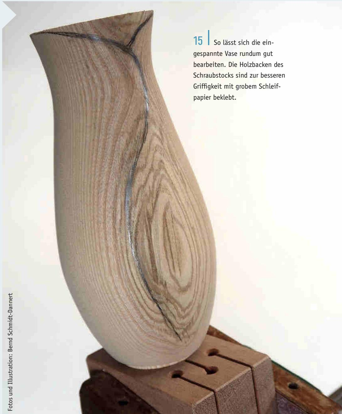
**15** | So lässt sich die eingespannte Vase rundum gut bearbeiten. Die Holzbacken des Schraubstocks sind zur besseren Griffigkeit mit grobem Schleifpapier beklebt.
