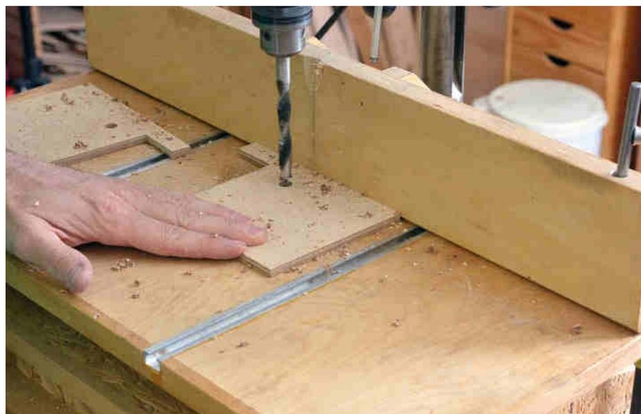
Die zwei 8-mm-Löcher je Anschlagplatte haben verschiedene Zwecke: Eines lässt die Schraube (wenn auch stramm) hindurch, die andere nimmt einen Dübelstummel auf. Er steht nach unten durch, gleitet in der T-Nut-Schiene und verhindert so ein Verdrehen der Reiterplatte.
