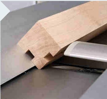
**10** | Die Kanten sind noch scharf. Um sie zu fassen, wird der Fügeanschlag um 45° gekippt und alle Außenkanten des Tisches daran entlanggeführt: Somit müssen alle Seiten der Beine, die Traversen (Pos. 2 & 3) und die außen liegenden Bretter der Tischplatte gefast werden.
