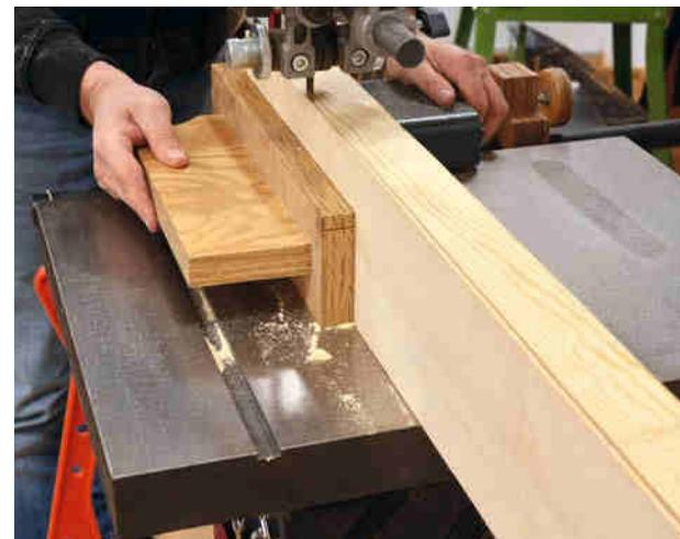
Schnitt für Schnitt können Sie nun die immer gleiche Fläche am Anschlag entlangführen. Eine selbst gebaute Zuführlade erhöht die Sicherheit beim Schneiden.
