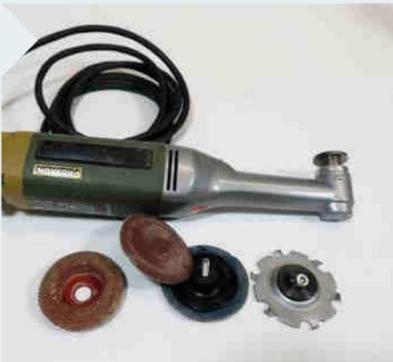
**23** | Verwendet wird ein Mini-Winkelschleifer von Proxxon mit einem 50-mm-Scheibenfräser, einer Rundraspel und dazu flexiblen Schleiftellern. Das Arbeiten mit dem Fräser braucht Übung und Umsicht: Tragen Sie eine Schutzbrille!
