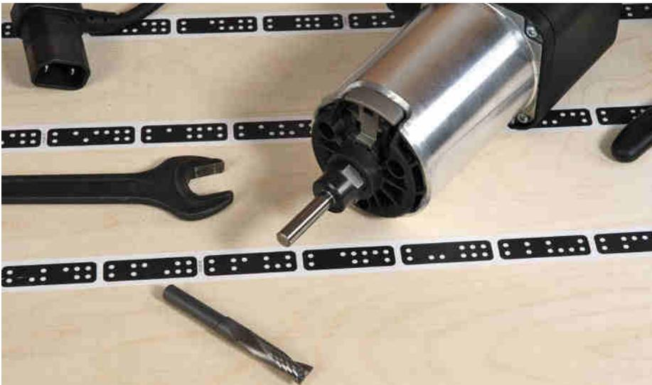
Um ein Raster aus Gitterlinien zu erstellen, wird zuerst anstelle des Fräasers ein runder Taststift in die 8er-Spannzange eingesetzt.
