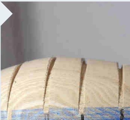
**7** Jetzt wird der Rohling (nur an der Reitstockseite!) um einen Zentimeter versetzt. Reduzieren Sie die Drehzahl auf 800 bis 1.000 U/min. Setzen Sie mit einem Abstecher alle 2,5 cm eine Nut, bis das blaue Band erreicht ist.
