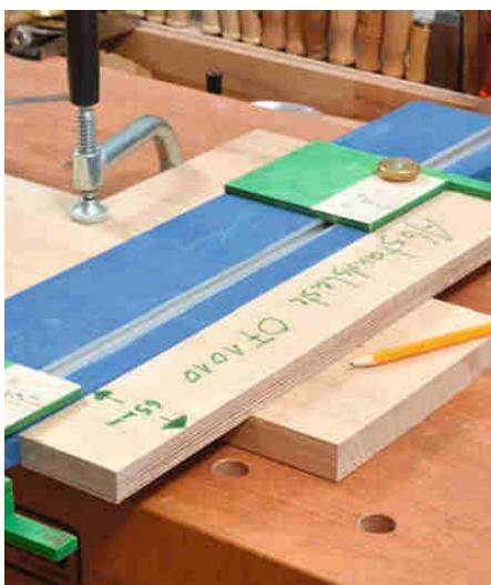
Auf zum Einsatz: Die Mittellinie der Nut ist gezogen und die deutlich beschriftete Abstandsleiste positioniert die blaue Anschlagplatte.
