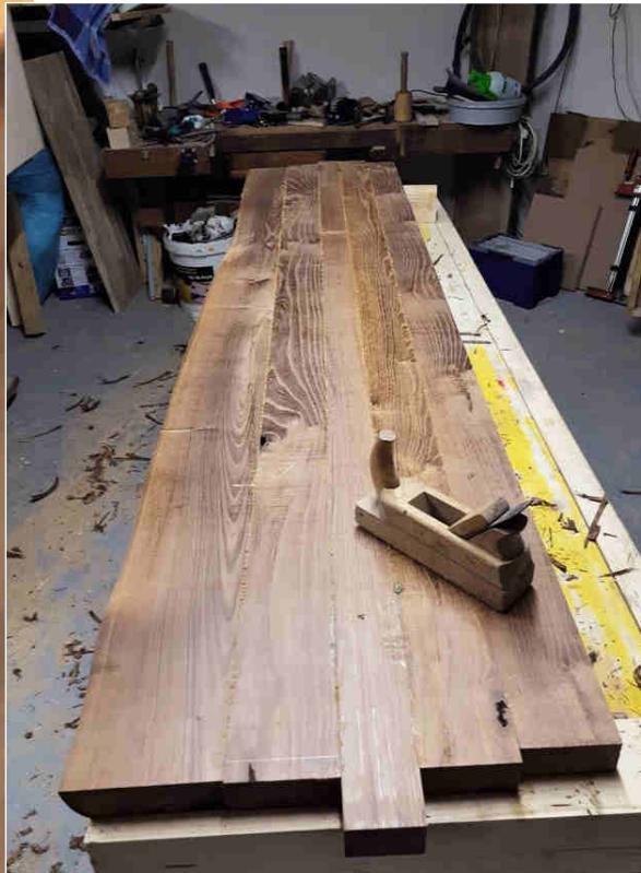
Fast alles entsteht in Eigenarbeit. Massivholzplatten verleimt und hobelt Gerhard Nagy selbst. In den nächsten Jahren soll eine neue, noch größere Werkstatt, freistehend im Garten entstehen: Hier soll dann auf dem Dachboden auch selbst aufgetrenntes Holz trocknen.
