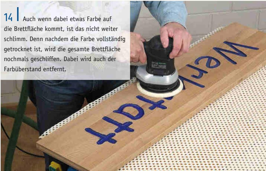
**14** | Auch wenn dabei etwas Farbe auf die Brettfläche kommt, ist das nicht weiter schlimm. Denn nachdem die Farbe vollständig getrocknet ist, wird die gesamte Brettfläche nochmals geschliffen. Dabei wird auch der Farbüberschuss entfernt.
