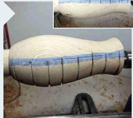
**9** Drehen Sie nun den Überschuss zwischen den Einschnitten auf der einen, dann auf der anderen Seite ab. Eine stabile Formröhre mit Fingernagelanschiff ist perfekt. Erhöhen Sie die Drehgeschwindigkeit sukzessive, so dass eine recht glatte Oberfläche entsteht.
