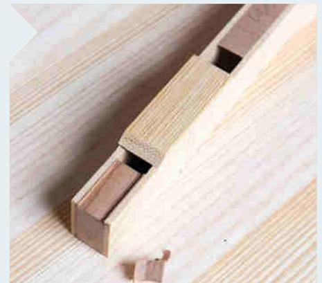
**6** Die Strecke von diesem Punkt bis zur nächsten Kernkante ergibt die Länge des Deckels. Durch Fertigungsungenauigkeiten sind sie nicht alle gleich lang! Sägen Sie die Längen individuell ab. Bei der ersten und letzten Pfeife werden Vorschlag und Deckel einzeln gefertigt.
