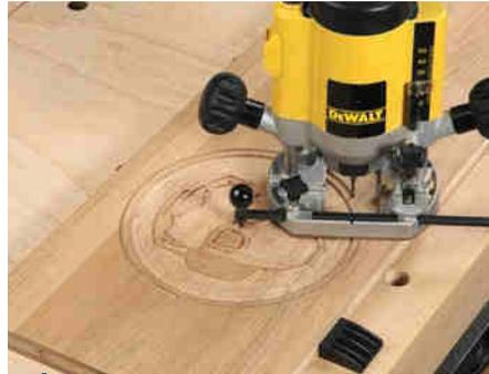
**6** Die kreisrunden Begrenzungen und das Ausfräsen des Gebotsschildes erledigen Sie zum Schluss mit einer Zirkleinrichtung. Das ist natürlich deutlich präziser als das freihändige Abfahren mit dem Pantograph.
