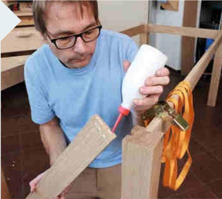
**21** Die Montage des Rahmens steht an. Nach dem Auftrag von reichlich Leim auf die Kopfenden der Traversen werden sie in die Nuten der Beine eingeführt, die Halter zwischen den Traversen mit Dominos verleimt. Der Rahmen wird mit Ratschengurten fest verzurrt.
