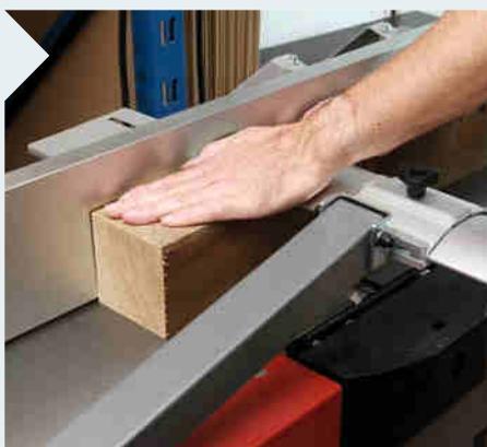
**6** Die Beine bestehen aus Vollholz. Die sägerauen Eiche-Balken lassen sich am besten hobeln, wenn sie zuvor auf Länge zugeschnitten wurden. Das Hobeln der Beine erfolgt wie das der Bretter: Zuerst wird eine ebene Fläche abgerichtet.
