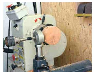
**Exakt auf der Achse bohren**
