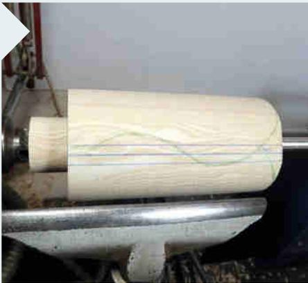
**4** Drehen Sie zunächst einen zentralen Zapfen zur späteren Aufnahme in ein Drechselfutter. Das Zapfenmaß richtet sich nach Ihrem Futter. Auch ein Schwalbenschwanz-Zapfen ist möglich, allerdings ist der Halt beim Ausdrehen nicht so gut.
