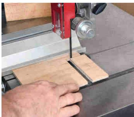
Alle Teile sind auf der Kreissäge schnell rechteckig zugeschnitten. Nur die dünnen Reiterplatten und -anschlüsse benötigen je eine Ausklüftung. Die sind auf der Bandsäge nach den Maßen in der Zeichnung schnell erledigt.
