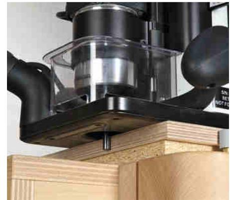
Der Metallstift tastet anschließend genau nach der Anleitung auf dem Bildschirm zuerst die vordere und danach eine seitliche Werkstückkante ab.
