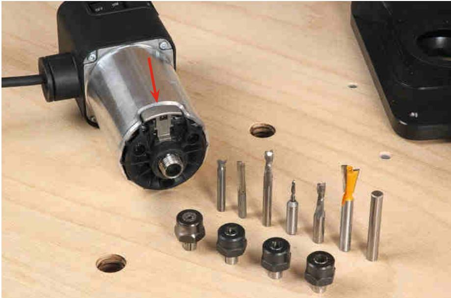
Alle Arten von stirnschneidenden Fräsern können eingesetzt werden. Also auch Hohlkehhl- und Profilfräser, mit denen man ins Holz eintauchen kann. Der Fräserdurchmesser darf aber 25,4 mm (1 Zoll) nicht überschreiten. Das Gerät gibt jedoch eine Warnung aus, wenn man größere Fräser in der Software anlegen möchte.
