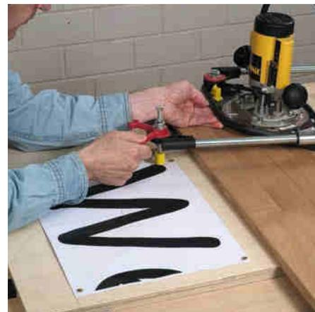
**6** | ... Taststift und rechtwinklig zur Platte ausrichten und mit Reißnägeln fixieren. Stellen Sie dann die Fräse ein und starten Sie die Oberfräse. Senken Sie als nächstes den Taststift auf die Vorlage und senken Sie die Oberfräse aufs Brett.
