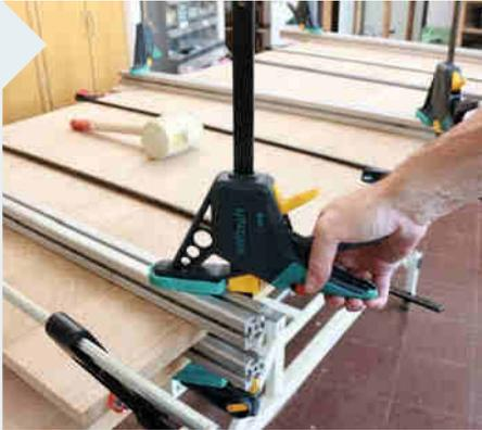
**15** Die Bretter bleiben auch nach dem Leimauftrag in der zuvor ermittelten Reihenfolge. Die geleimten Kanten treffen auf Kanten, auf die kein Leim aufgetragen wurde. Nun werden von oben weitere Alu-Profile genau über die schon liegenden Profile gelegt und verspannt.
