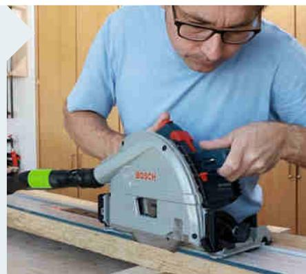
**2** Nach dem Besäumen folgt der grobe Zugschnitt auf Länge und Breite. Kleinere Bauteile wie die Kopfbänder (Position 4) werden erst später aus einem einzigen langen Stück Holz geschnitten: Längere Bretter erleichtern das Hobeln ungemein.
