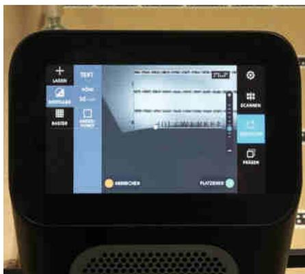
Ist der Text eingegeben, wird er im nächsten Schritt auf die gewünschte Höhe skaliert und anschließend auf der Werkstückfläche platziert. Das geschieht durch Drücken des grünen Knopfes im rechten Griff der Origin.
