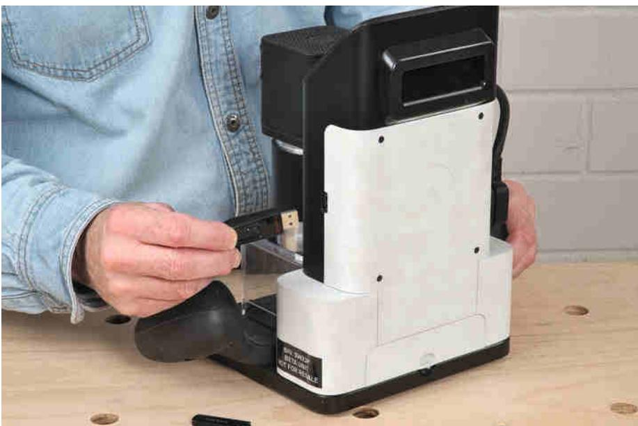
Das Gerät kann entweder über ein WLAN-Netzwerk (zum Beispiel für Software-Updates) oder, bei fehlendem Internetzugang, auch mithilfe simpler USB-Sticks mit Daten im SVG-Format gefüttert werden.
