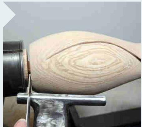
**27** | Der letzte Schritt ist das Abstechen des Zapfens, wieder auf der Drechselbank. Hinterschneiden Sie leicht für den sicheren Stand. Die letzten anderthalb Millimeter übernimmt eine Säge bei stehender Maschine.
