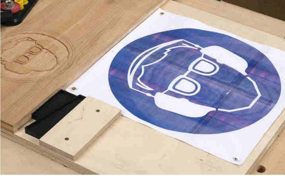
**4** Denken Sie daran, dass ihr fertiges Motiv immer um 50 Prozent kleiner ist als die Vorlage. Bei einer Motiv-Vorlage mit 28 cm Durchmesser beträgt das fertige Ergebnis also nur noch 14 cm!
