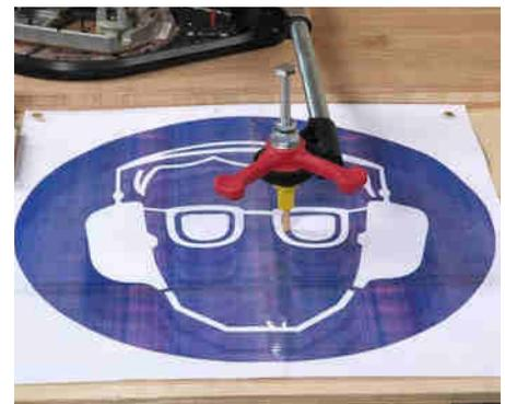
**2** | ... Sie noch einen etwa doppelt so großen Abtaststift in Form eines 6-mm-Dübels oder Rundstabs. Mit diesem dünnen Dübel können Sie dann auch feinere Details der Vorlage abfahren.
