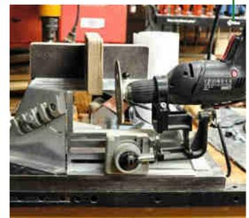
Diese **Schärfstation** ist nicht umsonst fest auf der zentralen Werkbank platziert. Alles, was stumpf werden kann, schärft Dirk Lüchow selber. Von den Möglichkeiten, die Kaendl mit dieser Vorrichtung gibt, ist er überzeugt. Er gibt aber auch zu: „Es dauert etwas, bis man gerade die komplizierteren Sachen, wie Bohrer schärfen, wirklich kann. Aber es lohnt sich – das Werkzeug ist **gleich wieder einsatzbereit**.“
