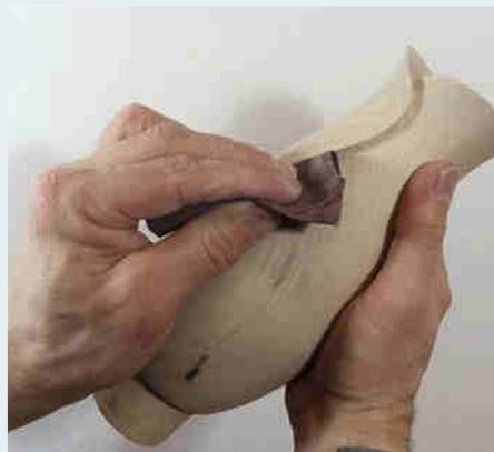
**26** | Der Endschliff erfolgt in jedem Fall von Hand in Faserrichtung. Nur so lassen sich die Details sauber ausarbeiten. Bis Körnung 400 ist bei Esche sinnvoll.
