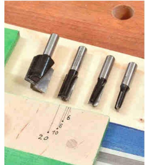
Und so geht es weiter, bis Sie alle gewünschten Fräser erfasst haben. Alternativ können Sie die Markierungen natürlich auch rechnerisch festlegen: Der Abstand zwischen den Markierungen etwa für einen 6-mm und einen 8-mm-Fräser beträgt die halbe Differenz der beiden, also einen Millimeter.
