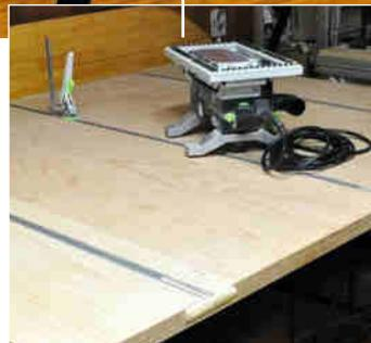
Die **T-Nut-Schienen** für diesen Spanntisch stammen von einem Bücherregal und sollten eigentlich entsorgt werden. Dirk Lüchow hat einige davon vor dem **Schrott** bewahrt. Eine aufgedoppelte Multiplexplatte mit genug Abstand für die Schienen zwischen den oberen Abschnitten machte die Konstruktion einfach und verleiht ihr gleichzeitig die nötige Stabilität. Die Holzstopfen an den Enden der Schienen verhindern, dass sich Kabel dort verheddern.
