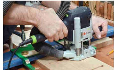
Nut für Nut lässt sich so nach nur wenigen Sekunden Umbauzeit fräsen. Ausgerichtet wird jedes Mal erneut mit der Anschlagleiste. Falls diese wie hier nicht zwischen die fixierten Reiter passt, schneiden Sie einfach ein kürzeres Exemplar.
