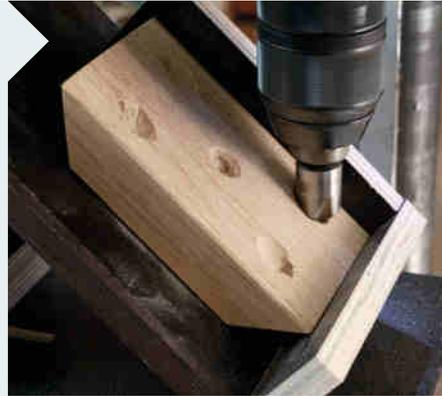
**22** Bohren Sie nun die Schraubenlöcher und anschließend Senkungen in die Kopfbänder. Bauen Sie eine kleine, einfache Vorrichtung aus Multiplex, die Ihnen ermöglicht, in das Kopfband Bohrungen und Senkungen um 45° gekippt zu bohren.
