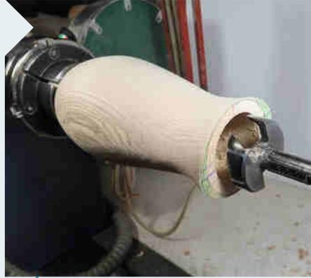
**11** | Spannen Sie die Vase in ein passendes Drechselfutter und bohren Sie es mit einem 50-mm-Forstnerbohrer 18 cm tief aus. Das Ausdrehen geht am einfachsten mit einem spandickenbegrenzten Aushöhlwerkzeug (wie Munro oder Exocet).
