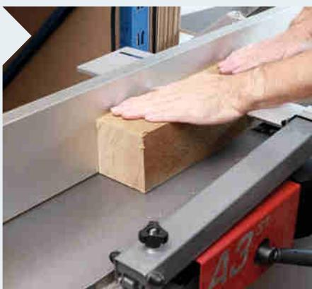
**7** Jetzt wird am Fügeanschlag eine weitere Fläche im rechten Winkel zur ersten Fläche gehobelt. Mit diesen zwei Referenzflächen können Sie dann die Beine mit dem Dickenhobel auf die gewünschte Dicke bringen.
