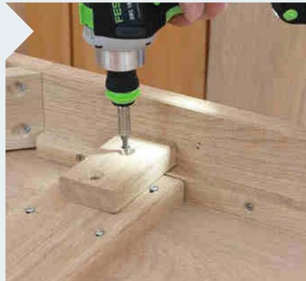
**25** Montieren Sie die Laschen (Position 9) mit Schrauben auf die Unterseite der großen Tischfläche. Damit die Tischfläche arbeiten kann, müssen die Bohrlöcher als Langlöcher ausgearbeitet sein. Anschließend schrauben Sie die Halter (Position 11) auf die Laschen.
