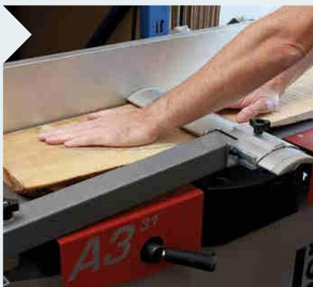
**3** Nach dem Auftrennen geht es nun an das Abrichten. Dazu wird die sägeraue Eiche auf den Aufgabebereich der Abrichte gelegt und so oft gehobelt, bis eine ebene Fläche entstanden ist.
