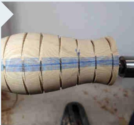
**8** Wichtig: Es wird nur bis zur Hälfte des exzentrischen Anteils der Silhouette eingestochen! Häufige Kontrollen bei abgeschalteter Maschine sind hier ein Muss. Der gleiche Arbeitsschritt erfolgt dann erneut nach dem Versetzen der Achse auf Reitstockseite.
