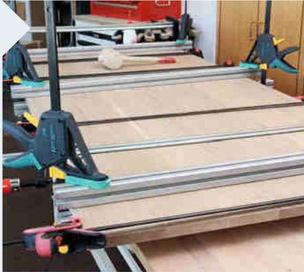
**16** An die Längskanten werden für die Verleimung Zwingen arretiert - setzen Sie dabei so viele wie möglich ein. Durch den Druck der Aluprofile von oben wird verhindert, dass sich die Tischfläche aufwölben kann, wenn der Druck von der Seite zunimmt.
