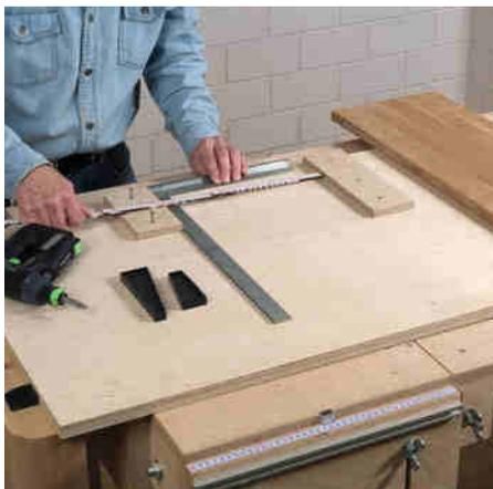
**4** | Zwingend notwendig ist eine mindestens 125 x 51 cm große Span-, Multiplex- oder MDF-Platte. Darauf schrauben Sie passend zur Werkstückbreite zwei kurze Bretter. Mit ...
