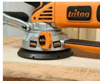
Griff und Getriebegehäuse sind aus Aluminium. Bei den 500 Watt, die darin arbeiten, sicherlich keine schlechte Idee.
