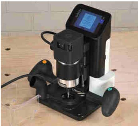
Das Funktionsprinzip ist simpel: Man hält die Maschine mit beiden Händen an den Griffen und folgt so einer Kontur auf dem Bildschirm. Da der Fräsmotor beweglich an einer Roboterkeinheit aufgehängt ist, werden Ungenauigkeiten bei der Handführung sofort automatisch ausgeglichen.
