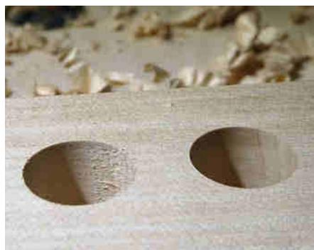
... und direkt ausprobiert: Die linke Bohrung wurde vor dem Nachschärfen gesetzt, die rechte Bohrung nach dem Schärfen.
