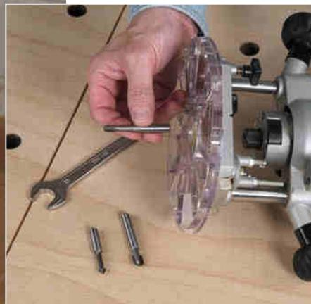
**3** | ... drei Fräser abgestimmt (ein V-Nut- und zwei Hohlkehlfräser). An die transparente Adapterplatte befestigen Sie im nächsten Schritt Ihre Oberfräse mithilfe von Zentrierkegel und Kopierhülse.
