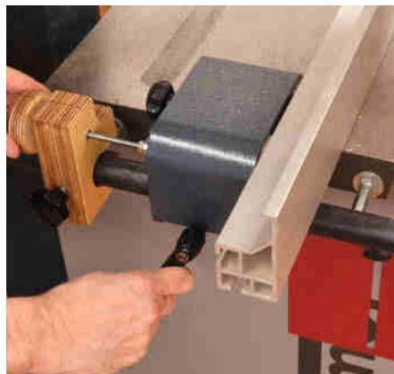
So starten Sie: Bringen Sie die Striche in Deckung, schieben Sie die Verstellhilfe mit der Hutmutter an den Anschlag und drehen Sie die Sterngriffschraube fest. Nach dem ersten Schnitt lösen Sie den Anschlag, drehen ihn um die gewünschte Millimeteranzahl nach rechts, klemmen ihn wieder fest und schneiden erneut.
