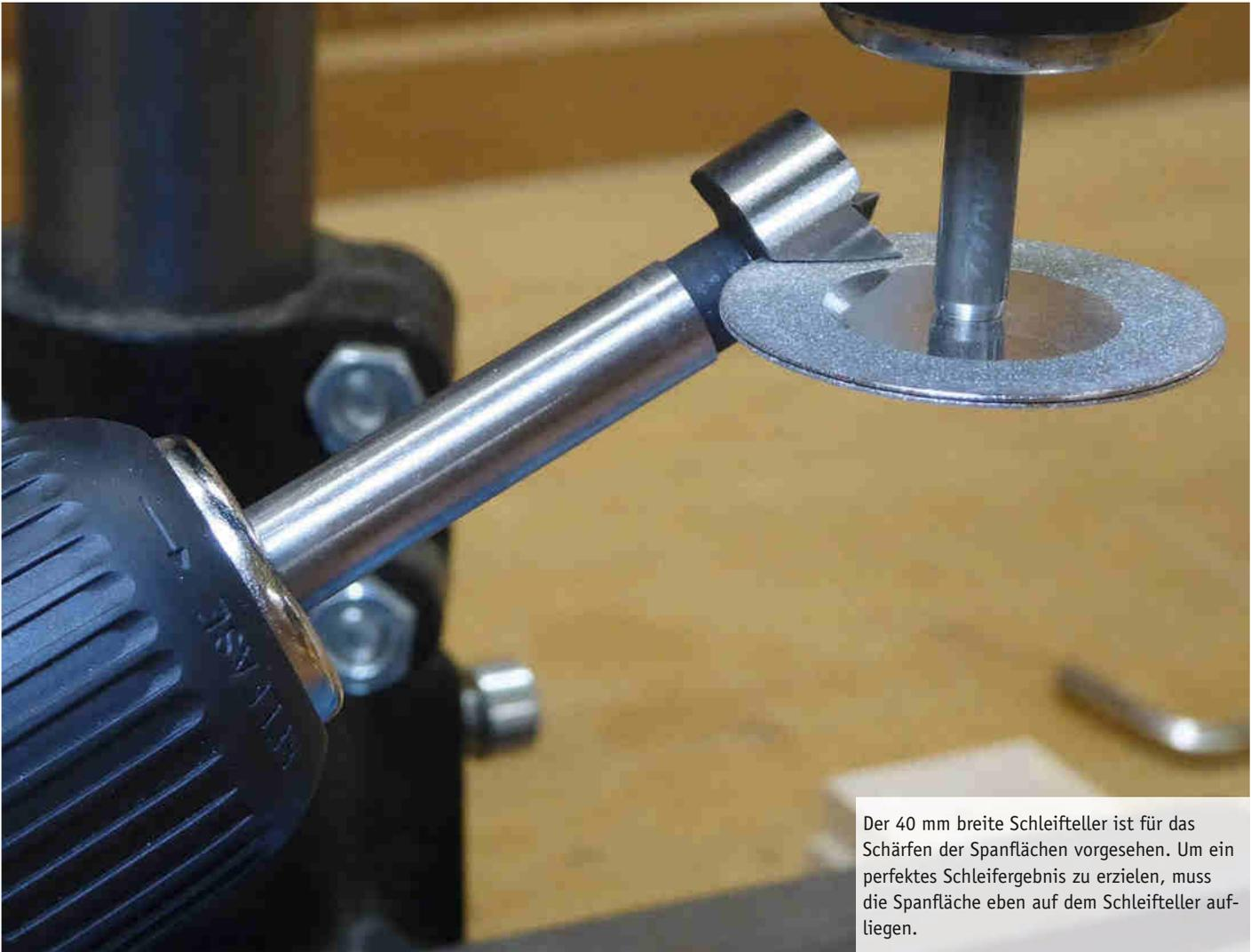
Der 40 mm breite Schleifteller ist für das Schärfen der Spanflächen vorgesehen. Um ein perfektes Schleifergebnis zu erzielen, muss die Spanfläche eben auf dem Schleifteller aufliegen.
