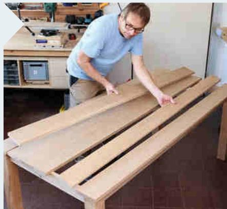
**13** | Zeit, den Tisch nun schon mal probierhalber zusammensetzen. Dazu werden die Traversen und die Beine zu einem Rahmen zusammengesteckt, um dann die Bretter für die Tischplatte aufzulegen. Jetzt sind eventuelle Korrekturen leicht möglich.
