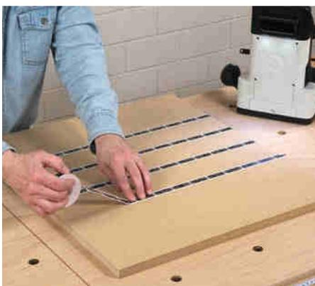
Die integrierte Kamera benötigt zur Positionsbestimmung ein Markierungsband (ShaperTape), das direkt auf das Werkstück geklebt wird.
