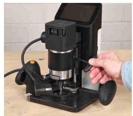
Der Fräsmotor hat eine Leistung von 720 Watt und eine variable Drehzahleinstellung von 10.000 - 26.000 U/min. Er lässt sich zum Fräserwechsel mit nur einer Schraube in wenigen Sekunden aus der Halterung entfernen.
