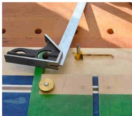
Skalieren Sie nun die beiden Reiter: Stellen Sie sie auf einen beliebigen Abstand zueinander ein und fräsen Sie eine kurze Nut, hier mit einem 20-mm-Fräser.
