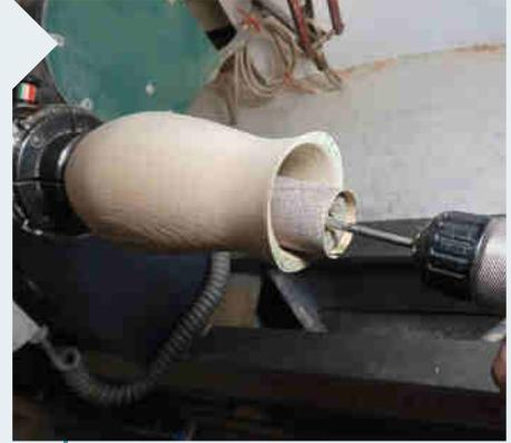
**12** | Drechseln Sie den oberen Teil der Vase zuerst auf Endmaß, solange der untere Anteil noch stabil ist. Dieser Bereich wird dann mit Schleifrollen bis Korn 180 geglättet.
