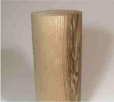
**1** Der Rohling aus Esche misst 10,5 cm x 23 cm. Der Durchmesser ist hier nicht kritisch, er kann zwischen 10 und 12 cm liegen. Der zur Walze geformte Rohling bekommt zunächst winklig sauber abgestochene Stirnseiten.
