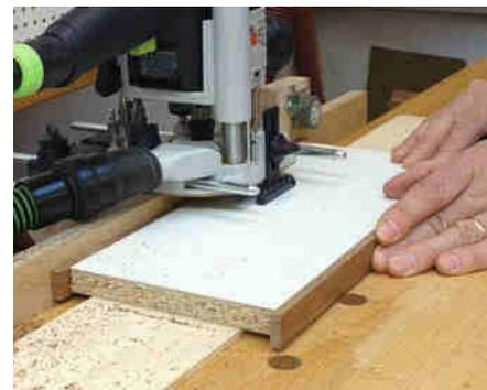
erst einmal mit einem Reststück probefräsen. Wenn nur geringe Überstände weg müssen, ist es besser, hier ausnahmsweise im Gleichlauf zu fräsen. Dabei wird das Werkstück von rechts nach links geschoben. (Hinweis: Beim Fräsen von oben ist die normale Arbeitsrichtung von links nach rechts.) Beim Gleichlaufräsen schneiden die Fräuserschneiden von der Brettkante zur Brettfläche. Dadurch können keine Kantenausrisse entstehen. ◀
