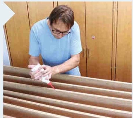
**14** | Die Bretter der Tischplatte werden nun in der gewählten Reihenfolge aufgestellt und auf die obenstehenden Kanten Leim aufgetragen. Legen Sie bereits quer zur Platte laufende Zulagen fürs spätere Verpressen unter die Bretter, hier sind es drei Aluprofile.
