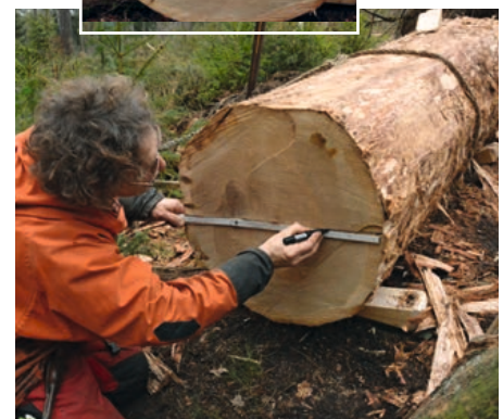
Am Zopfende wird die erste Spaltlinie angezeichnet. Sie soll durch die Markröhre laufen und den Stamm in zwei möglichst gleich große Hälften teilen. Ein im Kern sichtbar gewordener Entspannungsriss wird dabei ignoriert.
