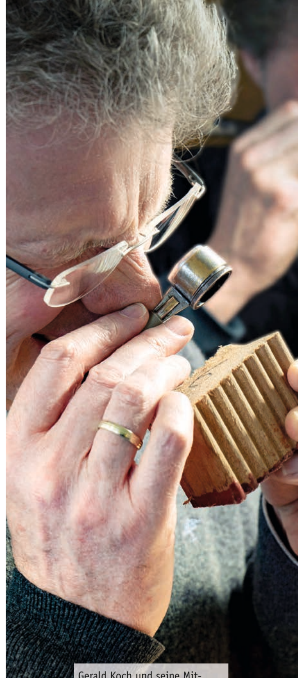
Gerald Koch und seine Mitarbeiter untersuchen Holzproben zunächst mit der Lupe. Hier erhalten sie erste wichtige Hinweise über die Herkunft des Holzes.
