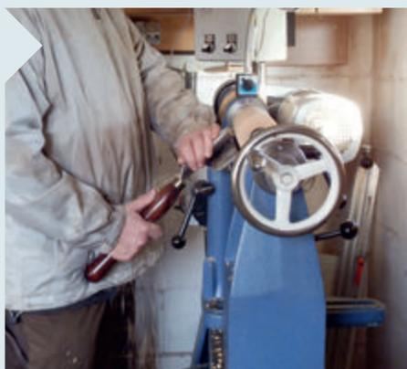
**5** Der Holzrohling ist zentriert zwischen den Spitzen gespannt. Gerade wenn leicht rissige oder mit Rindeneinschlüssen versehene Hölzer gedreht werden, ist ein Visier ein echtes Sicherheitsplus.
