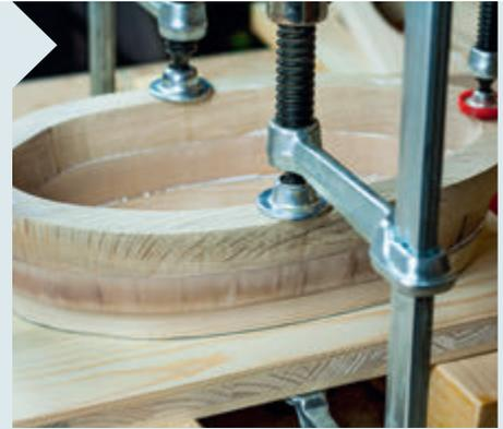
**3** Sind die Ringe nicht ganz sauber gesägt, können Sie sie mit einer Schleifhülse einzeln vorschleifen. Verleimen Sie nun nur die drei Ringe ohne die Grundplatte möglichst passend, am besten auf einer Zulage (siehe Kasten).
