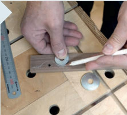
**15** Die Deckelstütze besteht aus mehreren Teilen. Nutzen Sie eine Karosseriescheibe oder Münze, um die die geschwungene Form der oberen Halterung auf eine flache Leiste zu zeichnen. Zuvor wird ein 4,5-mm-Loch zur Aufnahme der Drehachse gebohrt.
