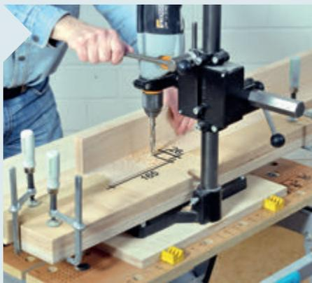
**5** Die fertigen Füße bekommen dann 165 mm vom unteren Fußende entfernt noch 10-mm-Bohrungen, um dort die Längs- und Querschwingen mit Schlossschrauben anzubringen. Auch die Tischplatte wird so verbunden. Die genauen Bohrmaße finden Sie in der Zeichnung.
