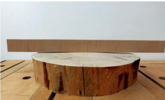
Das Uddeholm-Bandsägeband hat sich beim Schnitt quer zur Faser gebogen. Ergebnis: Die Schnittfläche der Scheibe ist konvex.
