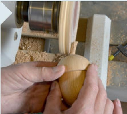
**16** | Nun wird der Stiel mit einer Schleifscheibe grob in Form geschliffen. Messen Sie den Durchmesser des Kegelansatzes (die dünnste Stelle) und übertragen Sie dieses Maß aufs Hirnholz. So haben Sie einen Anhaltspunkt für eine durchgängig gleiche Stieldicke.
