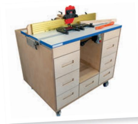
Der Grundaufbau des Frästisches entspricht in weiten Teilen dem, was man auch von anderen Tischen kennt. Den Unterschied zu anderen Frästischen machen die Detaillösungen aus, zum Beispiel die Ablagefächer hinter dem Fränschlag für alles, was man ständig in Reichweite haben muss wie Schiebstock, Messgeräte und Werkzeug für den Fräserwechsel. In die beiden Seitenwände sind T-Nut-Schienen eingelassen, um bei Bedarf Tischverlängerungen zu montieren oder auch selbstgebaute Vorrichtungen aufzunehmen.
