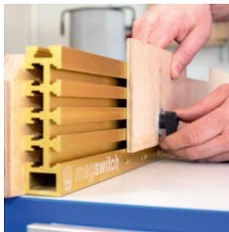
Sicher und flexibel ist dieser große Fräsan-schlag. In den T-Nuten findet allerlei Zubehör guten Halt, ohne dass Schraub- oder Klemm-zwingen beim Fräsen stören
