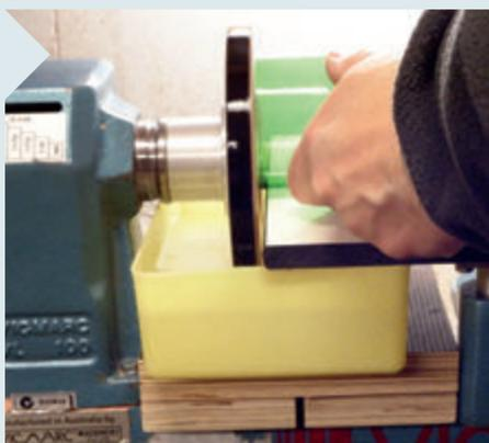
**4** Die Schnittfläche wird an einem Schleifteller von kleinen scharfkantigen Unebenheiten befreit. Brechen Sie auch die scharfe Glaskante auf der Innenseite der Flasche von Hand.
