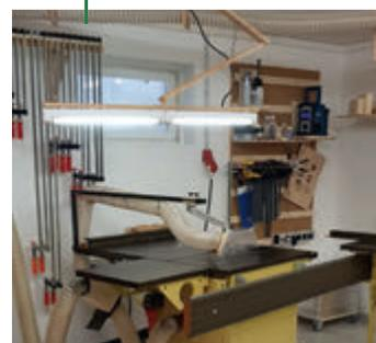
Für genaue Arbeiten an seiner meist- genutzten Maschine, der Format- kreissäge **Scheppach TS 4000**, hat Alex Westner eine eigene **Werk- statt-Leuchte** gebaut. Mit der Hö- henverstellung ist er allerdings noch unzufrieden, die gewählten Federn sind zu schwach, um die Leuchte in verschiedenen Höhen zu fixieren.
