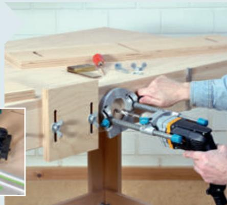
**10** Legen Sie danach die Anschlagplatten auf das Rechteckrohr und zeichnen Sie sich durch die Langlöcher die Bohrpositionen für die Schlossschrauben auf. Bohren Sie die Löcher dann mit einem mobilen Bohrständer im Abstand von 55 mm zur Zargenunterkante.
