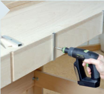
**8** Für eine präzise Höhenverstellung der beiden äußeren Anschläge und dem dazwischen liegenden Schienenhalter rei je ein Rechteckrohr völlig aus. Diese werden einfach mit je einer Spanplattenschraube an die Zargen geschraubt.
