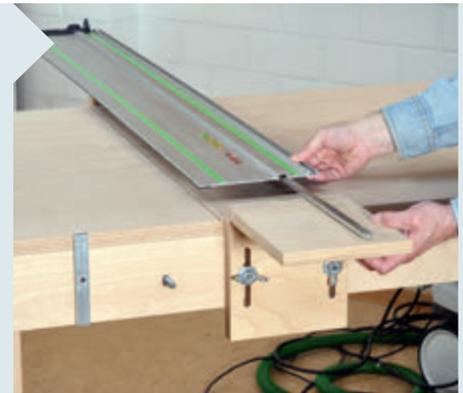
**13** | Ziehen Sie die Senkkopfschrauben zunächst nur leicht an, damit Sie die Führungsschiene noch gut auf den Metallstab aufschieben können. Lassen Sie die Schiene etwa 30 bis 40 mm über dem Halter vorstehen und ziehen Sie dann die Senkkopfschrauben endgültig fest.
