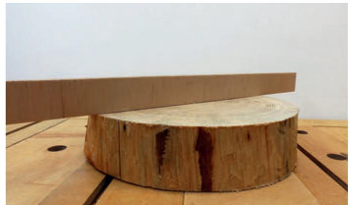
Hier der gleiche Schnitt mit RRR-Plus 20 x 0,8 mm, 3 ZpZ. Die Schnittfläche ist nahezu perfekt plan gesägt.
