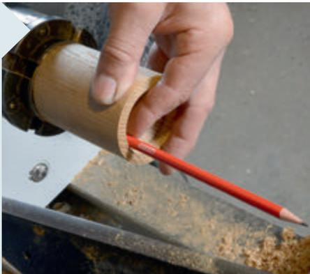
**4** So kontrollieren Sie, ob der Einstich wirklich genau parallel zur Achse steht: Drücken Sie bei stehender Maschine einen langen Bleistift an die Flanke und peilen Sie mit einem Auge, ob dieser mit der Kante des Bankbetts fluchtet.
