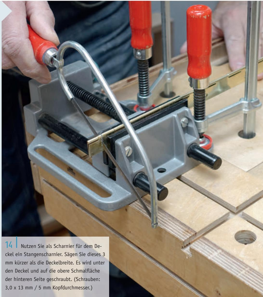
**14** Nutzen Sie als Scharnier für dem Deckel ein Stangenscharnier. Sägen Sie dieses 3 mm kürzer als die Deckelbreite. Es wird unter den Deckel und auf die obere Schmalfläche der hinteren Seite geschraubt. (Schrauben: 3,0 x 13 mm / 5 mm Kopfdurchmesser.)
