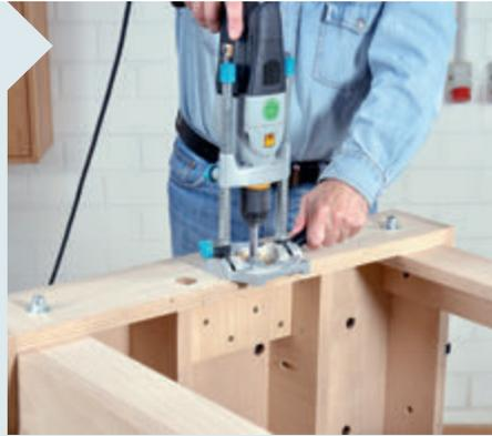
**19** | Zeichnen Sie die Bohrmittelpunkte für die beiden glatten Führungsstangen an. Bohren Sie mit einem 5 mm größeren Durchmesser als die Stangen haben. Genau so verfahren Sie dann auch mit der mittleren Bohrung für die Spindel.
