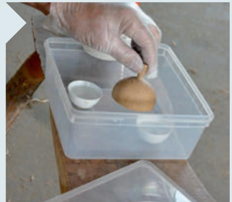
**18** | Damit die Kappe dunkel wird, wird sie in einem geschlossenen Gefäß Ammoniakdämpfen ausgesetzt. Die Konzentration des „Salmiakgeists“ entscheidet über das Tempo. Der Stoff reagiert mit der Gerbsäure im Holz der Eiche.
