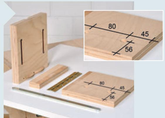
**11** Für den Schienenhalter (Pos. 8) fräsen Sie in das 24 mm dicke Brett zwei Langlöcher. In die beiden 18-mm-Bretter (Pos. 9 + 10) fräsen Sie einen 3 mm tiefen Falz (15,5 mm breit) für das Klavierband. Die Positionen 8 und 9 verbinden zwei Flachdübel.
