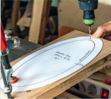
**1** Setzen Sie für den Innenschnitt der Holzringe innerhalb der Markierung eine 3-mm-Bohrung im 15°-Winkel, um das Sägeblatt einzufädeln. Klemmen Sie dazu das Werkstück überstehend am schräggestellten Säge Tisch fest und bohren Sie senkrecht durch das Brett.
