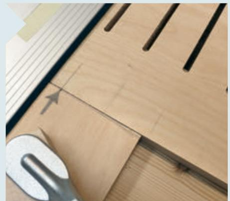
3 Referenzlinien ermöglichen die genaue Positionierung der Schlitzes. Der Pfeil auf dem Führungsholz entspricht der Fräsermitte. Nach jedem Fräsengang werden das Werkstück und die Stoppleisten verschoben, bis sich die nächste Linie mit dem Pfeil deckt.
