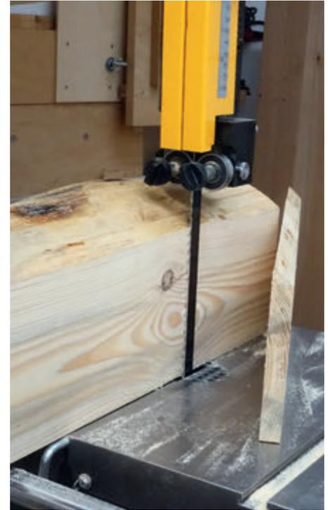
Längsschnitt am Parallelanschlag mit dem gleichen Bandsägeband: Kein Verlauf, Schnittergebnis bestens.
