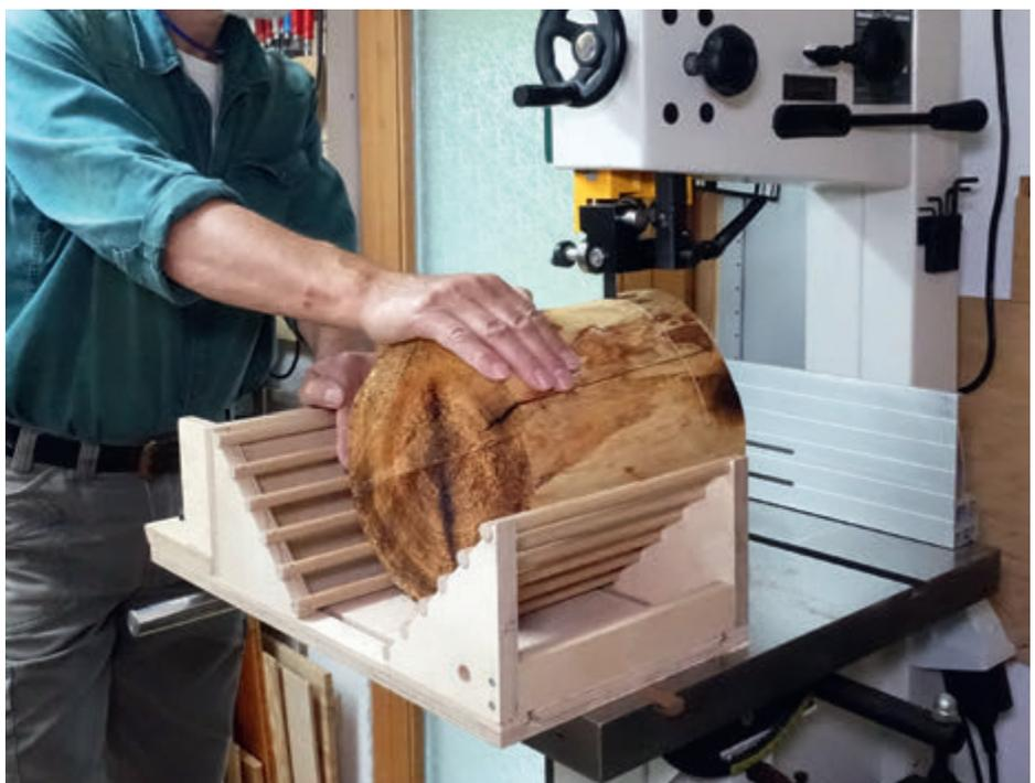
Querschnitt in einen Fichtenstamm mit 260 mm Durchmesser. Aufgelegtes Bandsägeband: Uddeholm 20 x 0,5 mm 4 ZpZ. Das Rundholz wird mit einer Schneidlade geführt. Sie fixiert das Werkstück gegen Verdrehen.
