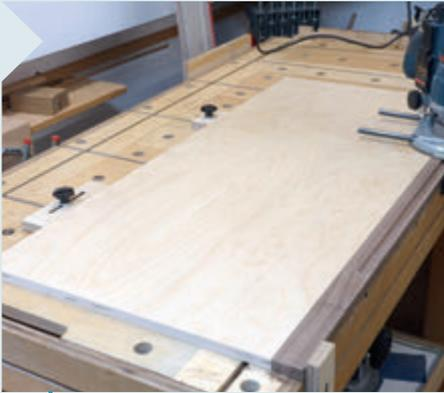
**13** Die Griffleiste wird gedübelt und angeleimt – nutzen Sie auch hier wieder die Dübel-schablone. Auf der Unterseite wird mit einem Hohlkehlfräser eine Hohlkehle für die bessere Haptik gefräst. Diese kann durchgehend oder abgesetzt sein.
