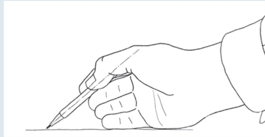
Der Stift muss aus der Hand herausragen, damit Sie die Umgebung sehen, in der der Stift zeichnet. Die Linien sollen ja zu anderen Linien parallel oder winklig sein und zur Umgebung geometrisch passen. Die aufliegende Handkante ist übrigens ein Reibungsdämpfer gegen verwackelte Linien.
