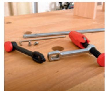
Die Zwinde ist komplett zerlegbar und lässt sich so zum Spannelement umbauen.
