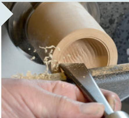
**3** Stechen Sie erst jetzt die Passung an: Dies ist ein achsparalleler Bereich von 8 mm Tiefe. Mit einem liegenden Flachmeißel lässt sich diese Arbeit gut erledigen, aber auch mit einem zum Döschen-Eisen umgeschliffenen Schaber (siehe **HolzWerken 71**, Seite 41).
