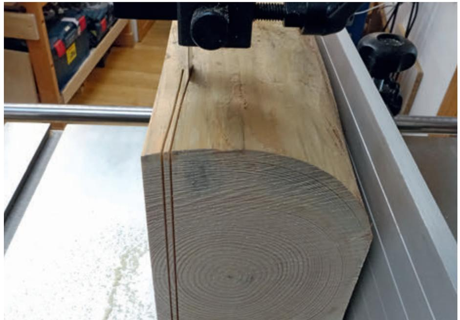
Gleicher Schnitt mit Uddeholm 20 x 0,5 mm, 4 ZpZ. Schon kurz nach dem Einschnitt ins Holz verläuft der Schnitt. Das Holz wird vom Anschlag weggezogen. Das Sägeband verdreht sich. Es ist für diese Holzdicke wohl zu dünn. Diesen Versuch haben wir abgebrochen.
