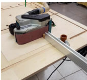
Die Halterung für den **Bandschleifer** entstand nach dem „Versuch und Irr-tum“-Prinzip: Die meisten Maschinen und Halterungen sind in SketchUp entworfen worden, die komplexe Form des Bandschleifers bedingte aber ein direktes händisches Anpas-sen und Einstellen der Befestigung an der Maschine.
