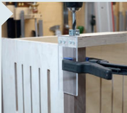
**11** Die Seitenteile erhalten oben aufliegende Abschlussleisten. Diese können nach dem Verleimen des Korpus angedübelt werden. Dabei kommt eine zweite Dübelhilfe für 8-mm-Dübel zum Einsatz, der Lochabstand ist hier 20 mm. Die Dübel kommen nur in die Stollen.
