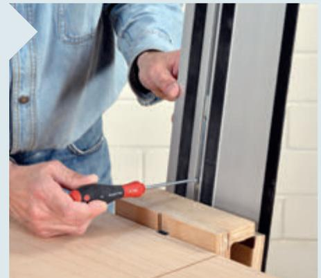
**14** | Klappen Sie jetzt die Führungsschiene nach oben und fixieren Sie sie zusätzlich noch mit den beiden Madenschrauben in den hinteren beiden Gewindebohrungen des Metallstücks.
