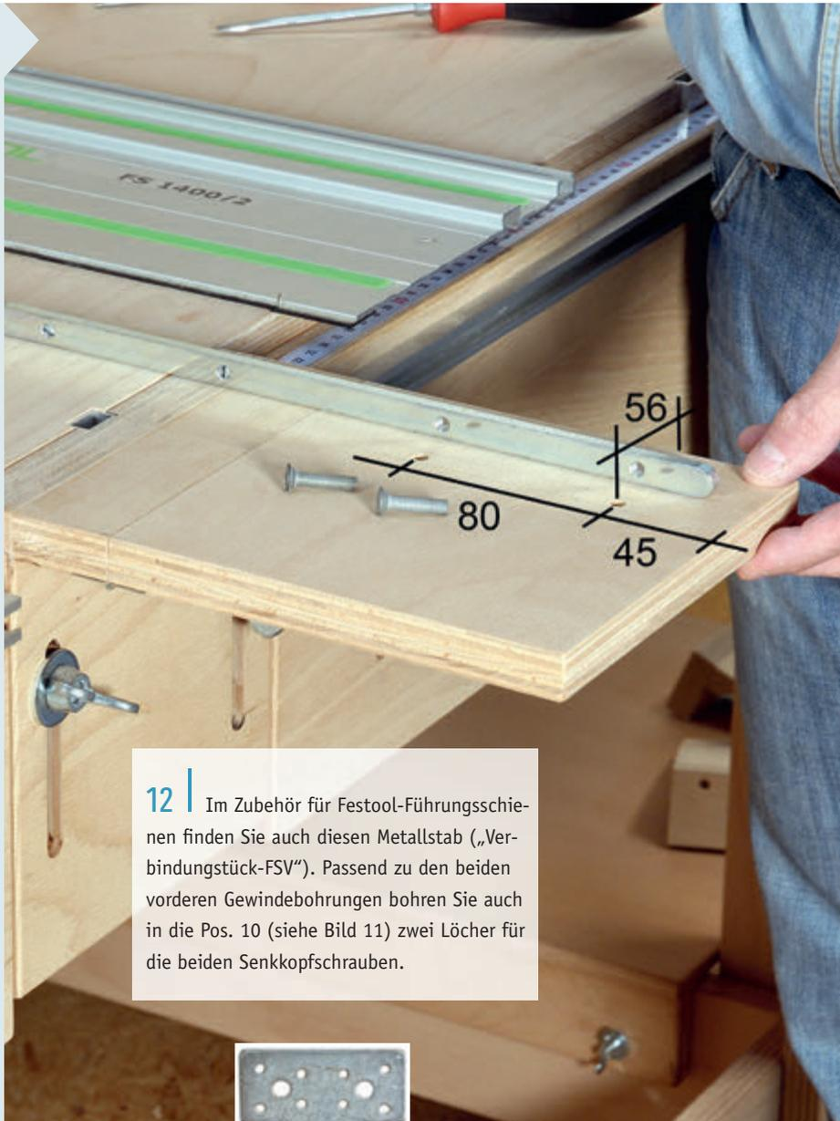
**12** | Im Zubehör für Festool-Führungsschienen finden Sie auch diesen Metallstab („Verbindungstück-FSV“). Passend zu den beiden vorderen Gewindebohrungen bohren Sie auch in die Pos. 10 (siehe Bild 11) zwei Löcher für die beiden Senkkopfschrauben.
