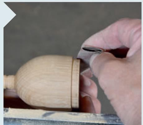
**12** Bevor Sie die Eichel abstechen, schleifen Sie noch den Falz ganz sachte bei stehender Maschine mit 240er Körnung, so dass der polierte Ring verschwindet. Nun entscheidet sich, wie leicht sich die Dose öffnen lässt.
