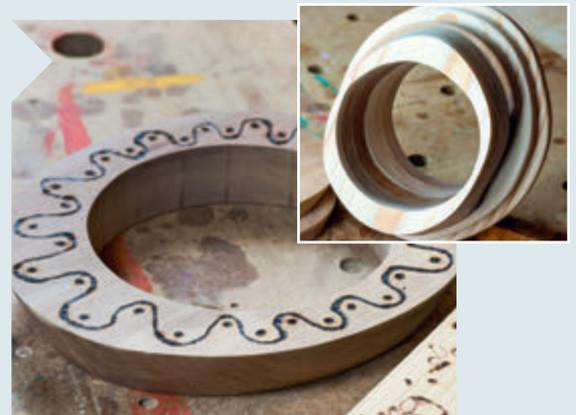
**10** Möchten Sie den obersten Ring mit einer Schnitzerei oder dem Brennstab verziern, geht das am besten vor dem Verleimen. Die Verleimung selber erfolgt wie bei der Schale. Schleifen Sie anschließend alle Verleimungen bündig.
