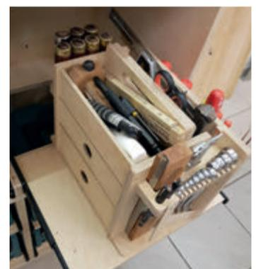
Kompakt verstaut und schnell erreichbar: Auch für seine **Handwerkzeuge** hat der bekennende Maschinen-Fan sich Gedanken gemacht und in seinen Werkzeugschrank (nicht im großen Bild) **ausziehbare Werkzeugständer** integriert.
