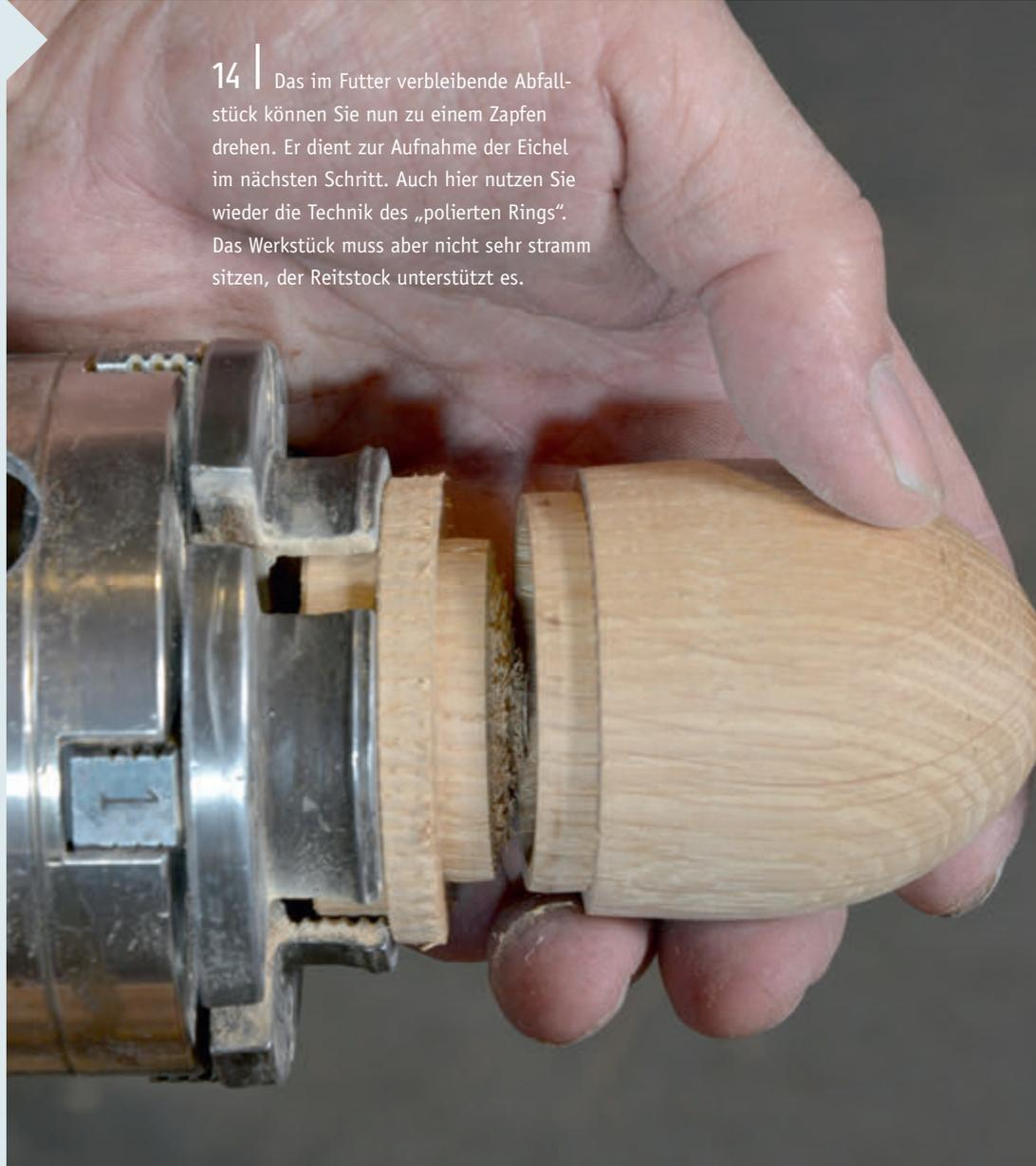
**14** | Das im Futter verbleibende Abfallstück können Sie nun zu einem Zapfen drehen. Er dient zur Aufnahme der Eichel im nächsten Schritt. Auch hier nutzen Sie wieder die Technik des „polierten Rings“. Das Werkstück muss aber nicht sehr stramm sitzen, der Reitstock unterstützt es.
