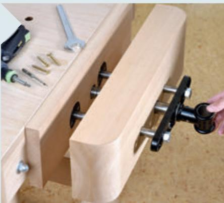
**23** | Auch die Löcher in der vorderen Spannbacke werden mit 5 mm Übermaß gebohrt. Schieben Sie sie dann auf die Stangen und drehen Sie mit der Spindel alles „handfest“ zu. Bringen Sie die Oberkante auf Plattenhöhe und schrauben Sie die vordere Backe fest.
