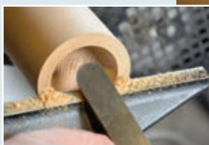
**2** Ein halbrunder 19-mm-Schaber mit frisch angeschliffenem Grat formt die Innenseite der Kappe ungefähr zur (Hohl-)Kugelform. Dadurch wird der Deckel leichter, was später beim Greifen stimmiger wirkt.
