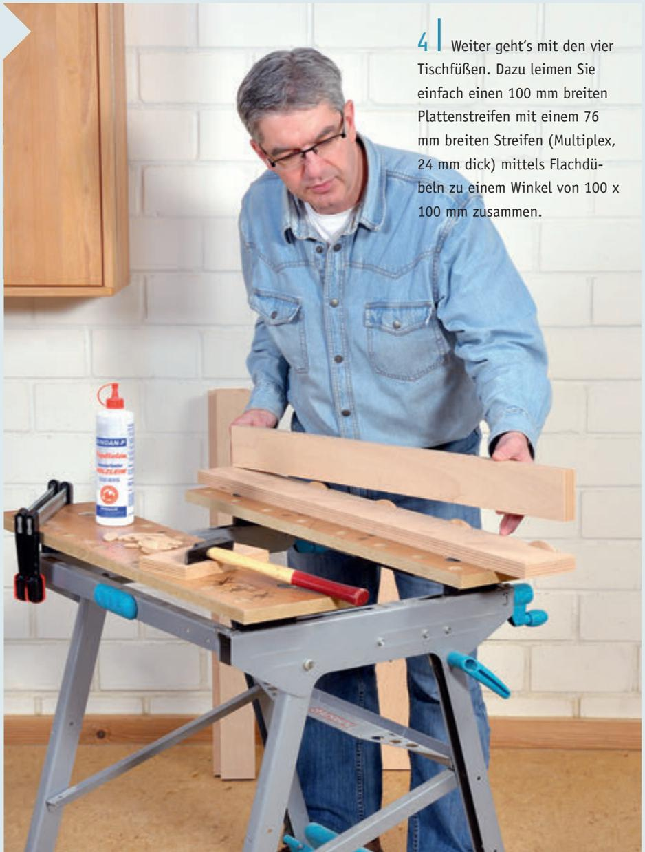
**4** Weiter geht's mit den vier Tischfüßen. Dazu leimen Sie einfach einen 100 mm breiten Plattenstreifen mit einem 76 mm breiten Streifen (Multi-plex, 24 mm dick) mittels Flachdübeln zu einem Winkel von 100 x 100 mm zusammen.
