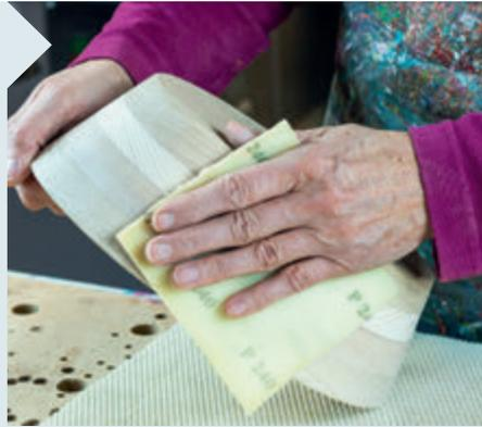
**6** Der obere Rand und die Unterseite der Schale werden maschinell fein geschliffen und die Kanten gerundet. Von Hand schließen Sie die Schleifarbeiten mit dem Schleifvlies (240er Körnung) ab und entfernen Sie den Staub mit einem trockenen Tuch oder per Sauger.
