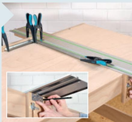
**16** | Um die Schiene exakt rechtwinklig zu justieren, legen Sie einen großen Präzisionswinkel an Anschlagplatte und Schienenkante. Dann stoßen Sie die „Nase“ des Metallverbinders dicht unter die Nut der Schiene und markieren sich die beiden großen Löcher.
