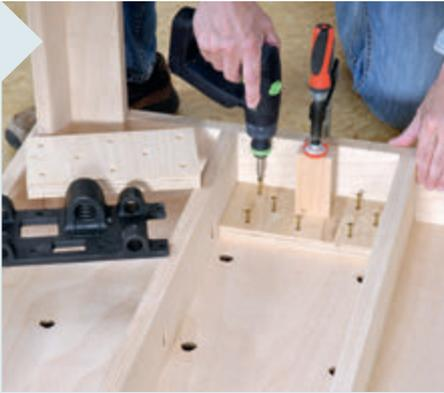
**18** | Schrauben Sie zwei 24 mm dicke Multiplexbretter (264 x 130 mm) dicht an der Querzarge anliegend zwischen die beiden Mittelzargen. Damit wird die schwarze Guss-Montageplatte der Spannzanze (links im Bild) unterfüttert und Sie haben mehr Einspanntiefe.
