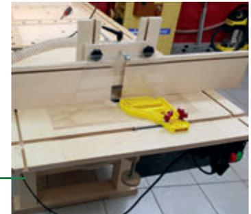
Der zentrale Multifunktions-tisch macht seinem Namen alle Ehre: Mit verschiedenen **Einlegeplatten** lassen sich einfach und schnell handge-führte Maschinen einspannen. Der **Frästisch** ist dabei eine der meistge-nutzten Varianten.
