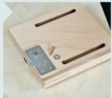
**17** | Danach den Verbinder mit zwei Schrauben und U-Scheibe festschrauben. Zum Schluss noch mal – nach der Methode aus Bild 16 – eine Feinjustierung des Metallverbinders vornehmen.
