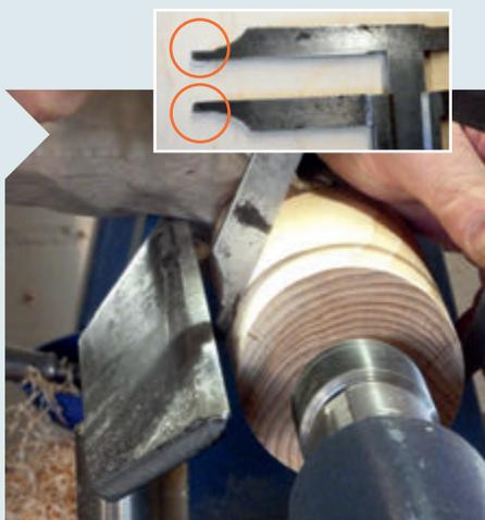
**7** Kontrollieren Sie mehrfach den Durchmesser. Wenn Sie das bei laufender Maschine tun möchten, sollten Sie die Schenkel des Messschiebers vorne innen abrunden. Drehen Sie nun hirnseitig einen Schwalbenschwanz-Zapfen an.
