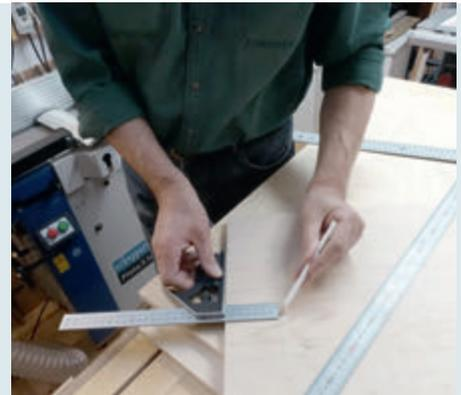
1 Zeichnen Sie nach dem Zuschnitt die Schlitzpositionen auf die Fronten. Am einfachsten ist eine ungerade Anzahl von Schlitzen. Der erste Schlitz kommt exakt in die Plattenmitte. Dann werden jeweils nach außen gleich viele Linien im gleichen Abstand gezogen.
