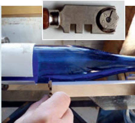
**1** Die Weinflasche mit umgelegtem Schutz (der Mantel einer aufgesägten Kunststoffdose) ist im Spannutter mit sehr wenig Druck eingespannt. Der Glasschneider wird seitlich an der Hilfsleiste gehalten und ans Glas geschoben. Die Hilfsleiste ist an der Handauflage festgespannt.
