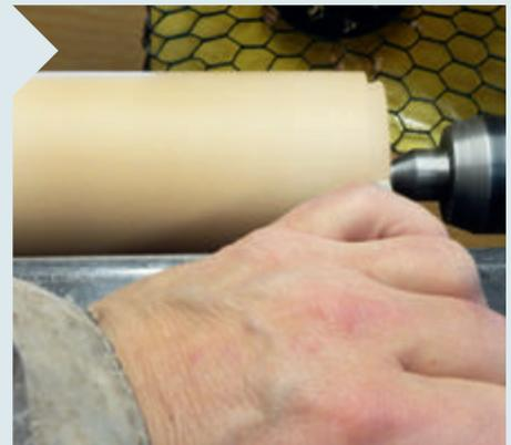
**11** Nach dem Umspannen und dem Aufnehmen des Werkstücks im Bohrloch wird die Unterseite abgestochen. Auch hier unterstützt die mitlaufende Körnerspitze.
