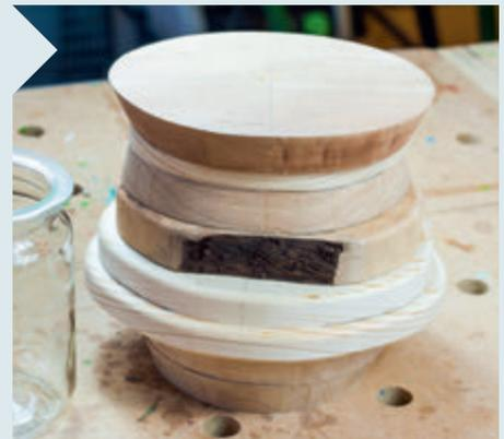
**9** Einige Ringe bringen auch einfach nur Höhe und verändern die Gesamtform nicht; sie werden ohne Winkel gesägt. Der hier gezeigte, abschließende siebte Ring aus Birnbaumholz erhält dagegen eine Schräge von 25°.
