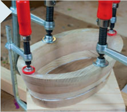
**5** Die Außenwand der Schale schleifen Sie am Band- oder Tellerschleifer. Bevor Sie mit dem Feinschliff beginnen, leimen Sie die Grundplatte auf. Ein kleiner Überstand von 1 - 2 mm hilft, um bündig zu schleifen, ohne den Winkel der Schale zu ändern.
