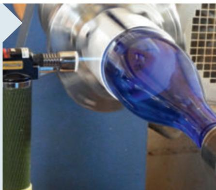
**2** Der kleine Bunsenbrenner ist durch einen Unterbau so an der Bank befestigt, dass seine Flamme genau auf die durch den Glasschneider erzeugte Schnittkante trifft. Die Flamme soll erst bei drehender Flasche auf den Riss treffen, um Hitzestau zu vermeiden.
