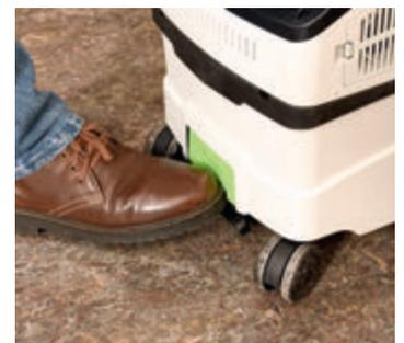
Ein praktisches Detail: Die Rollbremse, die mit dem Fuß aktiviert und gelöst werden kann.
