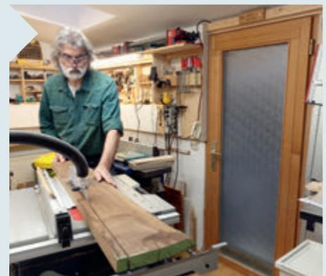
**12** Der Truhendeckel hat vorne eine Griffleiste aus Nussbaum. Nach dem Besäumen mit Handkreissäge und Führungsschiene wird die schmale Leiste an der Tischkreissäge mit verkürztem Anschlag von der Bohle abgetrennt. Anschließend auf Maß hobeln und ablängen.
