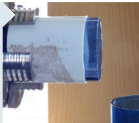
**3** Alles geschieht bei minimaler Drehzahl der Maschine. Achten Sie auf ein knisterndes Geräusch. Hier hat es geklappt, die Flasche ist getrennt. Die Schnittfläche ist recht sauber und weist wenig Ausbrüche auf. Sie ist aber dennoch sehr scharf!
