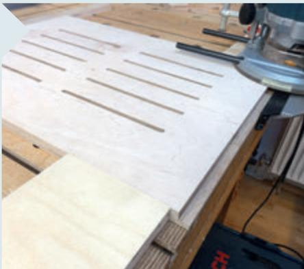
**6** Die Werkstückkante wird zum Fräsen des Falzes für die Bodenplatte an der Werkstückkante ausgerichtet und anschließend fixiert. Die Oberfräse liegt plan auf den Auflageplatten. Der Seitenanschlag wird zusätzlich von der Werkstückkante geführt.
