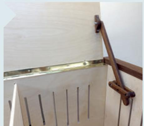
**18** Die Deckelstütze wird zwischen Leisten geführt, die ein 6 mm starkes Metallrohr halten, auf dem die Stütze steht. Zum Schließen des Deckels wird die Stützleiste per Hand ein Stück hoch- und dann vorgezogen.
