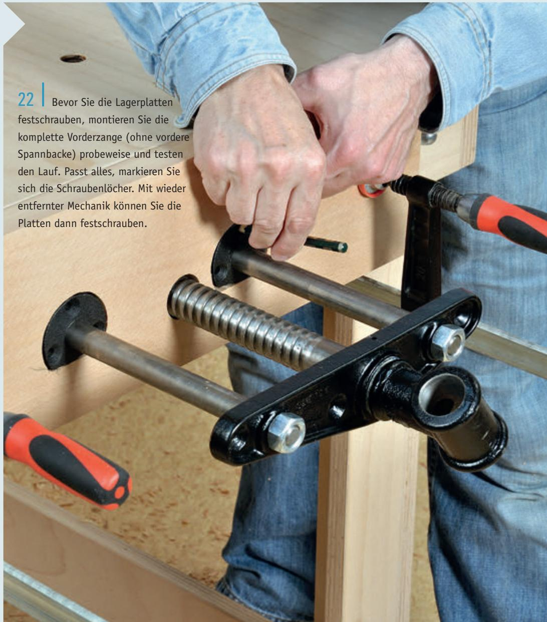
**22** | Bevor Sie die Lagerplatten festschrauben, montieren Sie die komplette Vorderzange (ohne vordere Spannbacke) probeweise und testen den Lauf. Passt alles, markieren Sie sich die Schraubenlöcher. Mit wieder entfernter Mechanik können Sie die Platten dann festschrauben.
