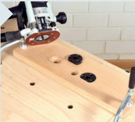
**21** | Mit der Oberfräse und einem 10-mm-Nutfräser lassen Sie die Lagerplatten bündig zur Brettfläche ein. Die Maschine können Sie dabei einfach freihändig von der Mitte nach außen hin bis an den Riss heranzuführen.
