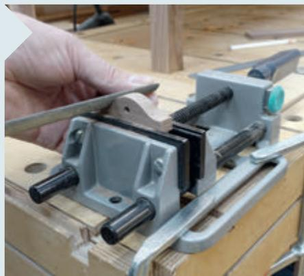
**17** ... und mit Raspel, Feile und Schleifmittel die Form fertig bearbeiten. Ähnlich verfahren Sie mit den restlichen Teilen für die Stütze. Die Enden der Stange und die Halterung an der Korpusseite erhalten Löcher für Schrauben und den Metallstift.
