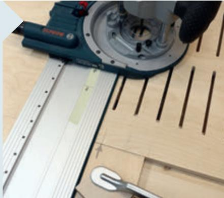
**4** Die Unterbrechung der Schlitzte wird durch Markierungen auf der Führungsschiene erleichtert. Erreicht der Führungsschiene-Adapter die erste Markierung, fahren Sie den Fräser hoch und setzen Sie ihn erst an der zweiten Markierung wieder ein.
