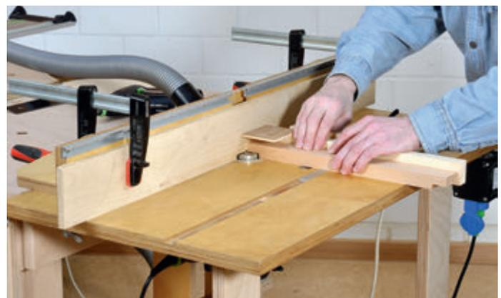
Vollwertige Frästischfunktionen: Falzen, nuten, profilieren oder Holzverbindungen herstellen - nur einige der zahlreichen Möglichkeiten, die Ihnen der angebaute Frästisch bietet.
