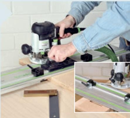
**9** Anschlagbretter, Schienenhalter und Schienenaufleger bekommen 10 mm breite Langlöcher. Die können Sie entweder mit der Oberfräse einfräsen. Oder Sie bohren an den Enden je ein 10-mm-Loch und verbinden die beiden mit der Stichsäge zu einem Langloch.
