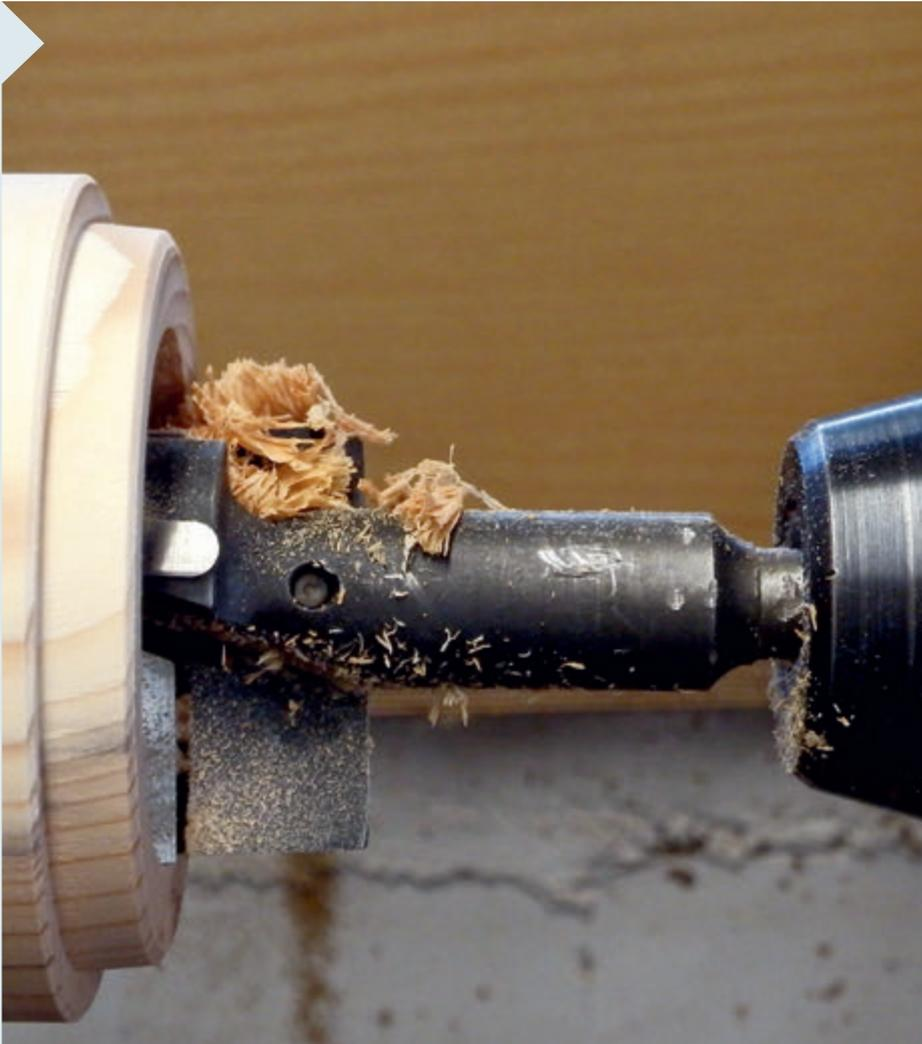
**9** Um das Flaschenoberteil leicht aufsetzen zu können, ist dieser kleine 8-mm-Falz konisch geformt. Der Unterteil-Rand wird mit einer kleinen Fasse versehen. Flaschen sind nicht immer perfekt rund, und so fallen ungleichmäßige Übergänge kaum auf. Bohren Sie dann für die Aufnahme des Teelicht-Glases.
