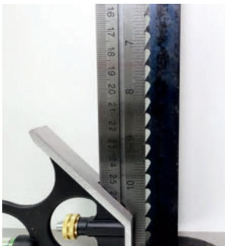
Bei Bandsägebändern wird die Anzahl der Sägezähne in „Zähne pro Zoll“ (ZpZ) oder in „Teeth per Inch“ (TPI) angegeben. Dieses Band hat 4 ZpZ. Für den optimalen Späneauswurf sind die runden Zahngründe wichtig.
