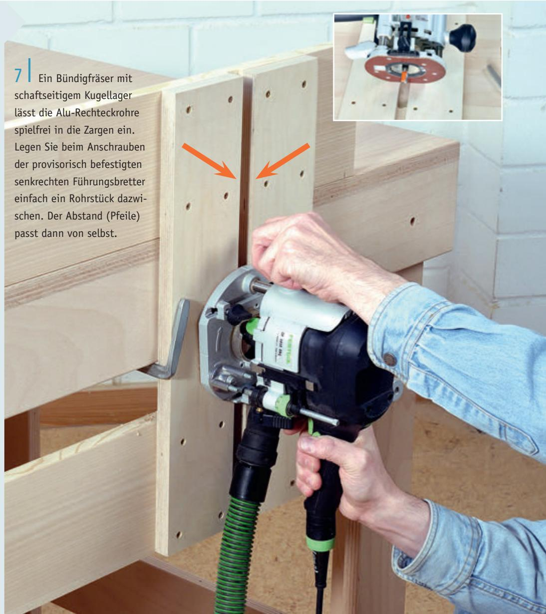
**7** Ein Bündigfräser mit schaftseitigem Kugellager lässt die Alu-Rechteckrohre spielfrei in die Zargen ein. Legen Sie beim Anschrauben der provisorisch befestigten senkrechten Führungsbretter einfach ein Rohrstück dazwischen. Der Abstand (Pfeile) passt dann von selbst.
