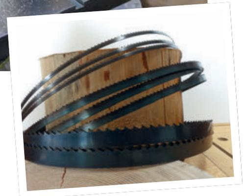
von dickem Holz sollte das Bandsägeband möglichst breit sein. Für Bogenschnitte benutzt man schmale Bänder. Je enger der Bogen, desto schmaler das Bandsägeband.
