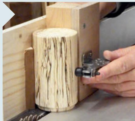
**13** Das Werkstück ist eingespannt und kann nun sicher am Parallelanschlag der Kreissäge genutet werden. Um die Nutbreite zu erreichen, wird der Anschlag nach dem ersten Schnitt um Sägeblattstärke verstellt.
