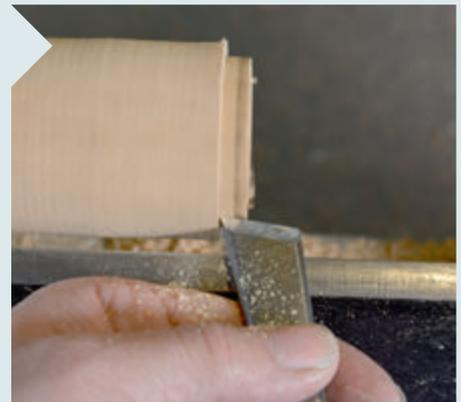
**9** Der liegende Flachmeißel nimmt nun links vom polierten Ring noch einen oder zwei Zehntelmillimeter weg. So wird die Kontaktfläche vermindert, was später ein zu starkes Klemmen verhindert. Danach säubern Sie das Eichelinnere mit einem Schaber und schleifen dort.
