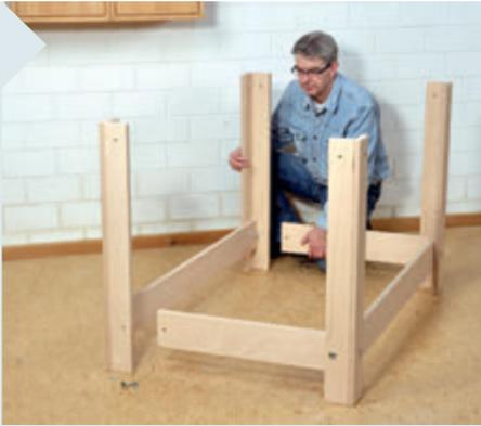
**6** Zum Zusammenbau verbinden Sie zuerst die beiden Längsschwingen mittels Schlossschrauben, U-Scheiben und Muttern mit je zwei Füßen. Erst danach stecken Sie auch die Querschwingen auf. Ganz zum Schluss legen Sie dann noch die Tischplatte auf die Füße – fertig.
