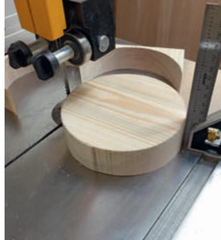
Aus einem 40 mm dicken Holz schneidet das Uddeholm-Bandsägeband 10 x 0,5 mm 6 ZpZ eine Scheibe mit 140 mm Durchmesser. Das klappte perfekt. Die Kanten sind exakt rechtwinklig geworden.
