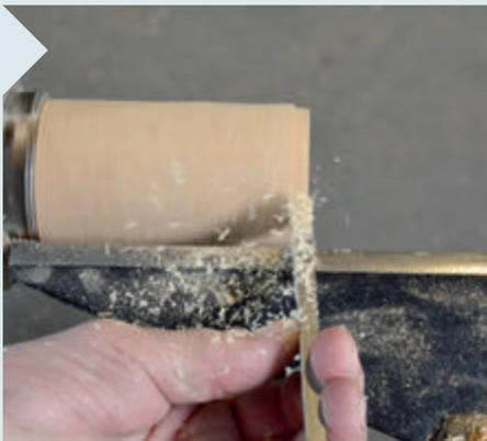
**7** Formen Sie nun auch den Eichelrohling wie zuvor die Kappe nach Maß aus. Mit dem 6-mm-Abstecher legen Sie dann den Falz leicht schräg an. Achten Sie auf den ca 95°-Winkel zur Handauflage im Bild, diese steht hier parallel zum Bankbett. Der Falz wird 7 mm breit.
