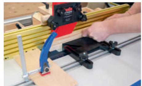
Die doppelte Nut ist sehr praktisch. Nicht nur selbstgebaute Vorrichtungen, sondern auch eine Vielzahl von Druckfedern und Anschlägen unterschiedlicher Hersteller können mitunter sogar gleichzeitig eingesetzt werden.
