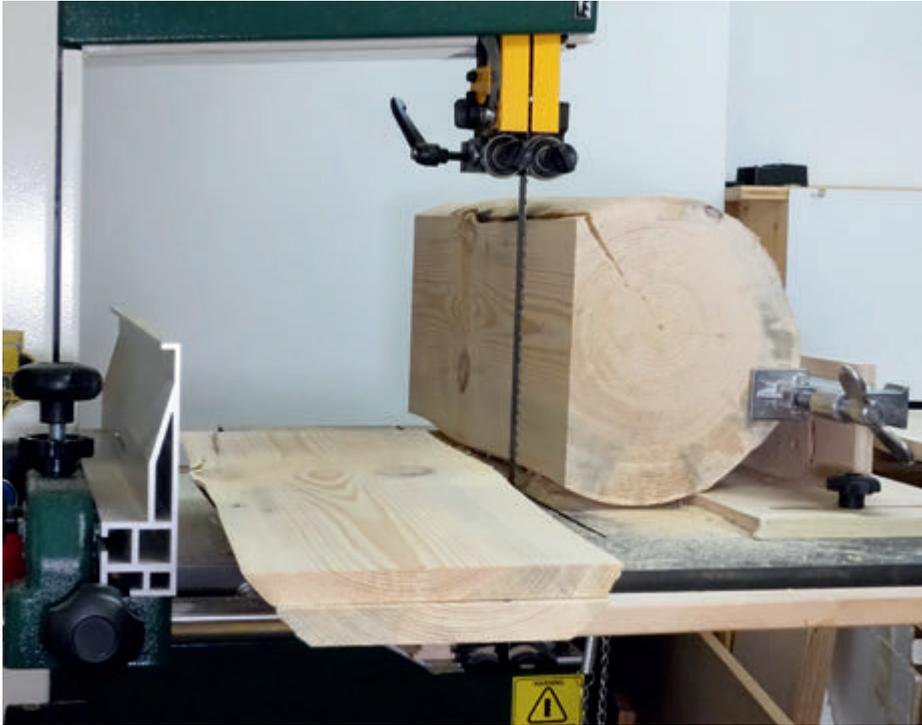
Längsschnitt durch den Fichtenstamm mit RRR-Plus 20 x 0,8 mm, 3 ZpZ. Die Bretter sind durchgehend gleich dick und absolut gerade. Das Werkstück wird mit einer Längsschnitt-Spannlade geführt.
