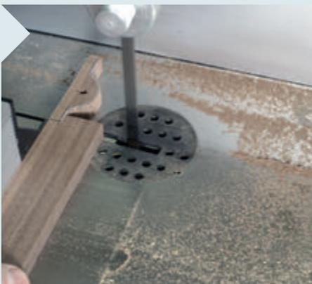
**16** Die geschwungene Form wird an der Bandsäge grob herausgesägt. Die mit dem Winkelanschlag geführte Leiste wird dabei immer wieder ins Sägeblatt bis zur Markierung geschoben, bis die Form fertig ist. Dann das Teil absägen, ...
