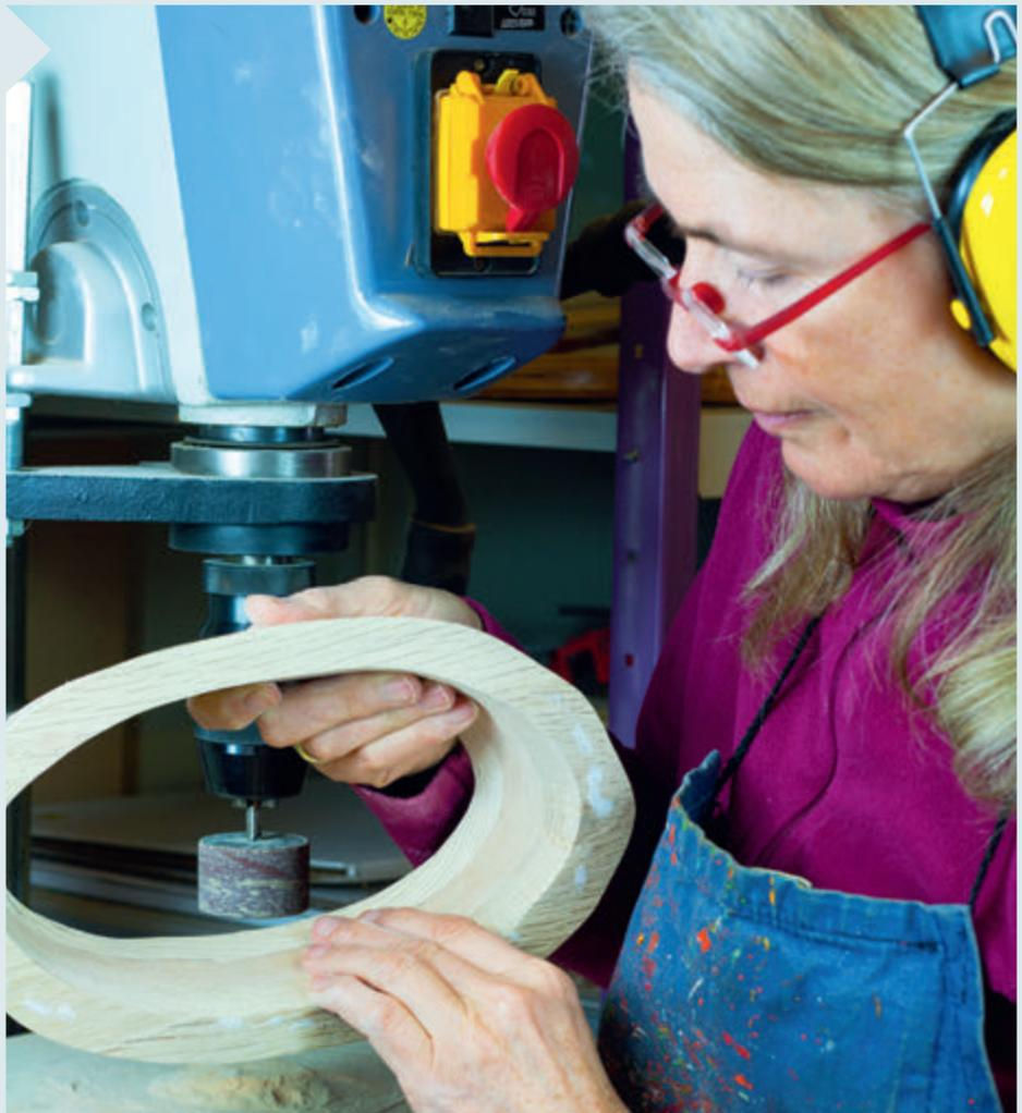
**4** Der Leim braucht mindestens 3 - 4 Stunden Trocknungszeit. Derweil können Sie schonmal die Grundplatte fein schleifen. Ist der Leim trocken, können Sie die Innenwand mit wenig Druck an der Ständerbohrmaschine mit einer Schleifhülse (Drehzahl: 700 U/min) glätten. Kontrollieren Sie die Rundung mehrfach, bis Sie mit dem Ergebnis zufrieden sind.
