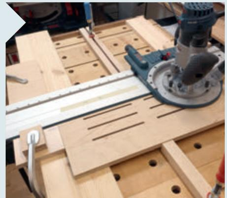
2 Zwei ca. 1.200 mm lange Auflagebretter schützen die Werkbank beim Fräsen, darauf liegen Führungshölzer für die Platte und dazu rechtwinklig die Führungsschiene für den Fräser. Zwei Stoppleisten begrenzen den Fräsweg, zwei weitere fixieren die Platte vorne und hinten.
