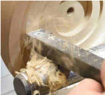
Auch Schaber mit Wechselklingen werden „hängend“, also leicht abwärts weisend, eingesetzt.
