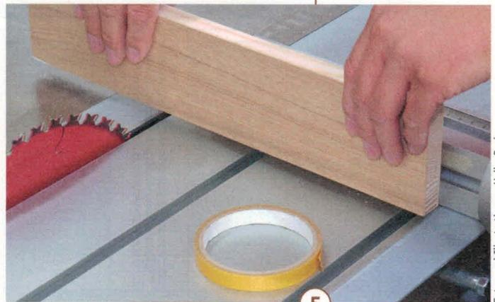
**5** Damit die Überblattungen am Fußgestell ausrissfrei werden, befestigen Sie ein Opferholz am Queranschlag. Kleben Sie es mit doppelseitigem Klebeband an das Anschlagprofil. Das Opferholz kann auch etwas kürzer als Ihre Werkstücke sein.
