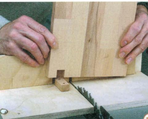
11 > Um den zweiten Schlitz zu erstellen, legen Sie wieder das Abstands Brett an den Anschlag. Der Dübel ist dadurch wieder abgedeckt. Jetzt lässt sich der erste Schlitz auf das Registerholz stecken. Er sollte spielfrei sitzen. Tut er das beim ersten Testdurchgang nicht, sollten Sie die Maße und Abstände an Ihrer Vorrichtung prüfen und korrigieren.
