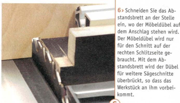
6> Schneiden Sie das Abstands Brett an der Stelle ein, wo der MöbeldüBEL auf dem Anschlag stehen wird. Der MöbeldüBEL wird nur für den Schnitt auf der rechten Schlitzseite gebraucht. Mit dem Abstands Brett wird der DüBEL für weitere Sägeschnitte überbrückt, so dass das Werkstück an ihm vorbeikommt.
