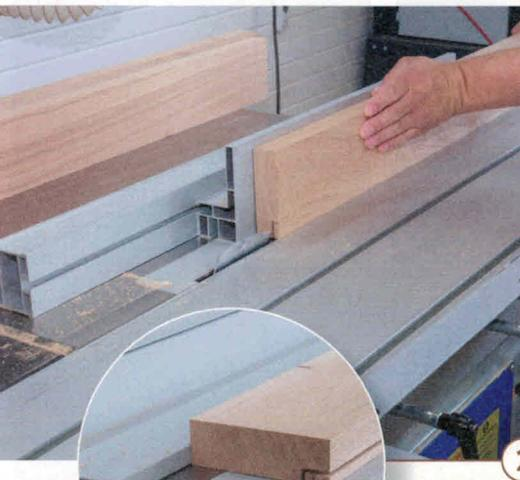
**2** Vor dem Ablängen der Rahmenteile für die Tischplatte werden die Fälze geschnitten. Schneiden Sie die Rahmenteile zuerst hochkant, dann flach. Der herausgetrennte Abfall kann sich bei dieser Arbeitsweise nicht zwischen Sägeblatt und Parallelanschlag verklemmen.
