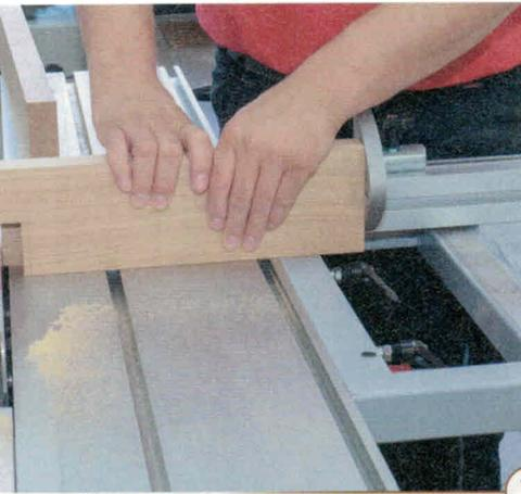
**7** > Schnitt für Schnitt arbeiten Sie sich nun an die endgültige Breite der Überblattung heran. Wenn Sie sich an einem der beiden Teile die genauen Maße aufgezeichnet haben, erleichtert das die Arbeit sehr. Wenn Sie sich dem endgültigen Maß nähern, verstellen Sie den Anschlagreiter nur noch ganz wenig.
