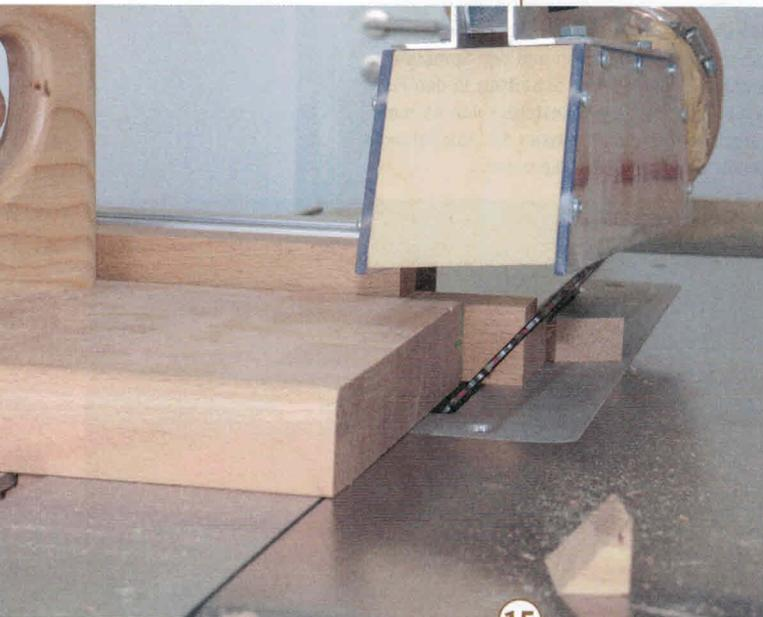
**15** > Damit unter dem Tisch keine scharfen Kanten und spitzen Ecken sind, schneiden Sie die Enden der Sprossen auf einen Winkel von 45° ab. Diese Abschrägung dürfen Sie aber nicht zu groß machen, da an dieser Stelle später noch gebohrt und geschraubt werden muss.
