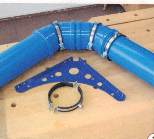
1> Verbinden Sie die beiden 45°-Bögen mit einem kurzen Stück Rohr. Zusammen mit zwei Rohrstücken mit etwa einem Meter Gesamtlänge, vier Schellen und zwei Regalkonsolen bilden sie den Arm für die Absaughaube.
