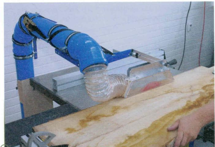
Kennzeichen einer Formatkreissäge: Der Schiebeschlitten läuft unmittelbar am Sägeblatt entlang. Dadurch sind Besäumschnitte an Bohlen und Plattenwerkstoffen besonders einfach und sehr sicher.
