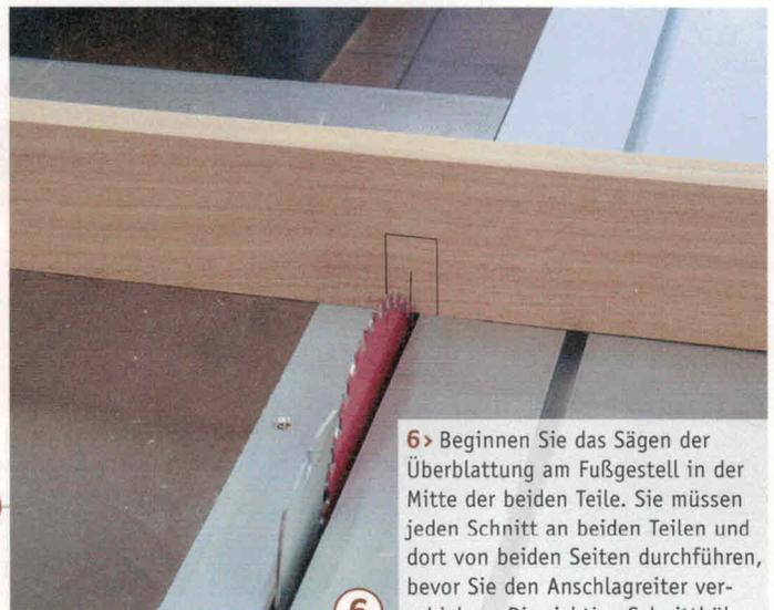
**6** Beginnen Sie das Sägen der Überblattung am Fußgestell in der Mitte der beiden Teile. Sie müssen jeden Schnitt an beiden Teilen und dort von beiden Seiten durchführen, bevor Sie den Anschlagreiter verschieben. Die richtige Schnitthöhe stellen Sie zuvor an einem Reststück genau auf 50 mm ein.
