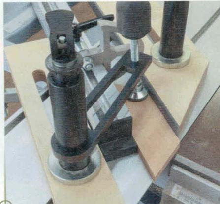
„Fritz und Franz 2.0“ können Sie auch für das Sägen kleiner Werkstücke verwenden. Hilfsanschläge, Niederhalter und Schwenkspanner können dabei zusammen mit den Anschlägen der Maschine genutzt werden.
