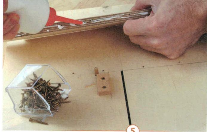
5> Exakt im rechten Winkel zum Sägeschnitt wird in der Mitte des Grundbretts der Anschlag erst geleimt, dann von unten verschraubt.
