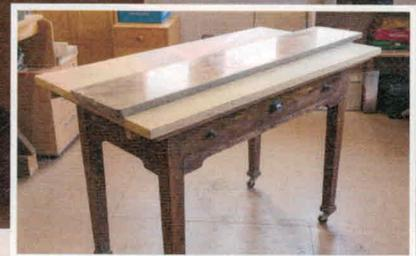
In der Mitte der Werkstatt steht ein schlichter **mobiler Arbeitstisch** mit Rollen. Darauf liegt ein ausgedienter **Fenstersims**, mit Trennmittel eingeschmiert. Er dient als Leimunterlage, wenn Grüble-Schwartenbeck Furniere für Mosaik einleimt. Gereinigt wird er einfach mit dem Spachtel. Leim- und Schnitzarbeiten finden im Winter aber auch im Arbeitszimmer am Kachelofen statt.
