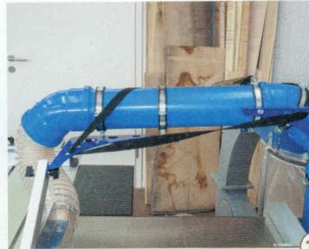
11 > Ein Spanngurt verleiht sowohl dem Arm als auch der Halterung für die Haube Stabilität. Er wird so um die Rohrschellen gelegt, dass der Gurt die Halterung für die Haube nach oben zieht und er gleichzeitig Druck auf den Absaugarm ausübt. So können die Segmente nicht auseinanderdrutschen.
