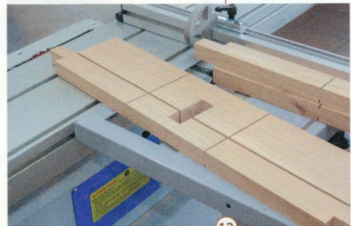
**12** > Die Breite der Aussparungen entspricht ganz genau der Breite der aufrechten Fußteile (Pos. 4). Die Schnitte in den Fußteilen und in den Sprossen werden direkt hintereinander gemacht, immer mit derselben Einstellung.
