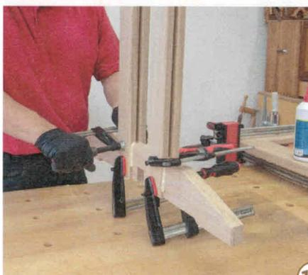
**18** > An die beiden TischfüÙe leimen Sie die aufrechten Teile an. Damit der Abstand auch oben stimmt, stecken Sie beim Verleimen die Streben ein. Der austretende Leim wird nach dem Aushärten mit einem scharfen Stemmeisen entfernt.
