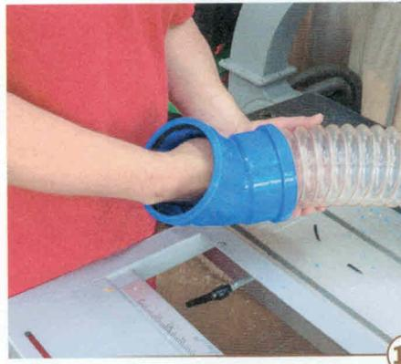
10 > Vor dem Aufschieben des 45°-Winkels auf den Arm kann der Flexschlauch eingesetzt werden. Das geht am besten, wenn man durch das Rohr greift und den Schlauch nach innen zieht. Die Gummidichtung im Rohrbogen hält den Schlauch fest und dichtet ihn ab.
