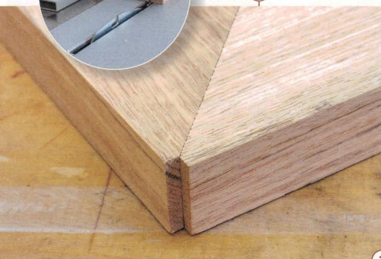
**3** Lassen Sie die Rahmenteile noch einige Zentimeter länger und schneiden Sie an alle Enden eine 45°-Gehrung an. Legen Sie den Rahmen zusammen. Wenn alle Ecken dicht werden, passt der eingestellte Winkel. Später bekommen alle Gehrungen noch eine Fase, was zusammen eine Schattenfuge ergibt.
