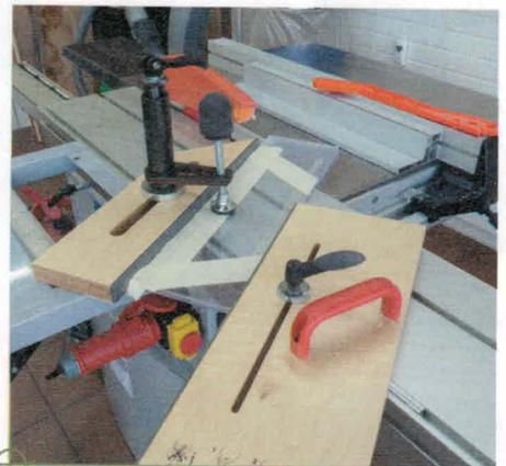
Mit einem Hilfsanschlag, einem Niederhalter und dem Zuführanschlag lassen sich auch schwierige Schnitte nach Anriss sehr sicher durchführen. Sowohl „Fritz“ als auch „Franz“ sind mit gummierten Kanten versehen.
