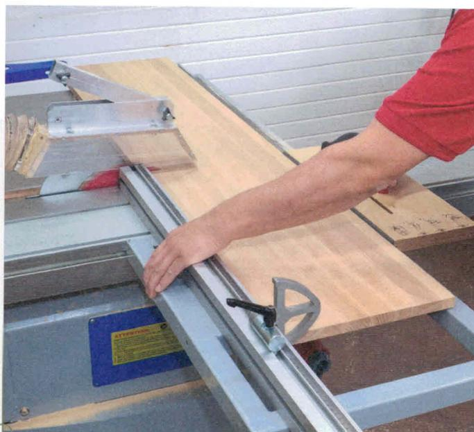
Im Gegensatz zu den meisten Tischkreissägen mit Schiebetisch sind auf einer Formatkreissäge auch Querschnitte an großen Werkstücken kein Problem. Der Queranschlag kann bei Bedarf auf über 2.000 Millimeter ausgezogen werden.
