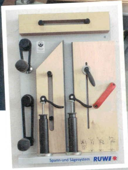
Das Besäumen von Massivholzbohlen wird mit Niederhaltern und Hilfsanschlag besonders sicher. Auch krumme Bohlen werden damit auf dem Formattisch gehalten. Alle Einzelteile hängen gut sortiert und griffbereit an der Wand.
