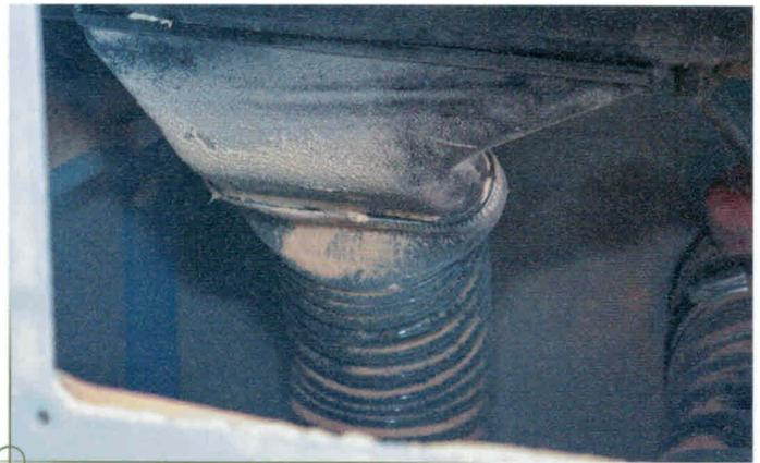
Ein Engpass direkt am Sägeblattkasten wie hier verschlechtert die Absaugung. An dieser Stelle sammeln sich auch immer wieder kleine Abschnitte und verstopfen den Absaugkanal.
