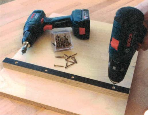
1> Die genaue Position der Führungsschiene unter der Grundplatte orientiert sich am Modell Ihrer Tischkreissäge. Ziel ist, dass links und rechts vom Sägeblatt gleich viel Platte liegt. Wenn Sie die Platte stattdessen am Gehrungsanschlag befestigen, müssen Sie sie mitunter länger lassen.
