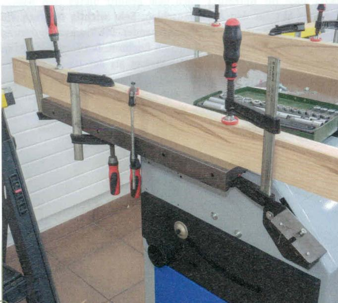
Die Tischverbreiterung wiegt über 30 Kilogramm. Einfach festhalten und anschrauben geht da nicht. Bedienen Sie sich beim Aufbau daher einiger Hilfsmittel wie Kanthölzern, Zwingen und Unterstellböcken.
