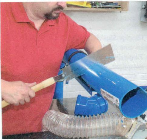
9 > Schneiden Sie jetzt das quer verlaufende Rohr des Absaugarmes auf Länge. Das geht sehr gut mit einer Japansäge. Die Länge des Armes wird so festgelegt, dass die Haube genau über dem Sägeblatt positioniert ist. Der 45°-Rohrbogen muss dabei berücksichtigt werden. Jetzt kann auch die Länge des Flexschlauches zur Absaughaube hin gemessen werden.
