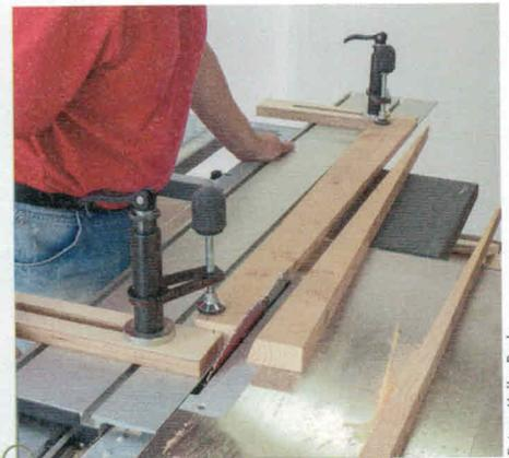
Vor allem bei nicht alltäglichen Arbeitsgängen wie solch langen Schifterschnitten spielt das Spann- und Sägesystem von Ruwi seine Stärken aus. Ein solcher Arbeitsgang ist damit sicher und präzise durchführbar. Die Schutzhaube wurde für das Foto entfernt.
