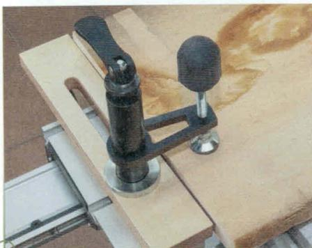
Wenn Sie unter den Schwenkspannern immer einen Hilfsanschlag montieren, schonen Sie die Oberfläche des Formattisches. Das kann gerade bei kleinen Maschinen mit schwächer gebautem Schiebeschlitten nötig sein, denn die Schnellspanner üben enorme Kräfte aus. Außerdem ersparen Sie sich so auch das ständige Umstellen der Schwenkspanner.
