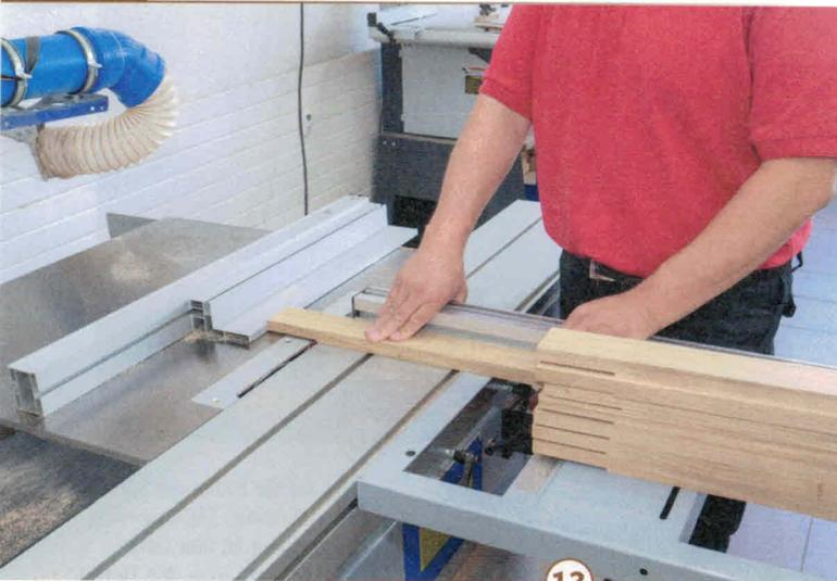
**13** > Für eine wirklich stabile Verbindung mit viel Leimfläche und möglichst gutem Formschluss bekommen auch die aufrechten Rahmenteile je noch eine Aussparung an den beiden Enden. Sie ist drei Millimeter tief, am oberen Ende des Bauteils 50 mm und unten 90 mm lang.
