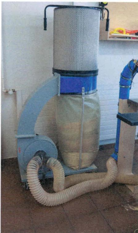
Auch kleine Formatkreissägen brauchen eine ordentliche Absaugung. Wir raten Ihnen zu einer Anlage mit einem Luftdurchsatz von mindestens 1.500 m<sup>3</sup>/h und einer Filterpatrone.
