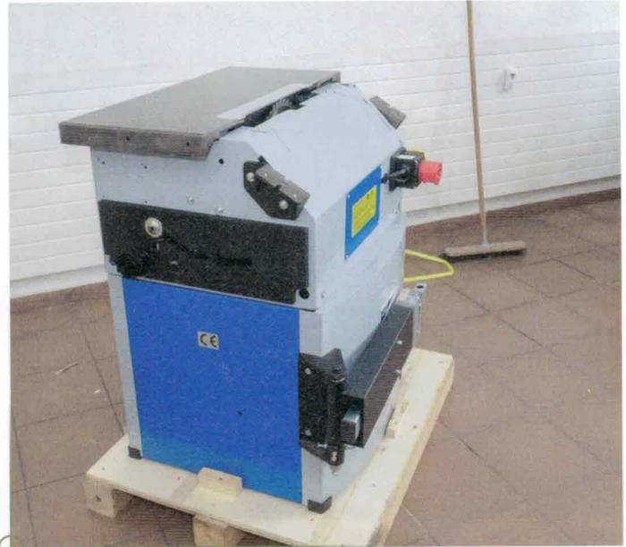
Das schwerste Teil bei unserer Maschine war der Grundkörper mit dem Sägeaggregat. Aber auch der ist kompakt und mit knapp 100 Kilogramm noch zu handhaben. Einen Helfer sollten Sie sich für den Aufbau dennoch organisieren.
