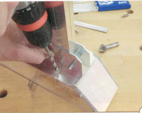
7 > Die Haube selbst ist so breit, dass die langen Alu-Winkel (Pos. 6) nicht überstehen, nachdem sie befestigt sind. Das Alu-Vierkantrohr dient beim Vorbohren als Abstandhalter. Eine eingesteckte Schraube hält die beiden Winkel in der Flucht. Die Winkel werden mit Schrauben und Muttern an der Haube befestigt.
