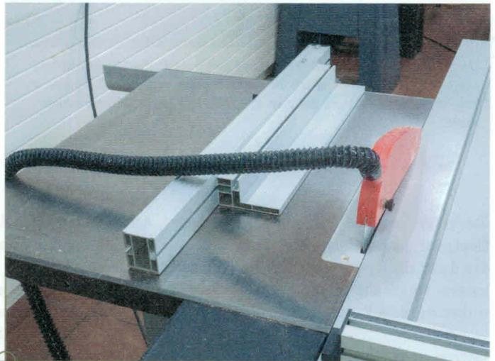
Der sehr dünne Schlauch zur Absaughaube zweigt vom Absaugschlauch mit 100 Millimetern Durchmesser ab. An der Haube kommt danach nicht mehr viel Saugleistung an. Das ist einer der Hauptgründe für die schlechte Absaugung.
