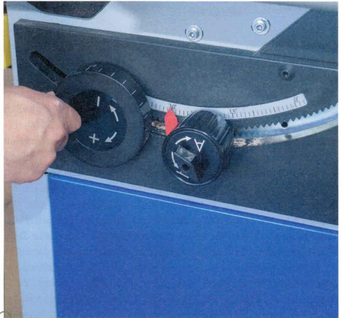
Die Höhen- und Winkelverstellung sollten Sie regelmäßig reinigen, aber nach Möglichkeit nicht fetten. Sie setzt sich immer wieder mit Staub und Spänen zu und wird dann schwergängig.
