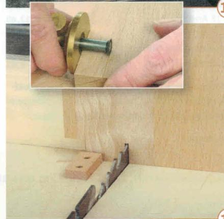
15 > Das erste Brett ist geschlitzt. Den ersten, außen liegenden Schlitz des folgenden Brettes müssen Sie mit 20 mm anzeichnen. Sägen Sie dann nach Anriss. Alle weiteren Schlitzes ergeben sich durch den Einsatz der Vorrichtung wie oben beschrieben.
