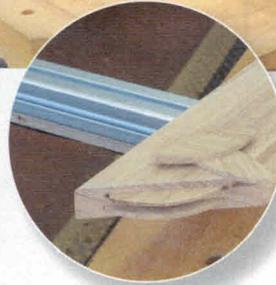
**17** > Der Rahmen wird mit einigen Schraubzwingen verleimt. Die Eckverbindung ist einfach mit selbst gemachten Flachdübeln realisiert. Die Flachdübel sind aus Eichenholz selbst angefertigt – beachten Sie den diagonalen Faserverlauf! Nach dem Abbinden des Leimes wird der Rahmen noch geschliffen.
