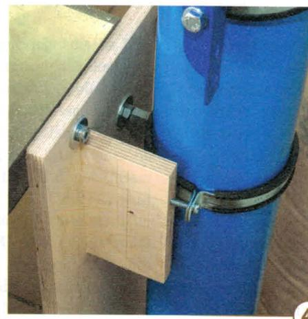
4> Der Absaugarm ist mit zwei Rohrschellen an der Unterkonstruktion befestigt. Damit sich der komplette Arm nicht drehen kann, werden Klötzchen zwischen die Unterkonstruktion und die Schrauben der Rohrschellen gesetzt.
