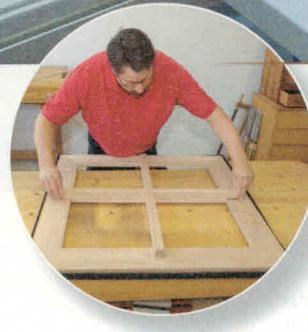
**10** > An die Enden der Sprossen schneiden Sie eine Ausparung von 20 mm Tiefe und 50 mm Länge. Die Tiefe von 20 mm entspricht genau dem Maß, das bei den Rahmenhölzern der Platte noch am Falz stehen geblieben ist. Wenn Sie die beiden Teile zusammenlegen, müssen sie bündig sein.
