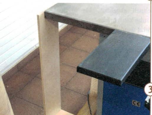
3> Bei Ihnen kann eine andere Lösung sinnvoll sein, wir befestigen den Arm an einer Konstruktion aus Multiplex. Die Bodenplatte ist dabei sehr wichtig. Sie gibt dem Ganzen den notwendigen Halt und der Arm steht stabil an der Säge.
