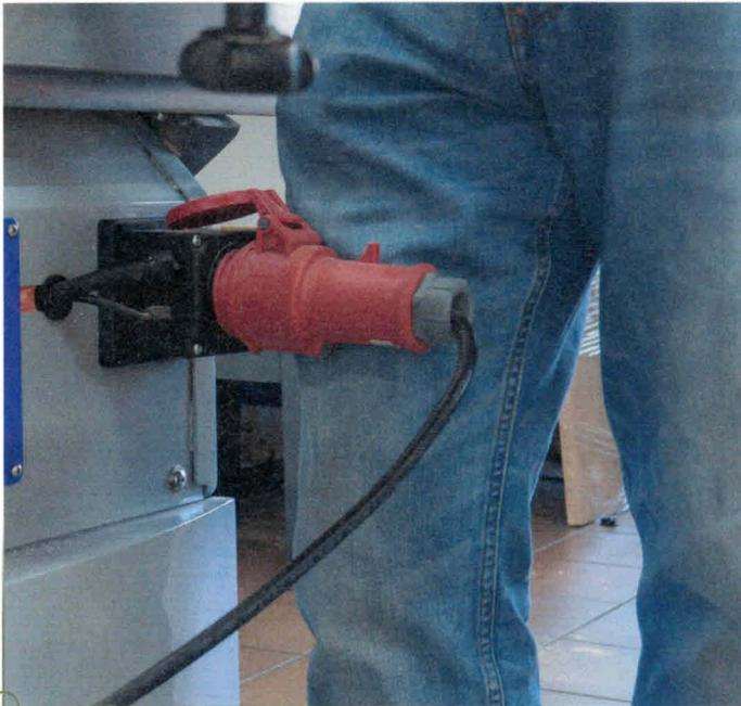
Man fragt sich ernsthaft, wer so etwas konstruiert. Der Stromanschluss stört beim Sägen. Wäre er um 90° gedreht, täte er das nicht. Es gibt einige dieser Kuriositäten, die man aber mitunter leicht selbst beheben kann.
