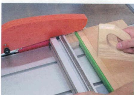
Sie können auf einer großen Maschine auch kleine Werkstücke sicher und genau zuschneiden. Die selbst gebaute Hilfsvorrichtung "Fritz und Franz" macht's möglich. (siehe auch *HolzWerken* 67)
