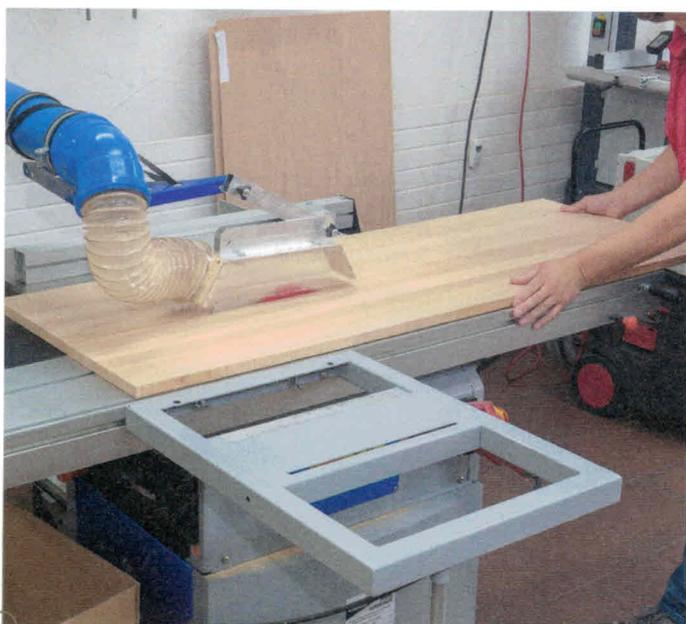
Durch den großen Maschinentisch und sehr stabile Anschläge ist auch der Zuschnitt von größeren Platten mit einer kompakten Formatkreissäge möglich. Die meisten Maschinen erlauben Längsschnitte bis 600 Millimeter Breite.
