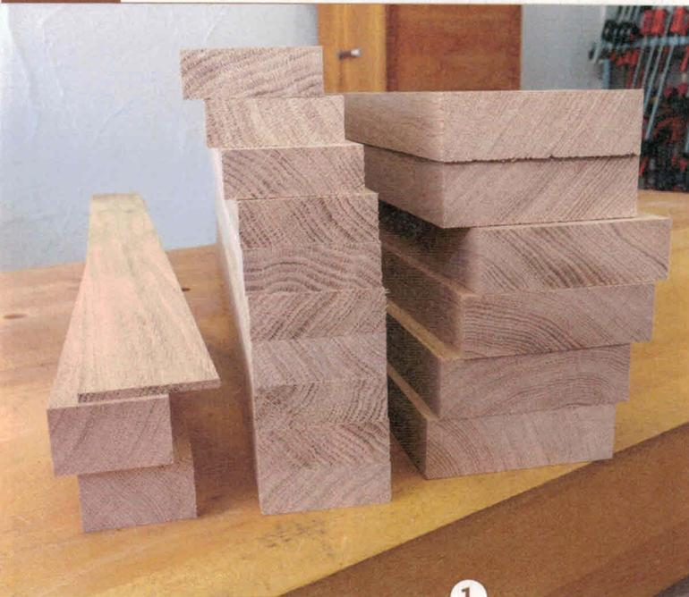
**1** Das Holz müssen Sie selbst aushobeln. Achten Sie bei der Auswahl darauf, kein Splintholz an den Stücken zu belassen, es ist nicht für den Außenbereich geeignet. Ihr Holz darf auch keine Risse oder offenen Äste aufweisen, in die Wasser eindringen wird.
