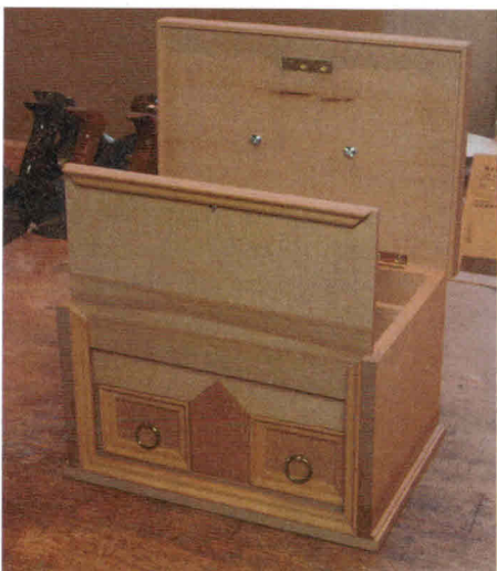
Durch Hochziehen des Schiebers, der vor der vorderen Zarge sitzt, werden die drei kleinen Schubkästen im unteren Teil freigelegt.
