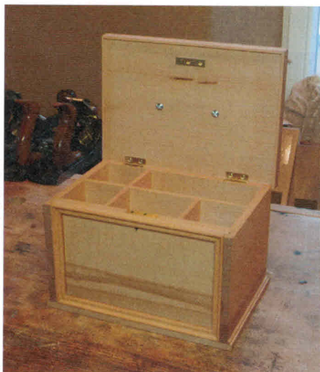
Direkt unter dem Deckel befinden sich fünf kleine Fächer. Der Deckel selbst ist mit kleinen Scharnieren am Korpus befestigt. Das Schloss sitzt in der vorderen Zarge.
