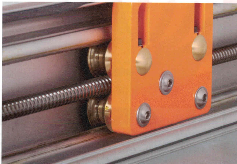
Die Y-Achse der Stepcraft 2/420 wird auf Rollen über Führungsschienen geführt. Zwischen den Rollen verläuft die Gewindestange. Die Spindelmutter, die auf der Gewindestange aufgeschraubt ist, liegt hinter der orangefarbenen Halterung.
