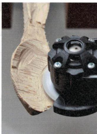
Hier rotiert die „Mini Grinder Blade“ aus gehärtetem Stahl. Kleine konkave Formen wie bei diesem Löffel schafft sie mühelos, auch wenn hinterher noch eine Feinbearbeitung nötig ist.
