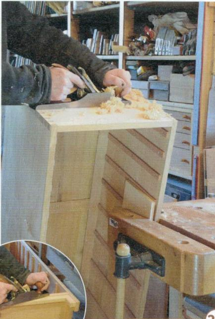
26 > Der Korpus wird abschließend von Hand mit dem Hobel (Eisen vorher noch einmal abziehen!) geputzt. Bei Bedarf können Sie auch eine Ziehklinge oder etwas Schleifpapier zu Hilfe nehmen. Schwierige Maserungen schafft der Hobel leichter und sauberer, wenn die Fläche etwas angefeuchtet wird.
