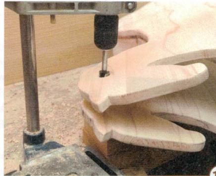
14 > Durch Unterlegen mehrerer Klötze werden die Löcher für die Haltestangen mit einem 20 mm Forstnerbohrer gebohrt. Sorgen Sie dafür, dass auch zwischen den Seitenteilen Abstandsklötzchen für den richtigen Bohrwinkel sorgen.
