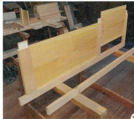
15 > Die Rückwand mit zwei Füllungen wird auf einer geraden Unterlage verleimt. Drei Zwingen parallel zu den Riegeln (Pos. 8 & 9) reichen für die Verleimung aus. Achten Sie darauf, dass der Rahmen plan ist.
