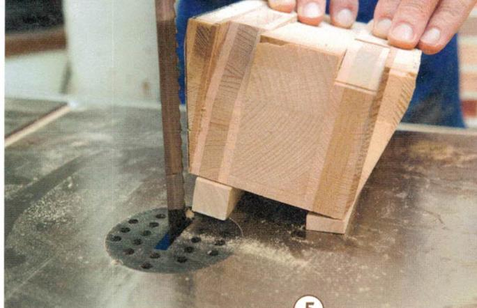
5 > Durch Unterlegen und Anschrauben einer 2 x 2 cm dicken Leiste entsteht der Schnittwinkel von 82° für das Sägen des Mittelteils. Beim zweiten Schnitt an der gegenüberliegenden Seite muss, da nun ein Teil der Auflage auf dem Sägetisch wegfällt, eine zusätzliche Leiste von etwa 5 mm an der dem Sägeblatt abgewandten Seite untergeschraubt werden.
