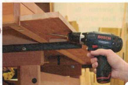
**9** > Auf zur Endmontage: Schrauben Sie den Boden an die Hinterkante der Hobelbankplatte. Die Flachdübel geben die Richtung vor. Ein kleines, zugeschnittenes Stück der 12-mm-Hilfsplatte (siehe Bilder 2 und 3) wird als zusätzliche Lastübertragung aufs Eisen geklebt.
