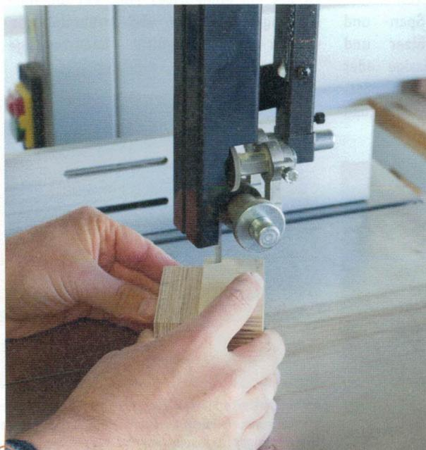
9> Zum Schluss können Sie der Vorrichtung noch mit der Bandsäge und dem Bandschleifer eine gefällige Form geben. Dadurch wird es auch möglich, den Tisch auch mit angebrachtem Sauganschluss zu kippen.
