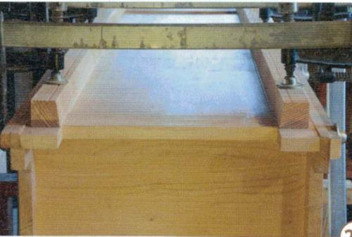
25 > Nun kann die Rückwand in den vorbereiteten Falz am Korpus geleimt werden. Sie springt an der Rückseite des Korpus um 2 mm zurück.
