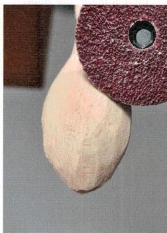
Der Mini-Grinder bietet auch die Möglichkeit zur Feinbearbeitung von K 40 bis K 120. So ist auch die abschließende Bearbeitung von Oberflächen kein Problem.
