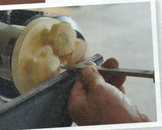
Langholz. Damit diese schön griffig werden, bekommen sie in Schritt zwei ihre Griffkerben. Dafür werden sie mit der bereits eingeklebten Gewindestange auf einem Karussell aufgespannt und als Gruppe sechs Mal gedrechselt – und zwischendurch um 60° gedreht.
