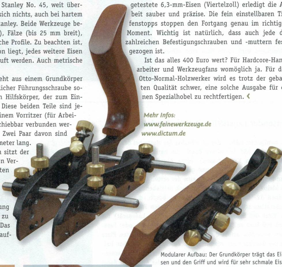
Modularer Aufbau: Der Grundkörper trägt das Eisen und den Griff und wird für sehr schmale Eisen alleine verwendet. Der Hilfskörper daneben wird über die Führungsstangen herangeschoben, ebenso wie der Anschlag mit seiner Holzleiste.
