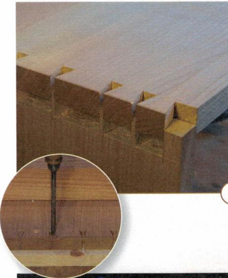
**3** Arbeiten Sie erst die Zinken, dann die Schwalben aus. Schlagen Sie die Verbindung nach dem Ausstemmen probeweise ein paar Millimeter zusammen. Sitzt die Passung zu stramm, können Sie an diesen Stellen noch einmal nacharbeiten.
