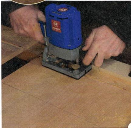
**4** Der Boden wird in die Seiten gegratet. Fräsen Sie erst mit einem normalen Nutfräser eine etwas schmalere Nut, damit haben Sie schon den Großteil des Materials entfernt. Ohne Gratfräser in der benötigten Breite müssen Sie danach zweimal fräsen. Verwenden Sie hierzu eine Zulage in entsprechender Breite.
