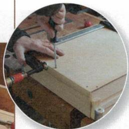
22 > Prüfen Sie nach dem Ausspannen den Schubkasten nochmals auf Winkligkeit, bevor Sie den Boden aufschrauben.
