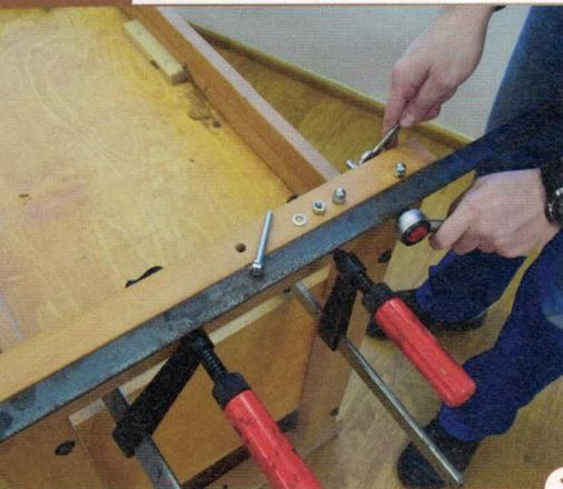
**1** > Zur besseren Sicht ist hier die Bankplatte an der bestehenden Hobelbank entfernt. Durchbohren Sie die Winkeleisen mit 6,5 mm im möglichst weiten Abstand und spannen Sie sie an die Bankböcke. Dann durchbohren Sie die Böcke und schrauben alles mit je zwei M6er-Schrauben pro Eisen fest.
