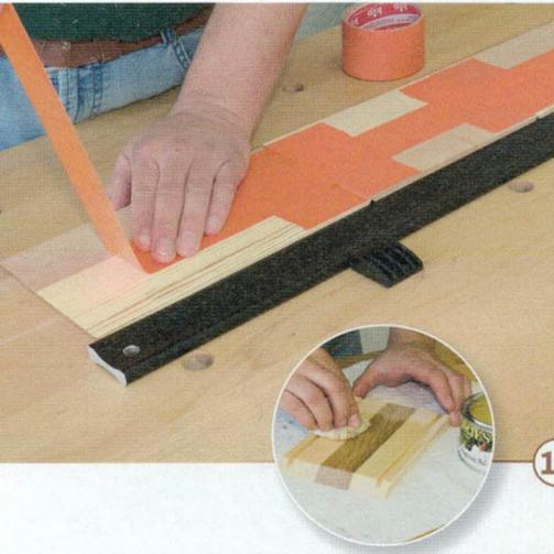
**10** > Wachsen Sie bereits jetzt innen. Richten Sie dann alle Korpusteile, Innenflächen oben, an einer Leiste aus. Verleimt wird dann mittels Klebeband. Ein PE-Band, wie es im Trockenbau verwendet wird, ist elastisch und kann spurlos wieder abgelöst werden.
