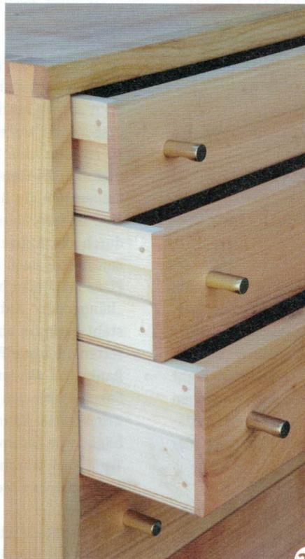
28 > Montieren Sie nun noch die Knöpfe in die Schubkastenvorderstücke und setzen Sie die Schubkästen ein.
