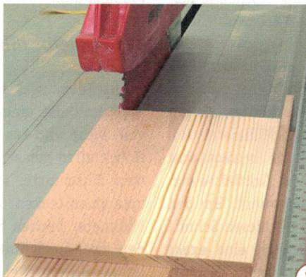
**7** Wieder wird eine Leiste in die Nut gesteckt. Das Korpusteil, von dem die Griffleiste abgetrennt wurde, wird dicht an der Leiste liegend aufgeklebt. Der Parallelanschlag kann jetzt so eingestellt werden, dass das obenliegende Brettchen noch wenige Zehntelmillimeter nachgeschritten wird.
