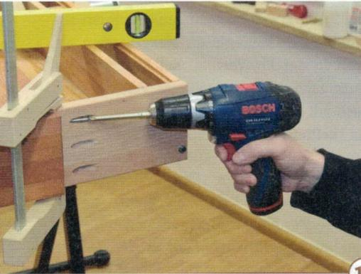
**11** > Taschenlöcher verbinden alles mit der Bankplatte. Zum Vorbohren alles in Position zu stecken, die Bohrpunkte in der Bankplatte mit einem langen Nagel „anzeichnen“, die Banklade (außer den Boden) wieder abziehen, und dann mit 4 mm schräg (!) im Verlauf der Taschenlochbohrung bohren. Erst dann wird geschraubt.
