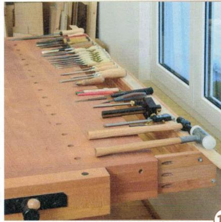
**12** > Alles Werkzeug, was zwischen den Rückwänden Platz finden soll, legen Sie lose auf die Bank. So ermitteln Sie, wie genau Sie die Einlegeleisten durchbohren oder mit gefrästen Schlitzern versehen, um alles perfekt aufzunehmen.
