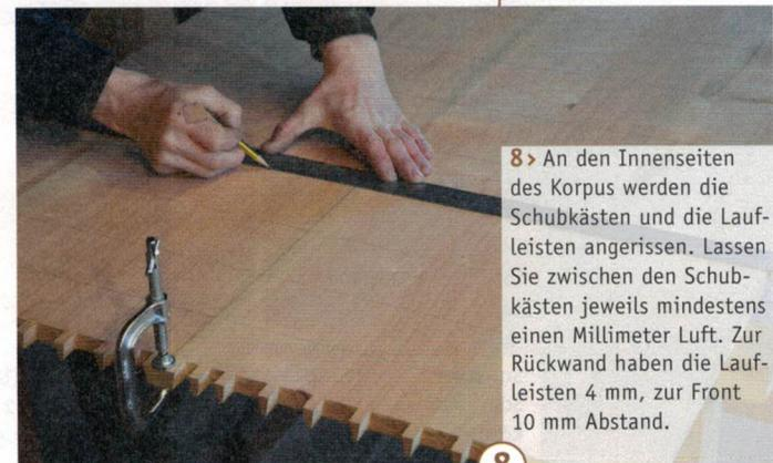
**8** An den Innenseiten des Korpus werden die Schubkästen und die Laufleisten angerissen. Lassen Sie zwischen den Schubkästen jeweils mindestens einen Millimeter Luft. Zur Rückwand haben die Laufleisten 4 mm, zur Front 10 mm Abstand.
