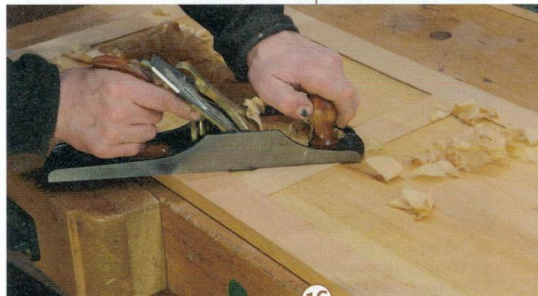
16 > Die minimalen Überstände können Sie nach dem Verleimen mit dem Putzhobel oder der Raubank bearbeiten. Das Modell im Bild ist ein „Jack plane“. Es ist leichter und handlicher als eine lange Raubank, bringt aber ein besseres Resultat als ein kurzer Putzhobel.
