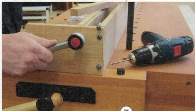
**7** > Setzen Sie außerdem die Bohrungen für die Schrauben an den Endstücken. Fertigen Sie dann noch Taschenlochbohrungen, um a) die Endstücke mit der Hobelbankplatte zu verbinden und b) den Boden mit der Bankplatte (zusätzlich zu den Flachdübeln). Schrauben Sie dann die Endstücke testhalber an die Rückwände.
