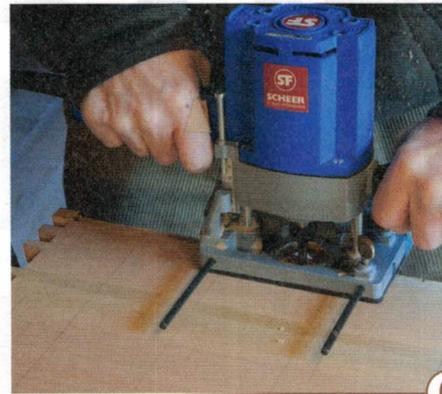
**6** Fälen Sie nun Seiten, Deckel und Boden für die Rückwand (21 x 6 mm). Die Ecke des Falzes wird erst nach dem Verleimen des Korpus von Hand nachgestochen.
