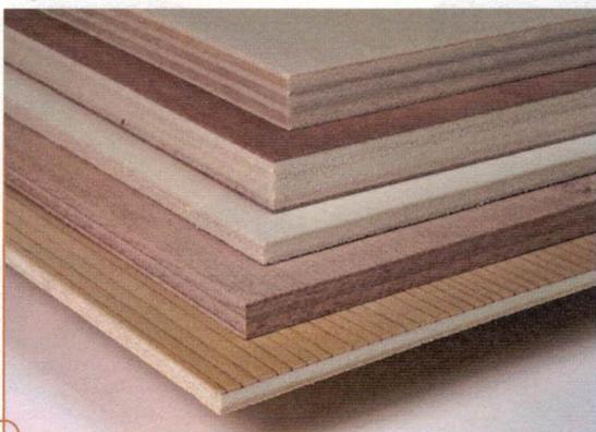
Furnierplatten von unten nach oben: a) dreischichtige Rückwandplatte (5 mm dick) mit gemessertem Fichte-Deckfurnier auf der Sichtseite, b) fünfschichtiges Sperrholz aus Buche (10 mm), c) dreischichtiges Pappelsperrholz (5 mm), d) siebenschichtiges Sperrholz mit Decks aus Gabun (12 mm), e) siebenschichtiges Pappelsperrholz (12 mm).
