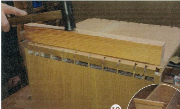
10 > Verleimen Sie nun den Korpus. Die Schwalbenschwanzverbindung wird vorsichtig zusammengetrieben, der Korpus auf Leisten auf den Werkstattboden gelegt und der Boden von hinten eingeschoben. Bei der Gratverbindung geben Sie nur im vorderen Drittel Leim an.
