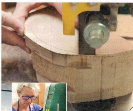
7 > Da beim Hinterteil die Unterkante als Schneidauflage dient, wird hier die Reihenfolge geändert und die Rundung vor dem Schrägschnitt gesägt.
