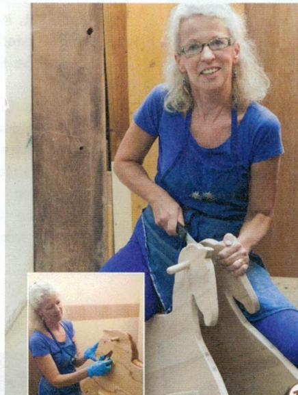
15 > Weil die unbeabsichtigt schräg eingebohrten Haltestangen sich in der Mitte nicht treffen, werden sie an der Innenseite bündig abgesägt.
