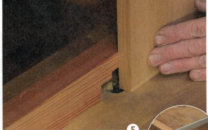
**5** Am Kopfholz des Bodens wird nun ein Grat angefräst. Dafür wird der Boden aufrecht am Anschlag entlanggeführt. Diese Verbindung muss sehr genau werden. Ein Probestück, zusammen mit den Korpussteilen ausgehobelt, hilft hier. Vorne wird die Gratverbindung um 10 mm abgesetzt (kleines Bild).
