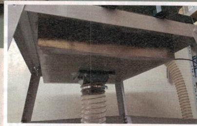
Gerade erst abgeschlossen hat Daniel Müller sein jüngstes Projekt: der Frästisch auf Böcken, den er bei Bedarf schnell abbauen kann. Ausgestattet hat er ihn mit dem **Fräsmotor** 1050 von Kress, Milescraft-**Federklemmen** und einem **Fräsersatz** der Firma Fisch-Tools.
