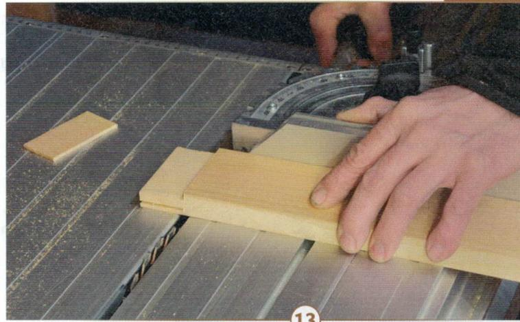
13 > Montieren Sie für die Absetzschnitte die Spanhaube wieder – hier haben wir sie für das Foto noch weggelassen. Die Zapfen haben ein Maß von 40 x 7 mm.
