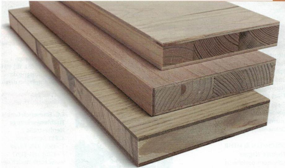
Stabsper Holz-Platten. Von unten nach oben: a) Eiche, messerdeckfurniert. b) Buche, messerdeckfurniert mit 2 mm dicker Starkfurnierkante. Bei beiden Platten laufen die Decks parallel zur Mittelschicht. c) dreischichtige Stabsper Holz-Platte mit Decks aus Schäl furnier. Die Decks laufen quer zur Mittelschicht.
