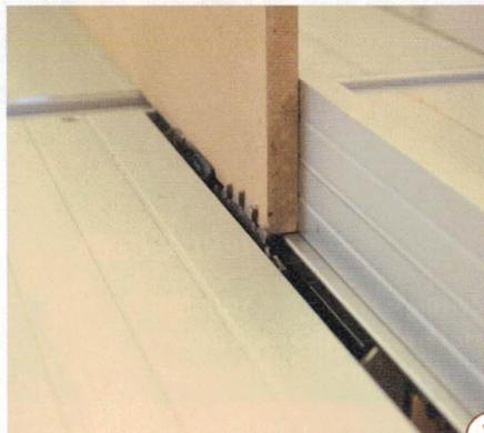
**3** > Genau diese Hilfsplatte nehmen Sie im nächsten Durchgang, um die Einstellung für die Nut in der vorderen Rückwand vorzunehmen. Die Dicke der Platte definiert den Abstand des Sägeblatts zum Anschlag. Stellen Sie die Schnitthöhe auf 6 mm ein.
