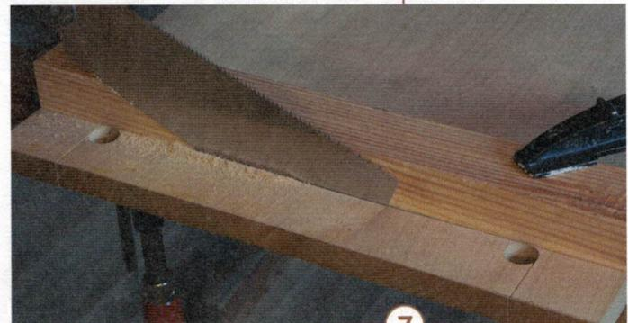
**7** Die Seiten des Korpus erhalten unten in der Sockelzone einen Ausschnitt. Dadurch wirkt das Möbel leichter und eleganter. Der Ausschnitt wird angerissen, die Ecken an der Ständerbohrmaschine gebohrt (Ø 20 mm) und der Bereich dazwischen von Hand ausgeschnitten und geputzt.
