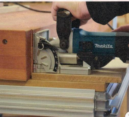
**2** > Versehen Sie die Hinterkante der Bankplatte (die hier auf einem anderen Tisch aufliegt) im Abstand von 15 Zentimetern mit Flachdübelfräsungen. Unter die Fräse gelegt ist hier eine 12-mm-Hilfsplatte, die den Abstand von unten definiert. Sie können eine beliebige Platte mit ähnlicher Dicke nehmen. Sie wird im nächsten Schritt noch eine Rolle spielen.
