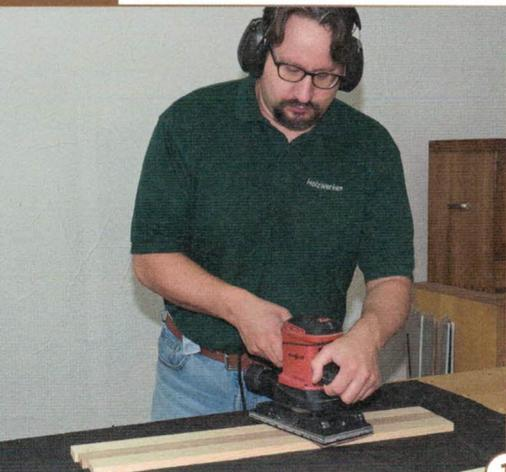
**1** Die Korpusteile werden 14 Millimeter stark, Deckel und Boden nur sechs Millimeter. Bereits zu diesem frühen Zeitpunkt wird geschliffen. Die späteren Außenseiten bekommen einen Vorschleif bis Korn 180, die Innenseiten werden auch fein, bis Korn 320 geschliffen.
