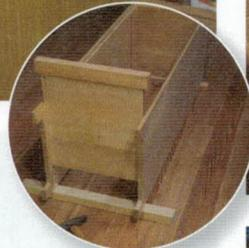
11 > Der Korpus erhält an der Front eine Sockelblende. Dafür werden drei Leisten auf Gehrung geschnitten und mit Hilfe eines Packbandes verleimt. An den Ecken bohren Sie sie mit Zulage aus und schneiden sie von 35 auf 31 mm zurück. Dann leimen Sie die U-förmige Blende an die Unterseite des Bodens.
