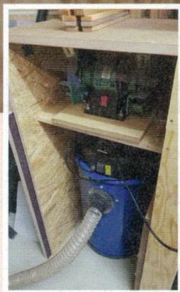
Unter dem selbstgebauten **Arbeits**tisch aus Sperrholz und einer Arbeitsplatte aus stehen als **Werkstattsauger** das CTL-Midi-Absaugmobil von Festool sowie die **zusätzliche Absaugung** von Scheppach (HA1000), die der Holzwerker schnell an Tischkreissäge oder Frästisch anschließen kann.
