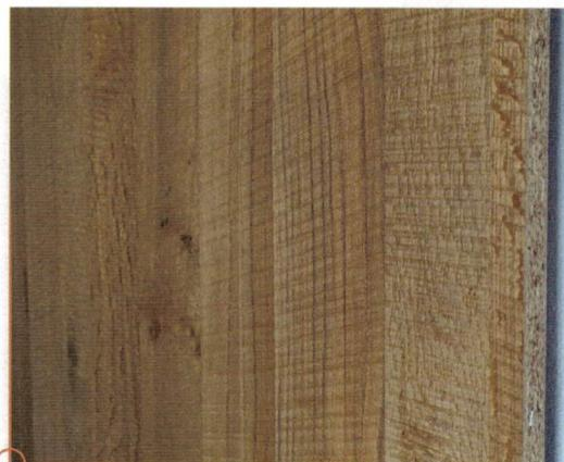
Bei dieser Platte sind gesägte, etwa 100 mm breite und gespiegelte Starkfurniere aus Eiche auf eine Spanplatte geklebt. Das ergibt einen rustikalen Brettcharakter. Die Kanten brauchen Anleimer.
