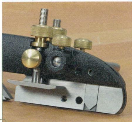
Grund- und Hilfskörper tragen je einen Vorschneider und dahinter einen Tiefenstopp, um sauberes und maßgenaues Hobeln zum Beispiel von Nuten zu ermöglichen.
