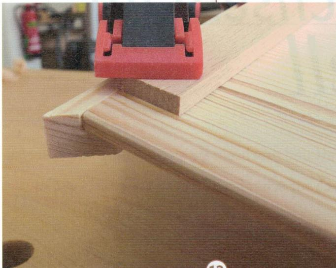
**12** > Die Griffleiste wird mittels Federzwingen und einer Leiste als Zulage an den Deckel geleimt. Der Deckel ist durch die umlaufende Luft etwas schmaler als die Griffleiste lang. Der dadurch entstehende Versatz wird rechts und links vermittelt.
