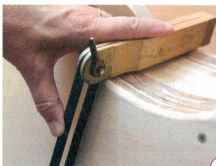
6 > Die Vertiefung des Sattels wird durch Unterlegen der vorher entstandenen Keile mit dem breiten Sägeblatt vorgesägt. Wenn Sie anschließend Seitenteile und Mittelklotz mit vier Schrauben verbinden, können Sie die entstandene Schräge mit Hilfe einer Schmiege abnehmen und auf den zweiten Klotz übertragen.
