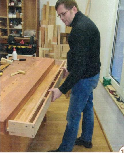
**10** > Die zusammengesetzte Einheit aus Endstücken und Rückwänden lässt sich nun einfach auf die Winkeleisen legen und mit der Nut über den Boden schieben. Dieser hat darin Luft und kann auf dieser Seite frei quellen und schwinden.
