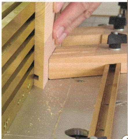
**4** Die Nuten für den Boden und den Deckel werden zwar mit der gleichen Einstellung am Frästisch erstellt, aber nicht beide zusammen. Fräsen Sie zunächst nur die Nut für den Deckel.
