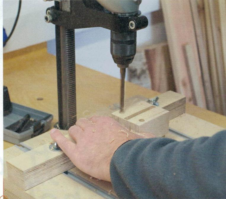
8> Bei unserer Bandsäge genügt zur Befestigung zwei Löcher, mit denen der Adapter auf die Köpfe der beiden Zylinderkopfschrauben aufgesteckt wird. Prüfen Sie, welche Möglichkeiten zur Befestigung Ihr Modell bietet.
