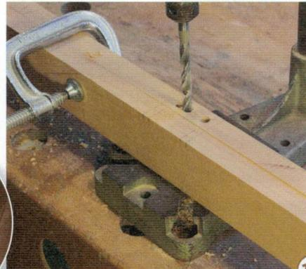
14 > An der Ständerbohrmaschine bohren Sie die Schlitzlöcher vor und stemmen sie dann nach. Anschließend nutzen Sie alle Rahmenteile an der Innenseite.
