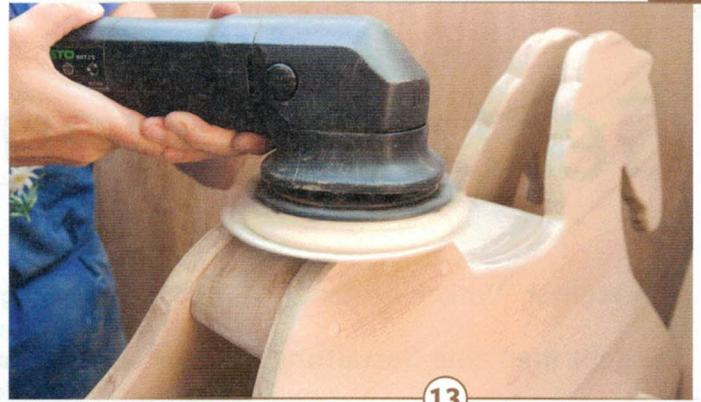
13 > Durch die Schrägstellung der Seiten stehen sie über den Korpus hinaus. Mit Hilfe eines groben Schleifpapiers lässt sich das am schnellsten anpassen.
