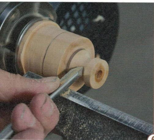
6> Direkt darunter liegt noch eine 30 mm dicke Partie, die hier im nächsten Schritt angelegt wird. Diesen „Stab“, genannt Profilform, haben wir hier mit dem Bleistift eingefärbt, damit er besser sichtbar ist. Rechts davon beginnt jetzt die freie Ausgestaltung des Griffs.
