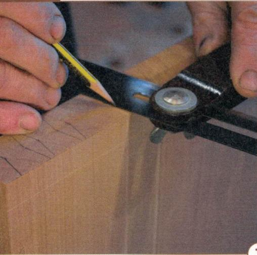
**1** Die Arbeit beginnt am Korpus: Für eine regelmäßige Zinkeneinteilung können Sie diese Formel verwenden: Anzahl der Schwalben = Holzbreite / 3 x halbe Holzdicke. Anzahl der Zinken = Schwalbenzahl + 1. Um die Verbindung zu beleben, sind hier aber die beiden Schwalben am Rande deutlich schmaler als die in der Mitte.
