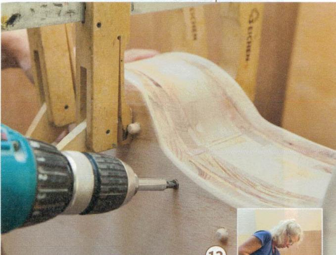
12 > Während des Dübelns ist es sinnvoll, die Konstruktion mit vier Sicherungsschrauben zusammen zu halten, weil rutschfreies Spannen der schrägen Teile fast unmöglich ist. Sind alle Dübel gebohrt und verleimt, werden auch diese Schrauben durch Holzdübel ersetzt.
