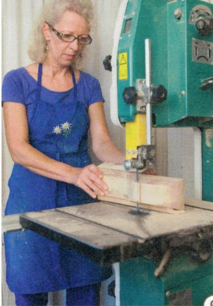
9 > Für den Feinschnitt lohnt sich der Aufwand, das breite Blatt durch ein Schweifsägeblatt zu ersetzen. Ein untergeschraubtes Stück Fußleiste ermöglicht den rechtwinkligen Schnitt.
