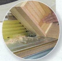
**14** > Die Nuten werden mit passend gehobelten Federn ausgeleimt. Sie müssen sich ohne Leim leicht, aber mit etwas Widerstand einschieben lassen. Die Überstände werden mit einer Japansäge ohne Rücken abgeschnitten. Ein untergelegtes Blatt Papier schützt die Oberfläche vor den scharfen Sägezähnen.
