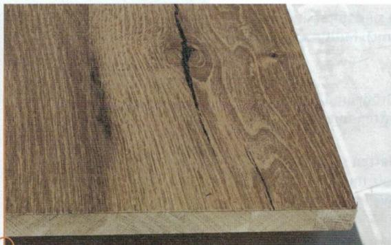
Diese furnierte Leimholzplatte wirkt eher wie Massivholz aus breiten Eichenholzbrettern. Die massive Mittellage läuft in gleicher Richtung wie die Messerdeckfurniere aus Altholz. So kann man sie von Stabsper Holz unterscheiden (vgl. S. 49).
