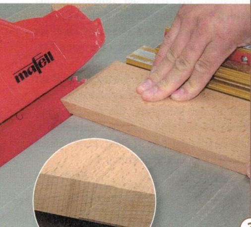
**3** Gut passende Gehrungen erfordern zwei Schnitte. Beim ersten Schnitt wird die Gehrung nur vorgeschritten, ein Millimeter bleibt noch stehen. Erst der zweite Schnitt bringt die Bauteile auf das richtige Maß.
