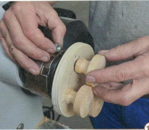
**13** > Bohren Sie (auf der Ständerbohrmaschine) an den Kreuzungen je ein 25-mm-Loch, drei Millimeter tief. Mittig dort hinein kommen 9-mm-Durchgangslöcher. Sie bieten etwas Spiel beim Durchstecken und Festziehen der vier Gewindestangen. Greifen Sie zu Sicherungsmuttern oder zu Federringen, um ein Verdrehen der Griffe zu verhindern.
