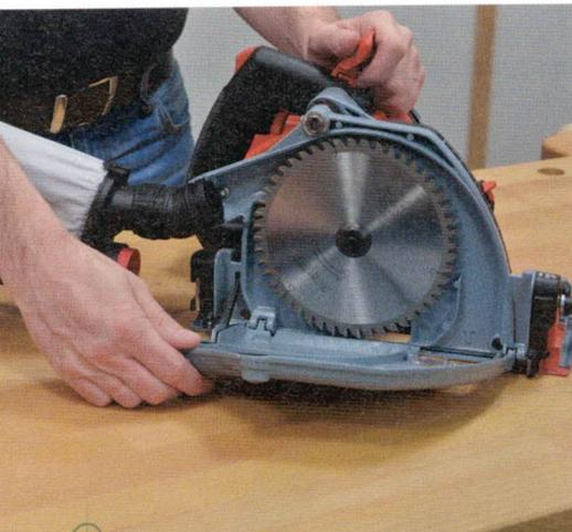
Mit einer Handbewegung lässt sich auch bei der Akku-Variante das Sägeblattfach öffnen. Mit einem Inbus-Dreh ist das Blatt dann herunter. Einfacher geht es nicht.
