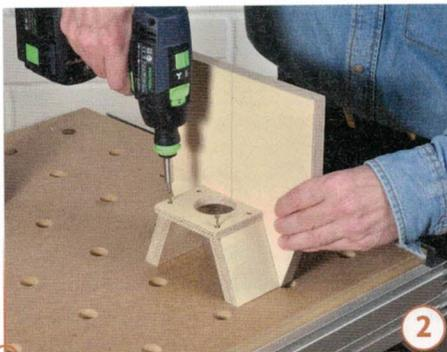
2 Bohren Sie ein Loch passend zur Größe ihres Absaugschlauchs und schrauben Sie danach das Absaugbrettchen von hinten an die beiden Seitenteile.
