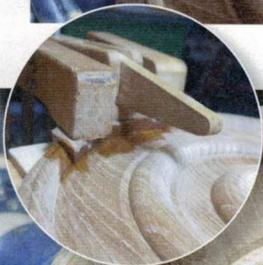
7> ...das angepasste Flickstück eingepasst und eingeklebt. Klar ist, dass sich der Drechsler dem scharf hervorstehenden Flickstück nun mit Vorsicht nähern muss. Ist alles wieder kreisrund, das Profil angelegt und ...
