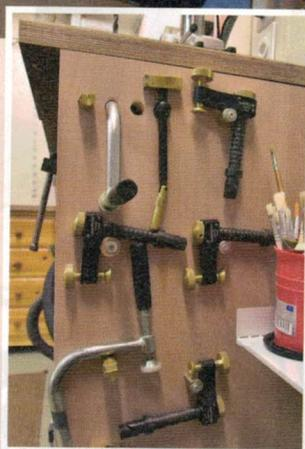
Um die **Spannmittel** für seine **Multiwerkbank** stets griffbereit zu haben, hat Rudolf Kläusli sie an der Schrankseite seines Bohrständers-Schranks übersichtlich positioniert. Vorwiegend hängen hier **Spannelemente** von Veritas. So muss er nicht erst umständlich in einer Schublade kramen und sie sind auf der Werkbank nicht im Weg, wenn er sie gerade nicht braucht.
