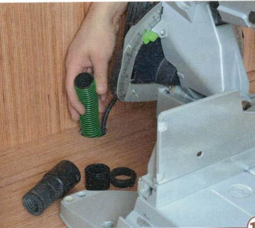
16 > Saugschläuche für Elektrowerkzeuge haben in der Regel einen zerlegbaren Anschluss, ohne diesen wird die Montage deutlich leichter.
