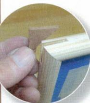
**15** > Zur Stabilisierung der Ecken muss ein diagonaler Sägeschnitt an jeder Ecke angelegt werden – wie hier auf der Kreissäge oder mit der Japansäge. Nach Ermittlung der gewünschten Schnitttiefe an Probestücken (Achtung vor Kontakt mit den Glasplatten!), werden die Schlitzte eingesägt und kleine Verstärkungsfedern eingeleimt.
