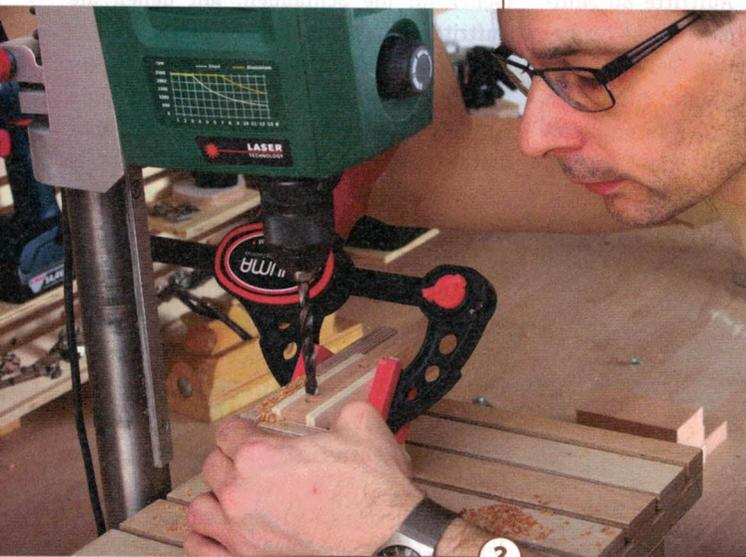
**3** > Fertigen Sie die erste Bohrlehre mit drei Bohrungen von je  $\varnothing 8$  mm an. Beachten Sie dabei die Maße aus der Zeichnung „Dübelbohrungen an den Zinnen“. Mit dieser Schablone ist ein immer gleicher Abstand zwischen den Zinnen gewährleistet. Die drei Teile dieser Zinnen-Bohrlehre werden nur miteinander verschraubt, da sie später noch verändert wird.
