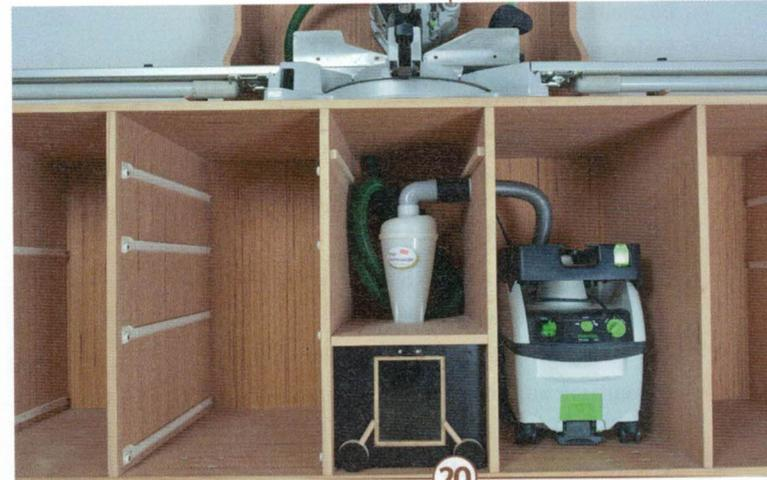
20 > Das gesamte Absaugsystem: Der Sauger wird von oben an den Zyklon angeschlossen. Seitlich aus dem Zyklon (hier verdeckt) geht der Absaugschlauch zur Säge. Unter dem „Dust Commander“ befindet sich die Staubbox mit Sichtfenster. Die abgebremsten Späne fallen hier hinein und nicht in den Filtersack.
