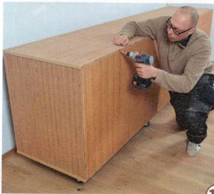
10 > Nach der Oberflächenbehandlung mit Öl werden alle Teile montiert und die Rückwände eingeschraubt.
