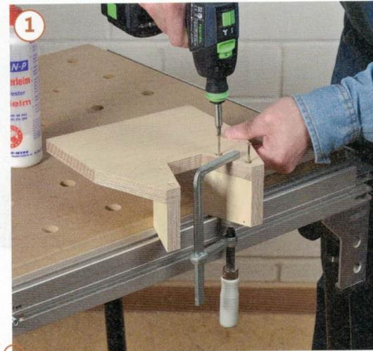
1 Zuerst sägen Sie die Form der Grundplatte zurecht. Anschließend befestigen Sie die beiden Seitenteile des Absaugkanals mit Schrauben und Leim.
