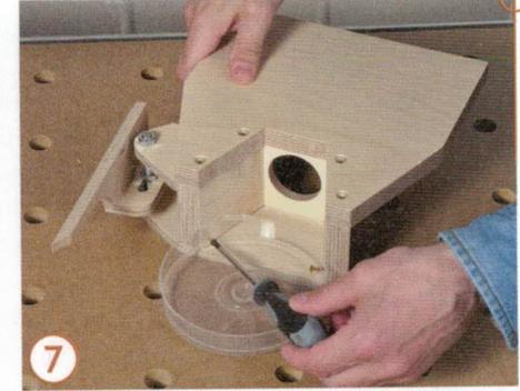
7 Der Klarsichtdeckel der CD-Spindel wird einfach mit zwei Schrauben am Absaugkanal befestigt. Bei einem höheren Spindeldeckel müssen Sie die Rückseite etwas ausschneiden, damit die Absaugung noch gut funktioniert.
