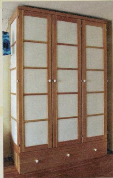
Werner Schillinger aus Teningen hat für seine Tochter in 90 Stunden einen hohen Kleiderschrank aus Lärchenholz gebaut. Die Japanoptik erreichte er durch Füllungen aus Sperrholz, die er mit Schaumstoff belegt und anschließend mit Stoff bespannt hat. Schillingers Tochter kann die linke Tür um 180° öffnen, um sich im Spiegel zu betrachten. Die Schubkästen sind gezinkt und der untere Teil des Schranks ist fest verleimt. Der obere Teil des Schranks mit den Türen ist mit Korpusverbindern verbunden.
