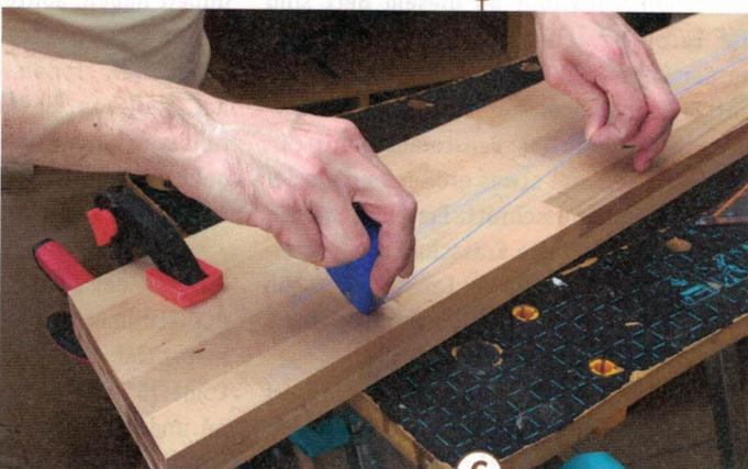
**6** > Nun ist die Leiter dran: Mit einer Schlagschnur zeichnen Sie zwei parallel zur Außenkante verlaufende Linien an. Die Schlagschnur wird über das oberste und das unterste zuvor gebohrte Bohrloch gehalten und auf die Wange geschnipst. Die Auftrittshöhe beträgt 200 mm.
