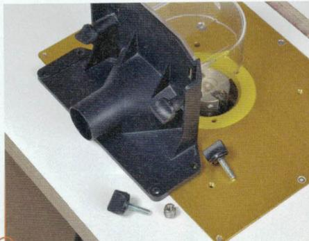
Die wohl eleganteste Befestigungsmethode sind 6-mm-Gewindebohrungen, in denen man die Bogenfräshaube direkt mit den mitgelieferten Schrauben befestigt. Dazu kann man zum Beispiel entsprechende Gewinde in die Alufestigungsplatte schneiden. Liegen die Bohrungen im Plattenbereich, drehen Sie passende Gewindemuffen ein.
