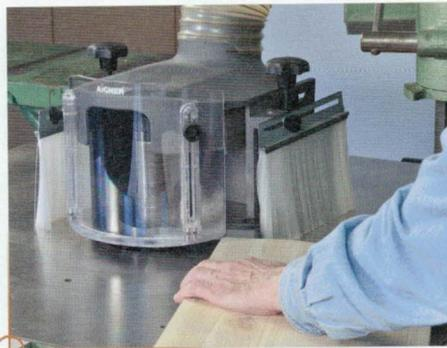
Auf einer großen Tischfräse können erhebliche Rückschlagkräfte auftreten, wenn man nicht penibel genau darauf achtet, das Werkstück in einer ständigen Vorwärtsbewegung an die Fräterschneiden heranzuführen (Gegenlaufräsen). Wird das nicht beachtet, können Werkstücke mit über 150 km/h durch die Werkstatt geschleudert werden.
