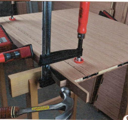
8 > Die sichtbaren Seiten erhalten Anleimer. Diese werden mit Keilen gegen aufgespannte Schraubzwingen gedrückt – einfach und sehr effektiv.
