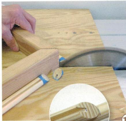
**13** > Auf einem eigens dafür gefertigten Gehrungsschlitten klappen solche Zuschnitte besonders gut (die Schutzhaube ist aus Darstellungsgründen entfernt). Die Enden sind mit blauem Klebeband umwickelt, um Ausrisse zu verhindern. Die Endlänge eines Teils kann auf das zweite Rahmentstück übertragen werden.
