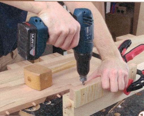
**15** > Mit der gleichen Bohrlehre, mit der Sie zuvor die Dübellöcher in die Seiten und Unterseiten der Seitenbretter für die Zinnen gebohrt haben, bohren Sie nun in die vier aufnehmenden Rahmenteile. Achten Sie auch hier darauf, dass die Bohrlehre nun seitenverkehrt zur ersten Bohrung angelegt wird.
