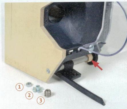
... benötigt auf der Plattenunterseite ein Gewinde. Dazu können Sie entweder eine einfache Sechskantmutter (1) in die Plattenfläche einlassen, oder wieder eine Gewindemuffe (3) eindrehen. Auch eine bündig eingelassene Einschlagmutter (2) würde funktionieren. Damit die ...
