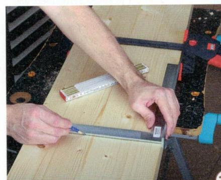
13 > Damit der Rahmen an allen Standfüßen auf gleicher Höhe liegt, zeichnen Sie einen Strich 1.300 mm oberhalb der Unterkante der Pfosten. Dazu legen Sie alle Standfüße nebeneinander bündig mit deren Unterkante auf die Werkbank und ziehen einen Strich.
