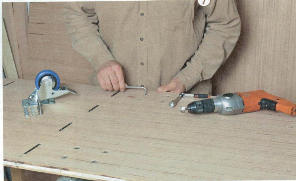
7 > An der Unterseite bringen Sie acht Lenkrollen an. Diese machen solch eine Station deutlich flexibler, sollten die Werkstücke doch einmal etwas länger ausfallen.
