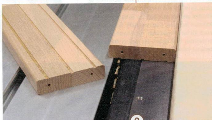
9 > Die kleinen Nuten, die das Abrutschen des Kinderfußes verhindern, stellen Sie am besten jetzt an der Kreissäge her. Dazu sägen Sie je eine 2 mm tiefe Nut mittig und zwei weitere etwa 15 mm von der Außenkante. Runden Sie anschließend die Kanten ab, dann ist die Leiter fertig.
