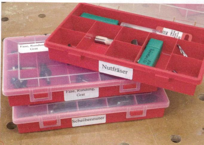
Besonders Oberfräsen haben allerhand Kleinteile, die sich übersichtlich in einem solchen Kasten unterbringen lassen. Fast jeder Fräser hat ein eigenes Fach und für jede Art von Fräsern gibt es einen Kasten.
