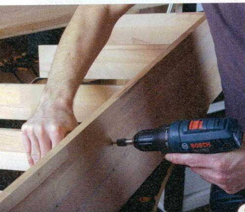
8 > Die Sprossen sind 18 mm dick, deshalb ziehen Sie 9 mm parallel zu dem Strich, der die Oberkante der Sprosse markiert, einen weiteren Strich an. In den so entstandenen neuen Kreuzungspunkt werden die Löcher gebohrt. Setzen Sie schließlich die Leiter probeweise zusammen.
