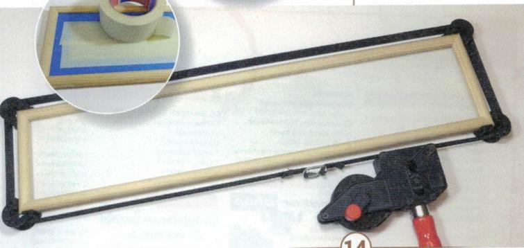
**14** > Die Verleimung der vier Streben rund um das Glas übernimmt ein Gurt-Rahmenspanner. Um das Glas bei den weiteren Arbeitsschritten zu schützen, wird es beidseitig mit Malerkrepp beklebt. Dabei lohnt sich sauberes Arbeiten, da die Abklebung auch für die abschließende Lackierung verwendet wird.
