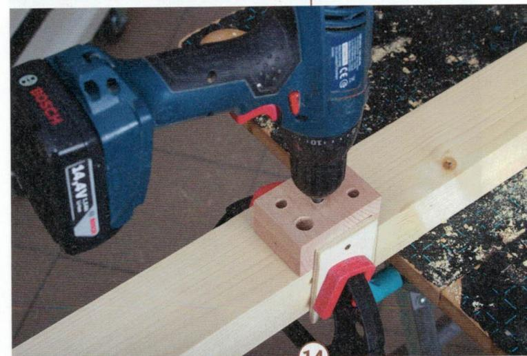
14 > Zum Bohren der Löcher in die Standfüße hilft wieder die Bohrlehre, die schon für das Bohren in die Hirnhölzler (Schritt 11) hilfreich war. Achten Sie nur darauf, dass die Bohrlehre nun seitenverkehrt auf dem Pfosten arretiert wird. Auch die Kopfbänder erhalten nun die Bohrungen, durch die die Kopfbänder später mit dem Rahmen verbunden werden (Schritt 20).
