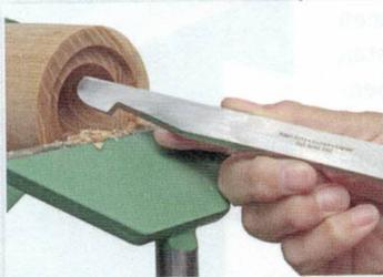
12 > Mit einem Ausdrehstahl werden die Stufen nun geglättet und die Unterseite des Deckels, einschließlich Oberflächenbehandlung, fertiggestellt.
