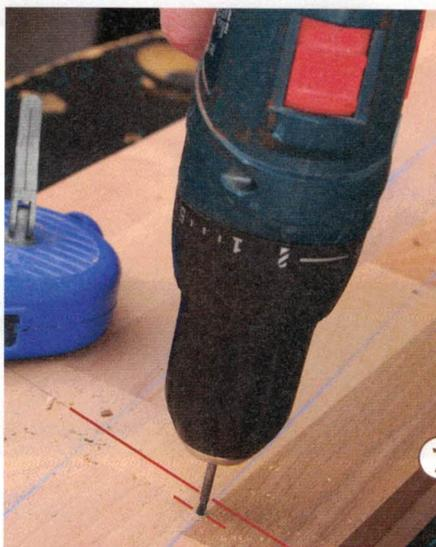
**7** > Zum Anzeichnen der Sprossen hilft ein Stück Restholz von 200 x 300 mm. Die Unterseite der Längsseite wird bündig auf die Unterseite der Leiterwange gelegt. Ziehen Sie einen Strich an dessen Oberkante.
