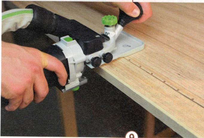
9 > Fräsen Sie im nächsten Schritt die Anleimer bündig. Durch den Anleimer werden die Kanten etwas unempfindlicher und entwickeln eine andere Optik.
