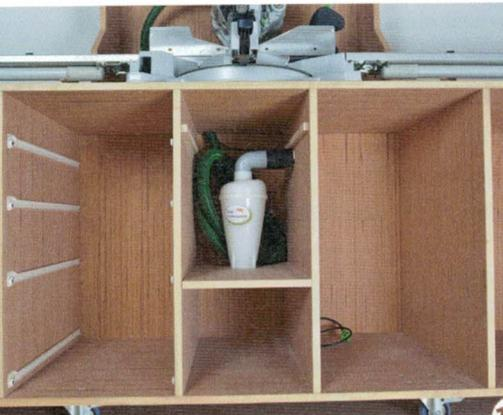
17 > Der Zyklonabscheider ist direkt unter der Säge positioniert. Durch geringe Leitungslängen können Saugkraftverluste gering gehalten werden. Bei dem verwendeten Modell war das nicht nötig und der Schlauch wurde nicht gekürzt.
