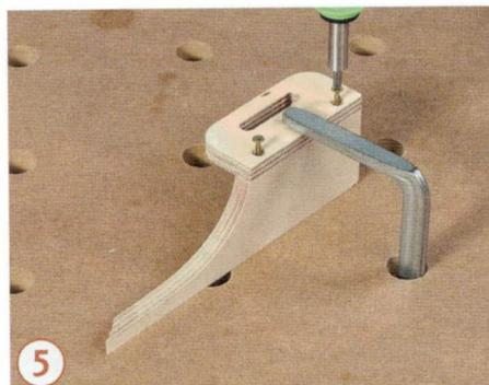
5 Die Zuführleiste besteht aus einem langen, spitz zulaufenden Multiplexteil und einem Winkelstück mit einem 40x8-mm-Langloch. Über das Langloch kann die Leiste später bis an das Kugellager herangeführt werden.
