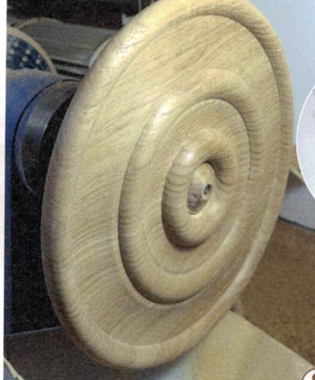
8> ...fein geschliffen, muss die Scheibe vom inneren Ring abgestochen werden. Empfehlenswert ist ein nicht vollständiges Abstechen bis auf etwa einen Millimeter Wandstärke; den Rest durchtrennt dann ein Schnitzmesser oder die Dekupiersäge. Die Kontrolle mit der Schablone zeigt: Zielform erreicht.
