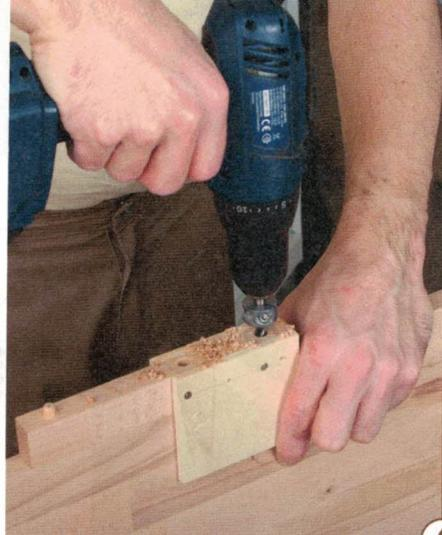
**4** > Bohren Sie mit dieser Schablone die Dübellöcher in die Oberseiten der Seitenbretter. Die Schablone ist so gearbeitet, dass im dritten Loch ein Dübel steckt, den Sie in das letzte zuvor gebohrte Loch stecken. So ist der immer gleiche Abstand zwischen den Zinnen garantiert.
