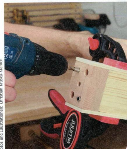
11 > Fertigen Sie für die Rahmenkonstruktion eine zweite Bohrlehre nach der Zeichnung „Rahmengestell mit Pfosten“. Diese hilft beim Bohren der Hirnhölzler. Die Löcher in den Pfosten, in denen die Gewindestangen in den Rahmen hineinragen, werden mit der gleichen Bohrlehre gebohrt, nun aber spiegelverkehrt!
