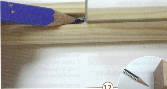
**12** > Passen Sie den Rahmen nun an das schon fertige Glas an (nicht umgekehrt): Zuerst mit einem feinen Blatt auf der Kreissäge eine Gehrung schneiden, dann das Glas in die Nut einlegen und das Ende der Scheibe in der Nut markieren. Mit einem 45°-Hilfsklötzchen wird der Verlauf der Gehrung auf die Außenseite übertragen.
