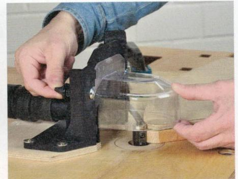
Wenn Sie keine Bohrungen in ihren Frästisch machen möchten, dann können Sie die Bogenfräshaube auch auf eine Multiplexplatte schrauben. Die stufenlos in der Höhe verstellbare Haube ist nicht nur ein optimaler Fingerschutz, sondern erhöht auch maßgeblich die Absaugleistung.
