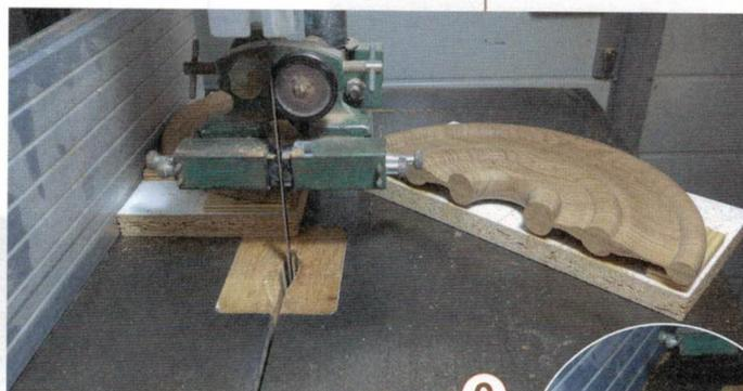
9> Für das Zerteilen wird der Rohling mit Distanzstückchen und doppelseitigem Klebeband auf eine quadratische Platte aufgeklebt. Achten Sie darauf, dass die Maserung parallel zu einer der Schnittkanten liegt – das ist später wichtig für die stabile Aufhängung. Mit zwei mittigen Schnitten entstehen vier Konsolen.
