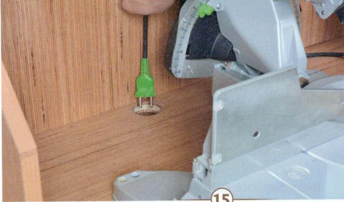
15 > Eine ausreichend große Bohrung im hinteren Bereich schafft die Verbindung für den Saugschlauch und das Stromkabel.
