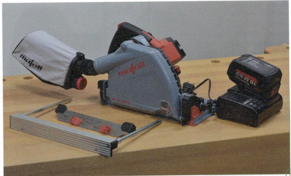
Im Lieferumfang der größeren Liefer-Variante der MT 55 18M bl befinden sich ein Ladegerät, zwei Akkus, ein Parallelanschlag (ganz vorne), der Positionsanzeiger für Eintauchschnitte (dahinter) sowie ein Spänefangsack und ein Systainer (nicht im Bild).
