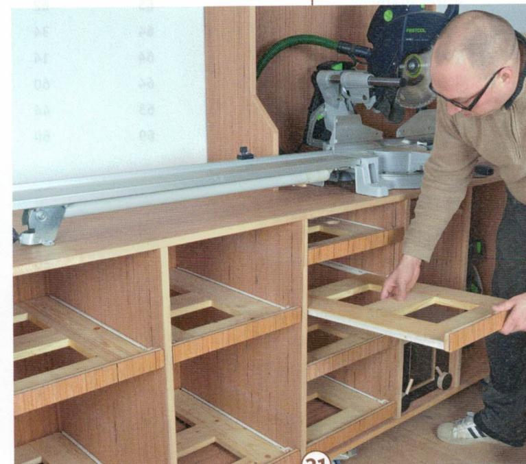
21 > Der restliche Raum wird hauptsächlich für die Lagerung von Werkzeug und Zubehör genutzt. Die Tablare sind mit Flachdübeln verleimt und halten den Belastungen spielend stand. Denkbar sind natürlich auch Schranktüren.
