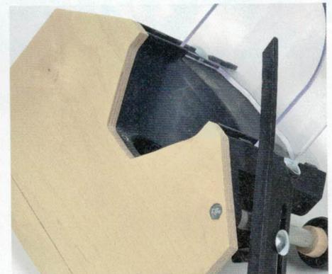
... Schraube im Stab nicht auf der Plattenunterseite vorsteht, legen Sie noch einen 12 mm hohen Rundstab (Ø 20 mm) zwischen Stab und Drehknopf (s. Pfeil Bild mitte). Die Multiplexplatte sägen Sie im Bereich des Absaugkanals noch entsprechend mit einer Stichsäge aus.
