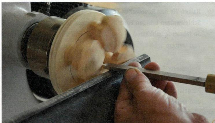
Sterngriff-Schrauben müssen nicht aus kaltem Plastik sein. Drechseln Sie sie – und lernen Sie eine faszinierende Technik gleich mit.
