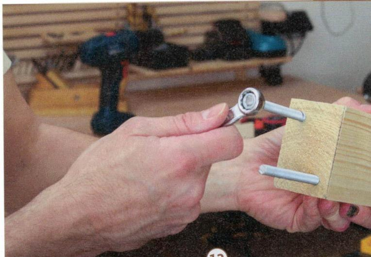
12 > Vor dem Einschrauben der Gewindestangen geben Sie etwas PUR-Kleber in die Bohrlöcher. Nun drehen Sie die Gewindestange in das Hirnholz. An dessen Enden sind zwei M8-Muttern gekontert aufgeschraubt.
