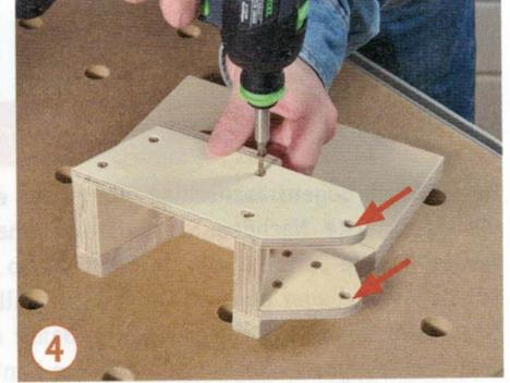
4 Den oberen Deckel aussägen und ebenfalls ein 8-mm-Loch bohren. Achten Sie darauf, dass die beiden Löcher (Pfeile) später genau senkrecht übereinander stehen.
