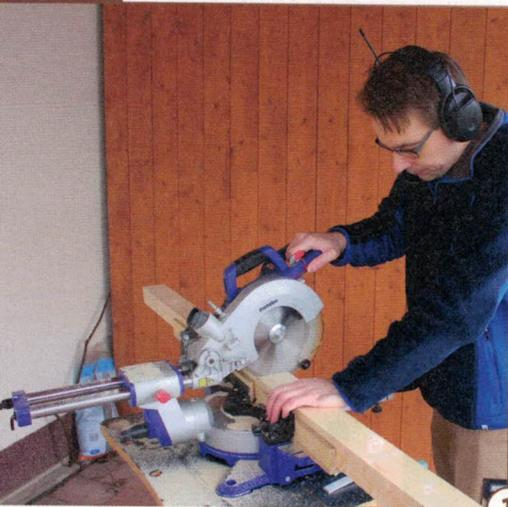
**1** > Der Zuschnitt von Kantschnitzholz gelingt am besten mit einer Kapp- und Gehungssäge, gerne im Freien, weil eine solche Säge ihren Staub weit werfen kann. Die Pfosten sind aus Fichte; nehmen Sie Hobelware oder fragen Sie den ortsansässigen Tischler nach maschinellem Aushobeln.
