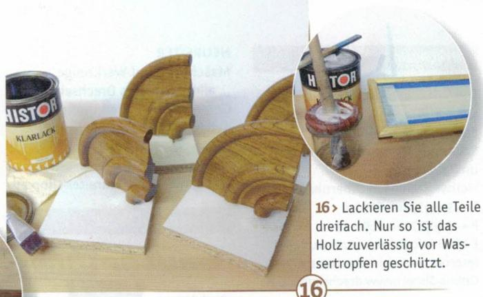
**16** > Lackieren Sie alle Teile dreifach. Nur so ist das Holz zuverlässig vor Wassertropfen geschützt.
