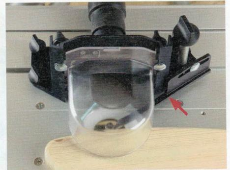
Auch die Festool-Bogenfräshaube verfügt über eine verstellbare Zuführleiste (Pfeil). Sie deckt den gesamten hinteren Bereich des Fräswerkzeugs ab und verfügt dort auch über einen Anschluss für die Absaugung. Im vorderen Bereich befindet sich eine höhenverstellbare, gebogene Acrylglashaube. Dieser transparente Sichtschutz kann genau auf Werkstückdicke eingestellt werden.
