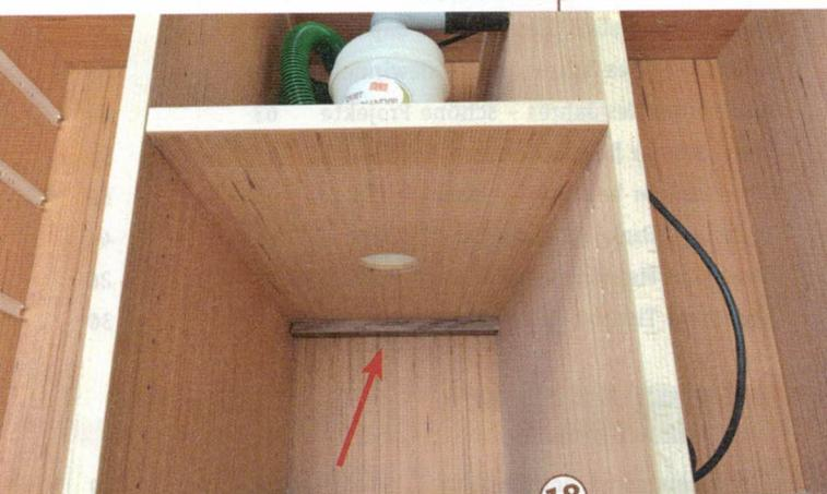
18 > Zur Aufnahme des Zyklonabscheiders wird ein Loch in das Brett gefräst, hierbei empfehlen wir, an einem Teststück einen Fräsversuch durchzuführen. An der Oberseite ganz hinten wird eine Keilleiste angebracht. Sie und ihr Gegenstück an der Box drücken diese im hinteren Bereich nach oben (siehe auch Bild 19).
