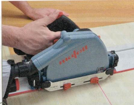
Sehr praktisch ist der aufgeklippte Positionsanzeiger. Die roten Kunststoff-Schieber zeigen an, wo das Sägeblatt bei gegebener Schnitttiefe noch außerhalb des Gehäuses dreht. Punktgenaues Aussetzen (wie hier an der roten Linie) klappt millimetergenau.
