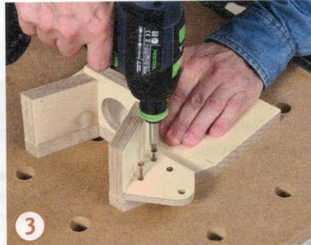
3 Sägen Sie das untere Lagerbrett zurecht und bohren Sie ein 8-mm-Loch für den 8er Gewindestab. Das Ganze dann einfach auf die Grundplatte schrauben.
